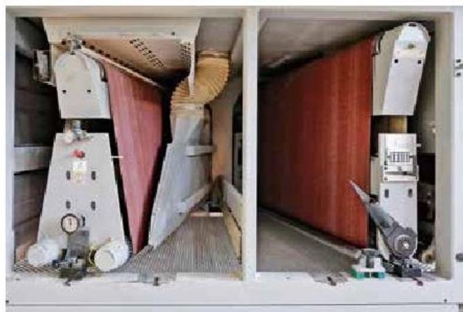
Die Kündig Brilliant-2 Vmax 1600-RdEd (links) habe bei geringerem Arbeitsaufwand eindeutig bessere Oberflächen ermöglicht, sagt man bei Ipfelkofer. Foto rechts: Die beiden Schleifaggregate sind in V-Form schräg gestellt.
