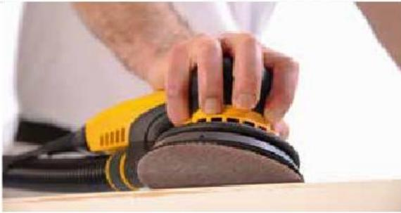
Der Mirka Deros ist mit einem bürstenlosen Elektromotor ausgestattet und kommt ohne externes Netzteil aus.
