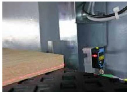
Automatische Messung der Werkstückdicke und selbstständige Einstellung der Maschine auf die benötigte Dicke
