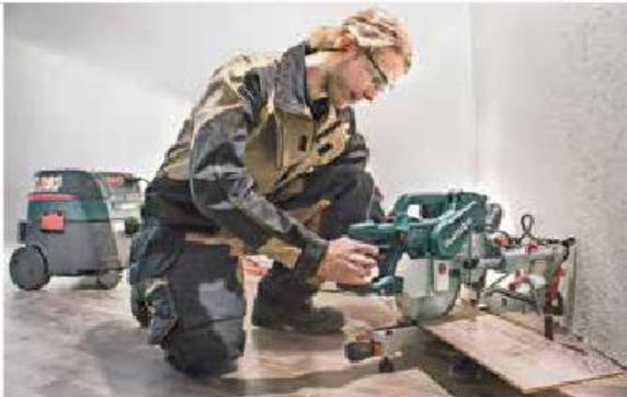
Die Säge liefert präzise Schnittergebnisse in Bodenpaneelen bis 305 mm, Leisten und Aluprofilen.
