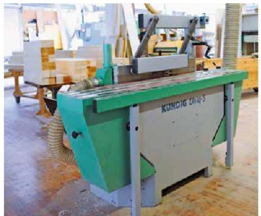
Die Kündig Uniq-S Kantenschleifmaschine ergänzt den Maschinenpark bereits länger.
