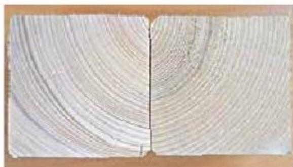
Zwei Schnittflächen im Vergleich. Die linke entstand nach einem Sägeschnitt mit dem nn-Sägeblatt, die rechte mit einem herkömmlichen Sägeblatt für Massivholz quer.
