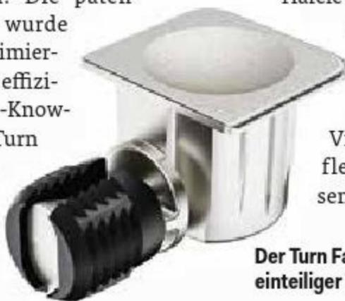
mit Holzdicken ab 18 mm. Er wird mit einer einfachen Drehung von Hand verspannt. Durch die 90°-Drehung spreizt sich die Kunststoffmuffe im Bohrloch und sorgt für eine sichere und dauerhafte Verbindung.
