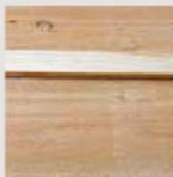
Das Schnittbild der Lärche zeigt, wie sauber das Sägeblatt beim Sägen längs zur Faser arbeitet.
