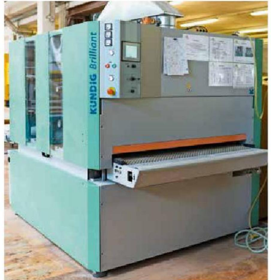
Die Brilliant-3 1350-REEd-L ist mit einem Walzen- und zwei Elektronikschuhaggregaten ausgerüstet, davon eines mit Diagonalschleiftechnik.
