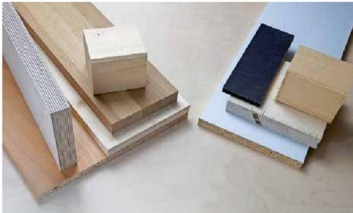
Die Werkstücke auf der linken Seite wurden mit dem nn-Sägeblatt von Leuco und die auf der rechten mit „herkömmlichen“ Sägeblättern zugeschnitten.
