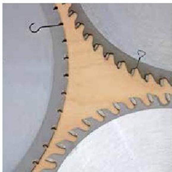
**Zahnvergleich: Links das NN-System, rechts unten das Sägeblatt für Massivholz quer zur Faser und rechts oben das für Plattenwerkstoffe**
