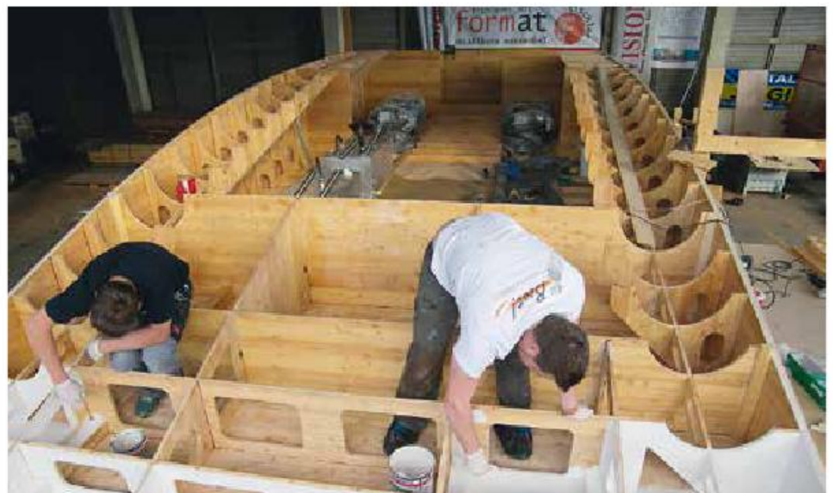
Auf dem Firmengelände der Klagenfurter Tischlerei mit Format wurde innerhalb von zwei Jahren das Luftkissenboot aus Holz gebaut.
