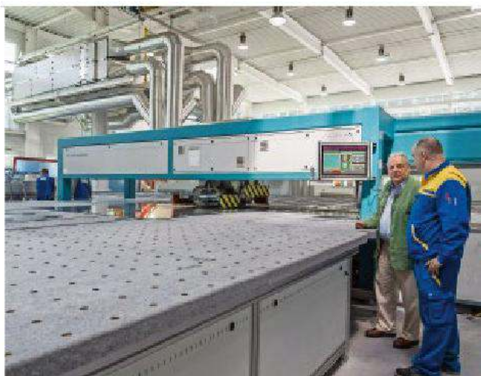
Auf Basis einer Standardmaschine erfüllt die Email-Anlage alle Wünsche. Die Veredelung – Digital- und Siebdruck, vollflächig und präzise Randemaillierung – erfolgt vollautomatisch.
