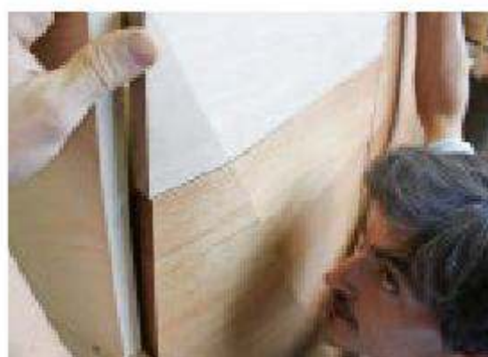
Exaktes Einpassen der Gehrungs-Schnitte für die Fronten.
