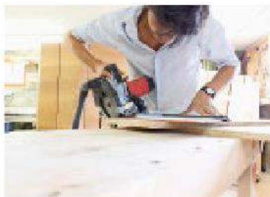
Entlang der Kappschiene wird ein exakter Gehrungsschnitt ausgeführt.
