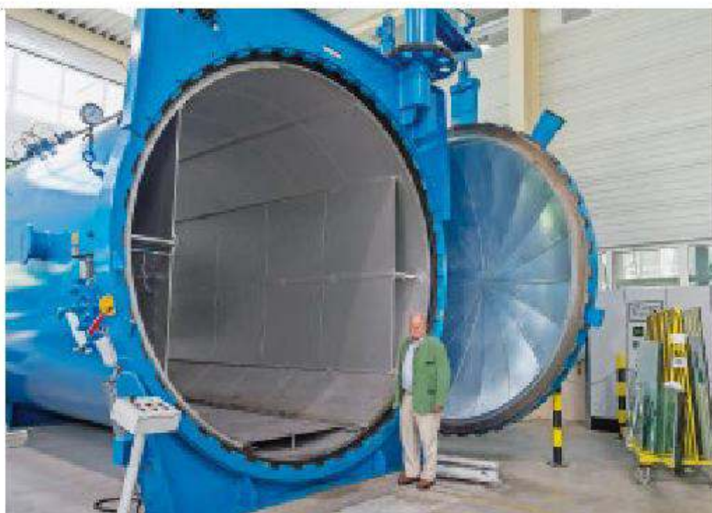
Herstellung von Verbundsicherheitsglas (VSG): Zwei oder mehrere Glasscheiben, dazwischen eine PVB-Folie, werden unter Hitze und Druck im Autoklaven zu einem dauerhaften Verbund.
