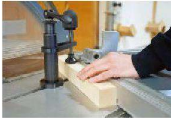
Mit dem Ruwi Spann- und Sägesystem bleiben die Hände außerhalb des Gefahrenbereichs.
