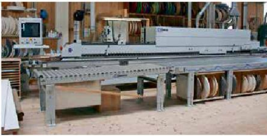
Die Kantenanleimmaschine, eine Homag KAL 210, ist mit zwei Leimauftrags-Einheiten und einer Ligmatech-Rückführung ausgerüstet.
