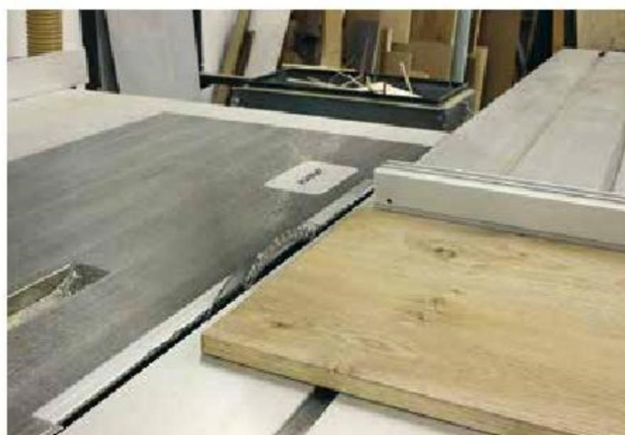
Die Formatkreissäge kappa 550 x-motion bietet eine extreme Schnitthöhe über 200 mm und einen 3-Achsvoritzer, der sich auch versenken lässt.
