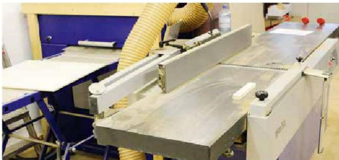
Dickenhoebl exact 63 neben der Abrichthobelmaschine Plan 51L.
