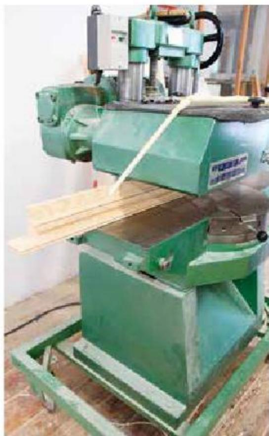
Oberflächenbearbeitung mit der Finiermaschine
