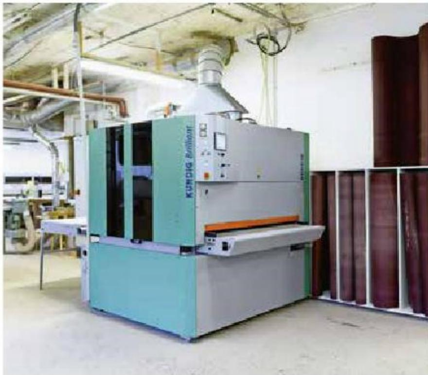
Die Kündig Brilliant-2 1350 REd-L ist mit einem Walzen- und einem Diagonalaggregat mit elektronischem Schleifschuh ausgestattet.
