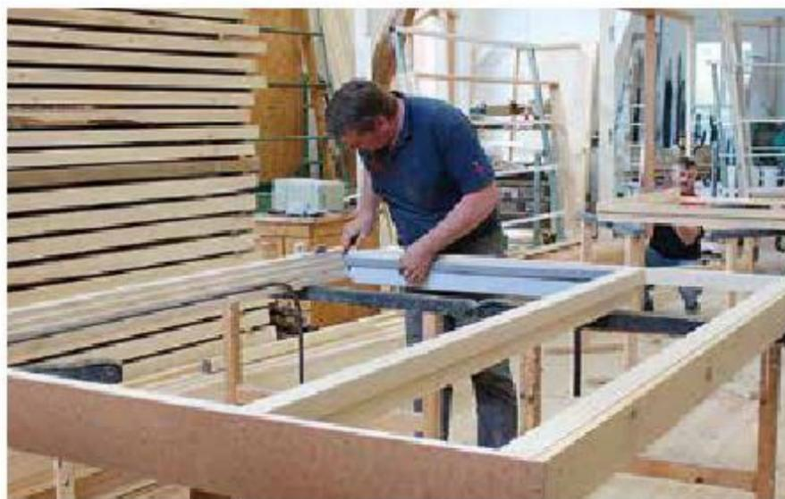
Lorber fertigt auch passivhaustaugliche Türen. Für die Oberflächenbehandlung wird fast ausschließlich geölt und nur selten lackiert. In der Werkstatt entstehen auch viele Großformate und Fixverglasungen.
