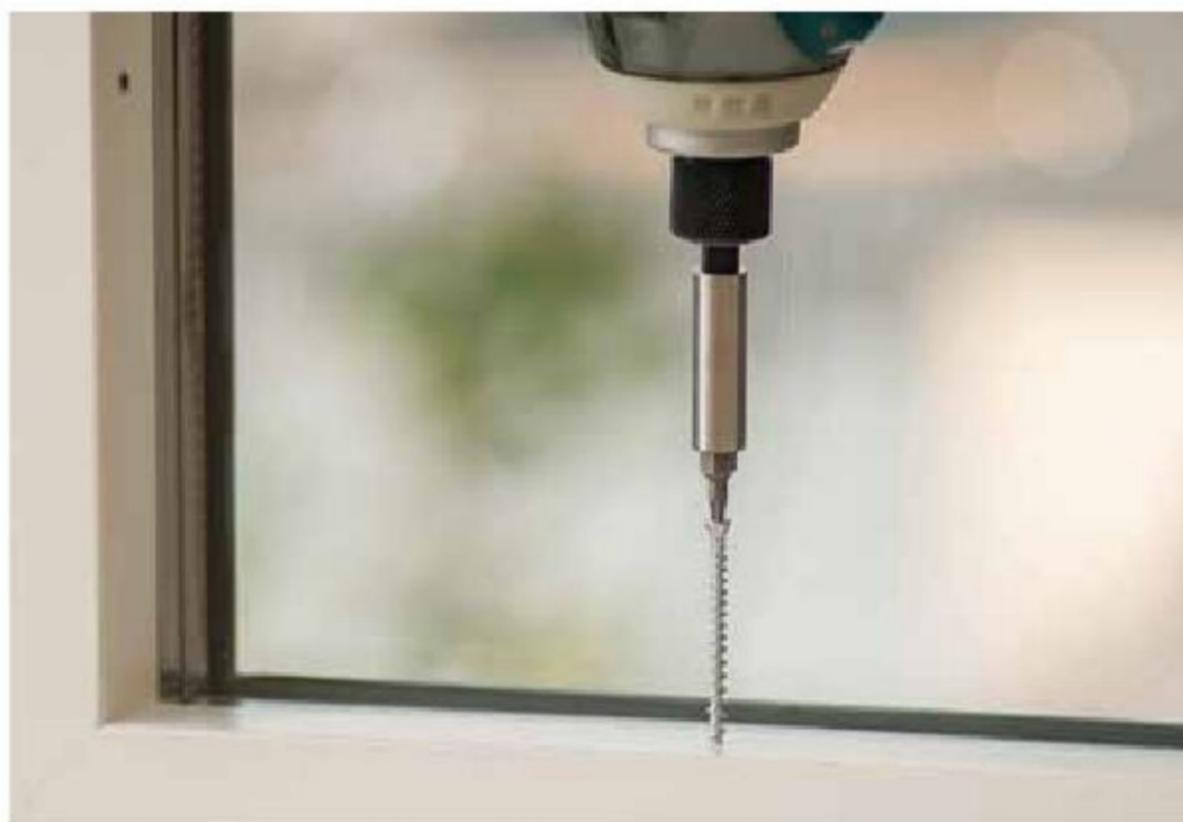
Die spezielle Spitze der Heco-Unix-top verkürzt die Anschraubzeit und reduziert die Spaltwirkung.
