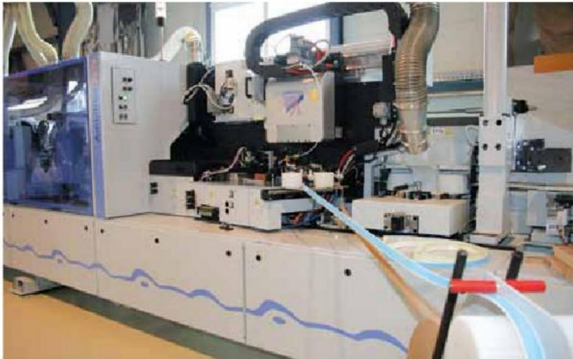
Live-Kantenbearbeitung mit LaserTec auf einer Brandt-Ambition 2274
