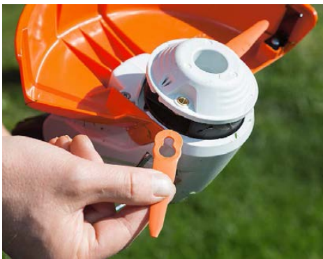
- KNIFFLIG: Beim Testsieger von Stihl werden die Messer von hinten befestigt.
