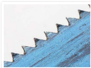
Ungehärtete, gefeilte und geschränkte Zahnung an einer Gestellsäge.
