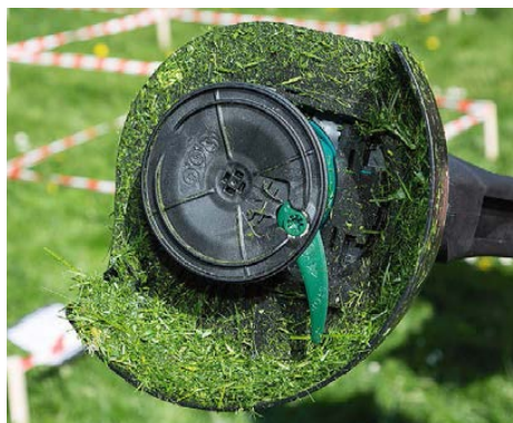
- ZUGESETZT: Die Anhaftungen bei Gardol stören bei der Lagerung.
