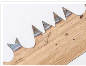
Grobe, geschränkte Zahnung mit doppeltem Räumzahn an einer Bügelsäge.
