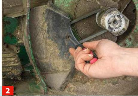
**2** Abdeckungen – hier für den Antriebsriemen – soweit möglich demontieren.
