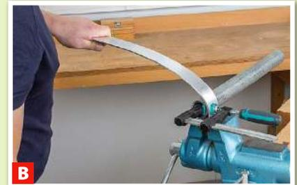
**B** Ein Rohr im Geländerdurchmesser dahinterspannen und das Profil umbiegen.
