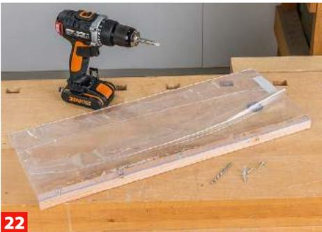
**22** Auch den Deckel aus Acrylglas zuschneiden und an einer Seite vorbohren. Hier wird in ganzer Länge eine Griffleiste angeschraubt.
