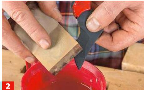
**2** Klingen mit einem mit Wasser benetzten Abziehstein bearbeiten – erst mit der stärker gekörnten, dann mit der feineren Seite.
