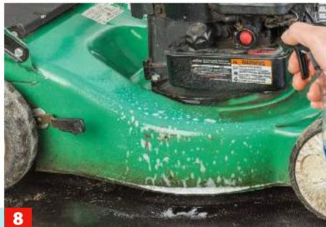
Prozedur auf der Oberseite des Mähers wiederholen. Kein Reinigungsmittel in die Lüfteröffnungen des Motors sprühen.
