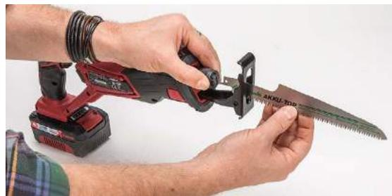
**EINFACH:** Die Sägeblattverriegelung wird durch Drehen des Aufnahmerings betätigt, er schnappt selbst zurück.
