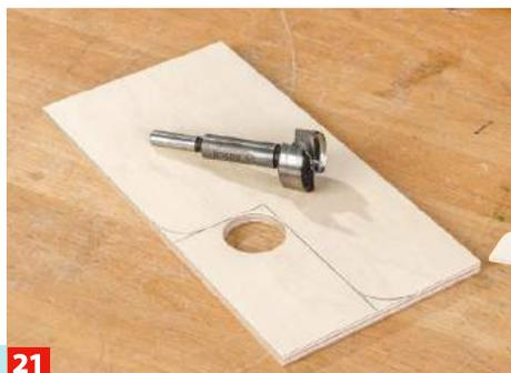
**21** Den Innenradius können Sie mit einem Forstnerbohrer schneiden, den Rest mit der Stichsäge.
