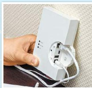
**DIE ZENTRALE** wird mit dem Router verbunden und per Browser bedient.
