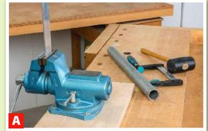
**A** Spannen Sie das Aluprofil (noch nicht kürzen!) in den Schraubstock.
