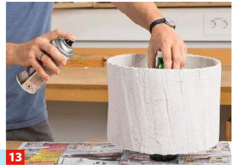
**13** Wenn er komplett durchgetrocknet ist, sollten Sie matten Klarlack aufsprühen. So lässt sich später Staub leichter entfernen.
