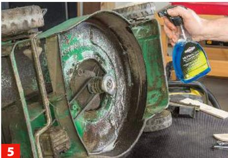
**5** Tragen Sie nun Reiniger auf oder lösen Sie den feineren Schmutz mit warmem Wasser und etwas Spülmittel.
