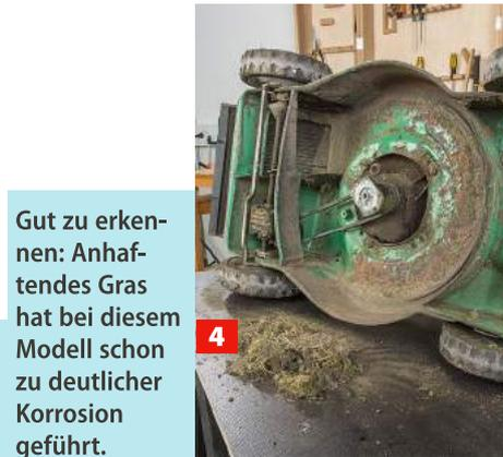
Gut zu erkennen: Anhaftendes Gras hat bei diesem Modell schon zu deutlicher Korrosion geführt.
