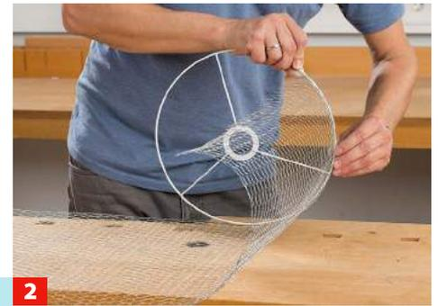
**2** Rollen Sie anschließend verzinktes Sechseck-Drahtgeflecht (Kaninchendraht) um den oberen Ring.
