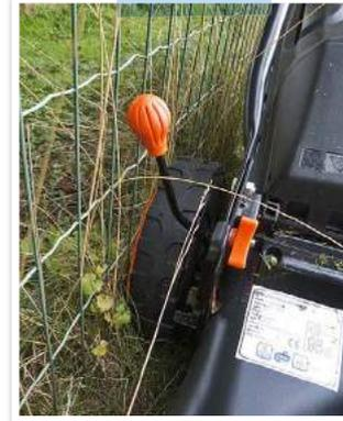
**OBEN:** Herumfliegende Grasreste verschmutzen das Gerät. **LINKS:** Der vorstehende Hebel der Höhenverstellung stört beim randnahen Mähen.
