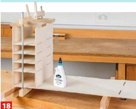
**18** Das Schubkastenelement leimen Sie danach auf dem Boden fest, gefolgt von ...
