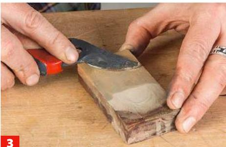
**3** Die Gegenseite der Klinge ebenfalls flach auf dem befeuchteten Stein abziehen, um Grate zu entfernen.
