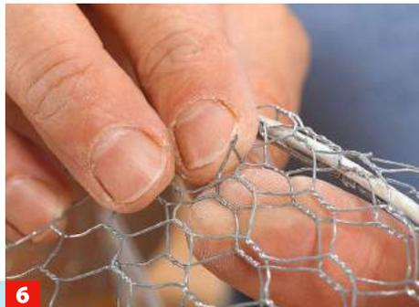
**6** Den Zylinder schließen Sie, indem Sie die abgekniffenen Drahtenden ineinander verhaken und umbiegen – innen und außen.
