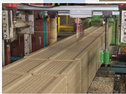
**VIELE POREN** Die Herstellung des neuen *Purus PL-075* erfolgt auf Basis von Wasser und Luft in Kombination mit einer speziellen Mischung abgestimmter Lehmarten. Für die gute Wärmedämmung ist ein hoher Luftkammeranteil von 54 Prozent verantwortlich.
