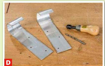
**D** Das Aluprofil mit der Metallsäge ablängen und Löcher bohren und senken.
