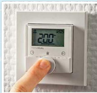
**WANDSTEUERUNG:** Sie wird wie eine klassische Heizungsregelung bedient und beeinflusst die Zentrale.
