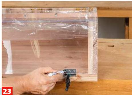
**23** Den Deckel auf die Box legen und die Position der beiden Scharniere markieren. Diese werden nun zuerst am Deckel ...
