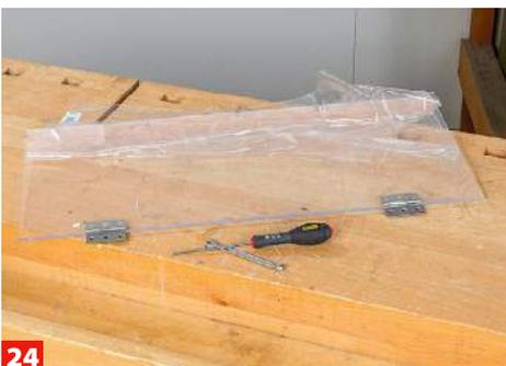
**24** ... mit Schrauben (ggf. kürzen) und Muttern befestigt. Unbedingt vorbohren. Die Schraubenenden sind scharfkantig, feilen ist nötig!
