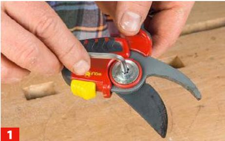
**1** Gartenscheren können Sie leicht nachschärfen. Dazu die Verschraubung am Gelenk lösen, um die beiden Klingen zu trennen.
