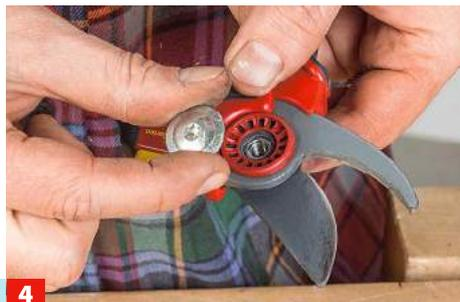
**4** Schere wieder montieren, Gelenk mit einigen Tropfen Öl versehen. Die Verbindung nicht zu fest anziehen und Funktion prüfen.
