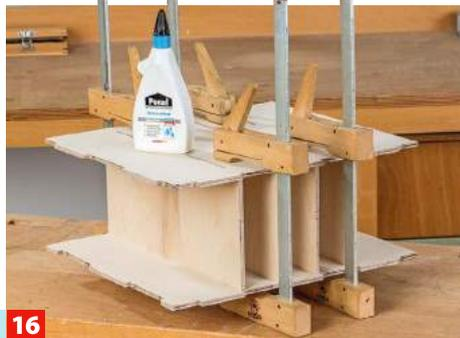
**16** Dann wird verleimt. Beginnen Sie mit der linken Außenwand, den Böden und der Zwischenwand. Bis zum Abbinden verpressen.
