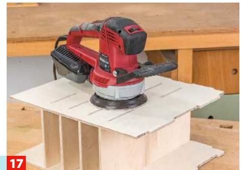
**17** Anschließend beide Seiten plan schleifen; das ist zum jetzigen Zeitpunkt deutlich einfacher als zum Schluss.
