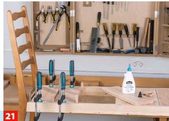
21 Zuletzt wird die Beplankung vermittelt. Sie können die Bretter aufleimen, zusätzlich Holzdübel verwenden oder verschrauben.
