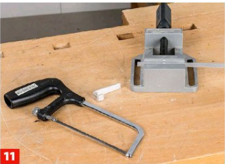
11 Den einseitig geformten Haken längen Sie nun auf 50 mm (vom Hakenkopf bis zur Sägekante) ab.
