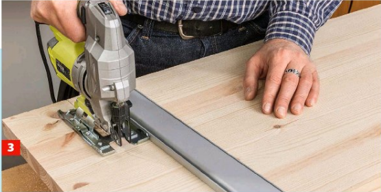
3 Die Schiene kann zum Führen von Werkzeugen dienen – allerdings kann die Maschine seitlich abwandern.
