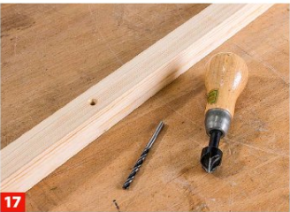
17 Schneiden Sie zwei knapp 30 mm breite Auflagerleisten in der Länge der Riegel (ohne Zapfen) zu und bohren/senken sie.
