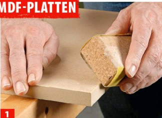
1 Schöne Oberflächen erhält man nur mit fülender Grundierung: Flächen und vor allem Kanten sorgfältig schleifen bzw. brechen.
