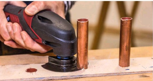
- VIBRATION: Extrem starke Schwingungen traten beim Sägen von Kupferrohren auf – hier bei Einhell , aber auch bei Stanley .
