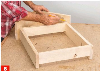
8 Setzen Sie das Dach auf den Rahmen und markieren Sie, wo die beiden Teile zusammenstoßen.
