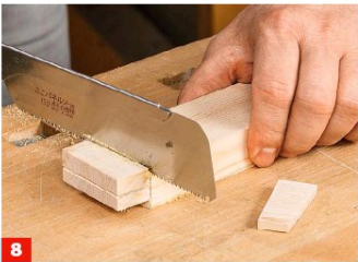
8 Anschließend schneiden Sie an der Markierung bis zum Zapfen ein. Danach wird der Zapfen oben und unten abgesetzt ...
