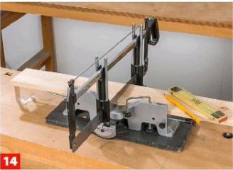
14 Entsprechend dem lichten Abstand der Sitzriegel zueinander schneiden Sie jetzt die Sitzbretter aus Douglasie-Glatkantdielen zu.
