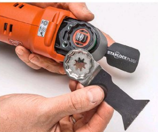
+ SIMPEL: Bei Fein wird das Werkzeug durch einfaches Andrücken montiert.
