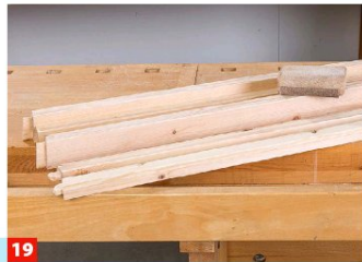
19 Austretenden Leim kurz nach dem Abbinden mit dem Stechbeitel abstoßen und alle Bauteile gründlich schleifen.
