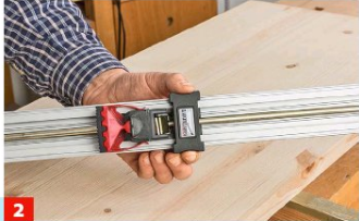
2 ... wird ein verschiebbarer Reiter an die Werkstückbreite angepasst, bevor der Exzentergriff die Schiene fixiert.
