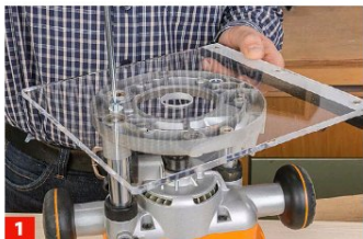
1 PLEXIGLAS erlaubt eine gut kontrollierbare Fräsung entlang der Führungsschiene, dazu wird die Maschine auf der Platte ...
