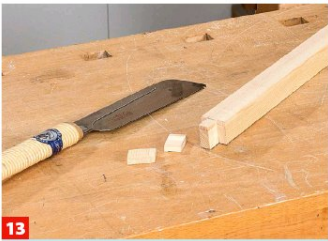
13 ... mit der Säge absetzen und mit der Feile runden. Achten Sie darauf, dass der Zapfen nicht zu lang gerät!
