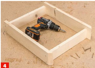
4 Setzen Sie die beiden Seiten (Schrägen befinden sich auf derselben Seite) mit Boden und Deckel zu einem Rahmen zusammen.
