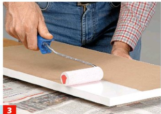
3 Anschließend die Flächen grundieren, dann trocknen lassen, mit 240er-Körnung zwischenschleifen und erneut Grundierung auftragen.
