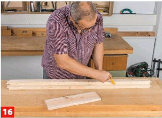
16 ... Bretter auf den Innenseiten der Querriegel oben bündig an an und reißen das Maß dort über die ganze Länge auf.
