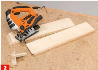
2 Die beiden Seitenteile werden oben für die Dachaufnahme angeschrägt.
