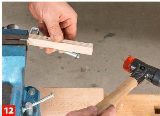
12 Dieses Ende (gerade) 15 mm weit in den Schraubstock spannen und abkanten.
