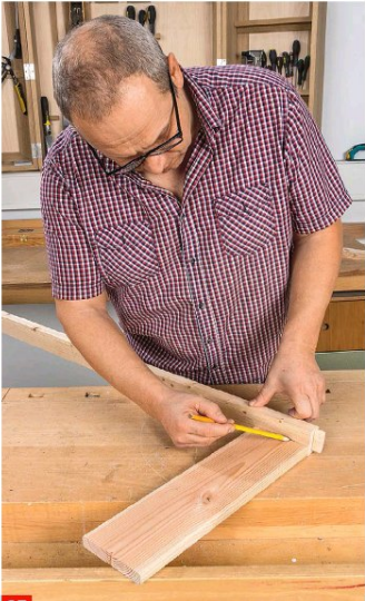
15 Für die Bank brauchen wir neun 120 mm breite, 20 mm starke und 350 mm lange Sitzbretter. Zeichnen Sie die Stärke der ...
