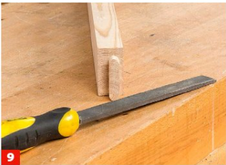
9 ... und zu guter Letzt – da das Zapfenloch gerundet war – mit der Feile an das Gegenstück angepasst.
