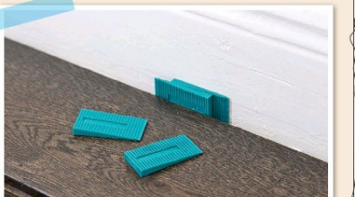
19 Zugeschnittene Holzstücke oder fertige Distanzkeile aus Kunststoff sorgen für die Einhaltung von Dehnungsfugen; nach der Verlegung einfach herausnehmen.
