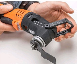
- UMSTÄNDLICH: Die Werkzeugverriegelung bei AEG ist anspruchsvoll.
