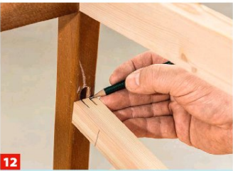
12 Durch die Schrägstellung der Beine werden die Streben hier etwas länger als die Sitzriegel. Die Zapfen wie gehabt anzeichnen, ...
