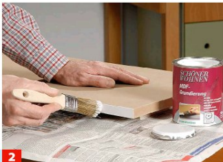
2 Dann die Kanten mit MDF-Grundierung gestrichen. Nach Trocknung die auf die Flächen gelaufene Grundierung abschleifen.
