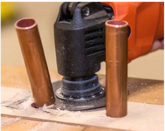
- SCHRÄG: Bei Fein erschwert das nicht plan aufliegende Sägeblatt den Schnitt.
