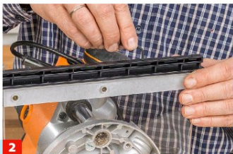
2 ... fest montiert. Dank Justierbarer Madenschrauben wird die Führung spielfrei an der Schiene entlang geführt.
