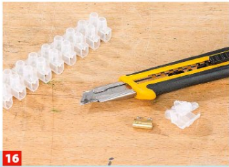
16 ... Regel für die meisten Anwendungen aus. Zum Einstellen der Länge hinter dem Bild haben wir eine Lüsterklemme „geschält“.
