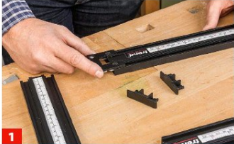
1 VERSCHIEBBARE Verbinder dienen der Größeneinstellung der Schablone, sie sind mit Halteschrauben fixierbar.
