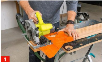
1 HALTENASEN am Anschlag (ca. 20 Euro) werden mit dem Daumen gehalten – ein Festspannen der Führung ist entbehrlich.
