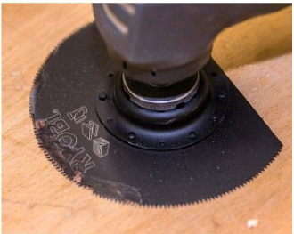
- AUSBRUCH: Bei Ryobi hielt die Zahnung beim Rohrsägen nicht stand.
