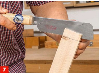
7 Mit einer Gestell-, Fein- oder Ziehsäge schneiden Sie nun die Enden an beiden Seiten vom Stirnholz zum Grund ein.
