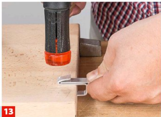
13 Das im 90°-Winkel abstehende Ende nun flach auf den Haken schlagen, dabei ein Reststück des Flachprofils zwischenlegen.
