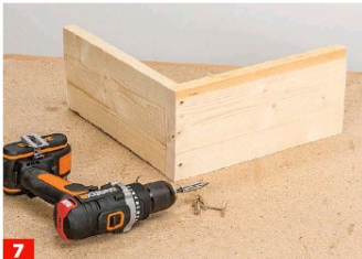
7 Verschrauben Sie dann die beiden Dachteile winklig miteinander.
