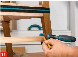
11 Jetzt wiederholt sich der Ablauf ab Arbeitsschritt vier mit den 27-mm-Querstreben.
