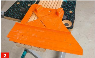
2 Der Schnitt erfolgt stets an der Kante der Lade – deshalb kann die Schiene auch gut am zuvor ermittelten Riss angelegt werden.
