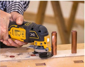
- STÖRT: Die Sägeblattbefestigung behindert bei DeWalt den Schnitt.
