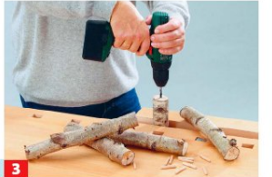
3 Alle Verbindungen der Krippe sind gedübelt. Zuerst bereiten Sie die Kopfbohrungen in den Ästen vor.
