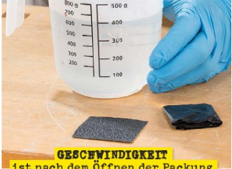
16 GESCHWINDIGKEIT ist nach dem Öffnen der Packung ein Muss. Das Band zügig verarbeiten und sofort in der Form fixieren. Der Härtingsprozess setzt unverzüglich ein.
