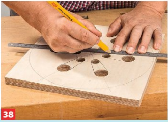
38 Kreis aufzeichnen und in sechs Segmenten teilen. Auf den Segmentgrenzen je ein 20er und ein 30er Loch bohren und die ...
