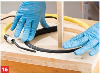
17 Legen Sie den noch elastischen Schlauch in die Form. Sie müssen sich beeilen, denn der Härtingsprozess setzt schnell ein.
