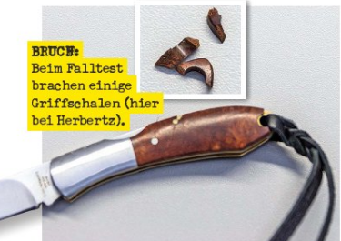
- FALLTEST: Abgebrochene Teile im Handhabungsbereich wurden abgewertet.
