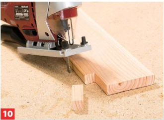
10 Die Ausklinkung wird dann mit der Stichsäge ausgeschnitten.
