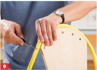
9 Anschließend den Schlauch exakt in und über die Form legen, etwa zwei Zentimeter überstehen lassen und dort ablängen.
