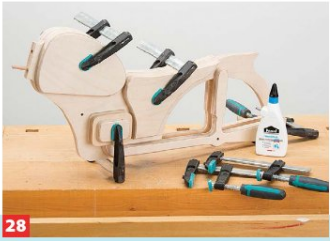
28 Anschließend leimen und pressen Sie die Bauteile mit den Dübeln zusammen. Tipp: bei Bedarf schon vorher farbig lackieren!
