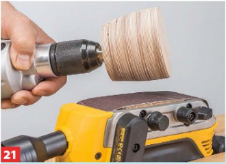
21 Wer den Scheinwerfer nicht dreheln kann, hilft sich mit einer Stockschraube, einer Bohrmaschine und einem eingespannten ...
