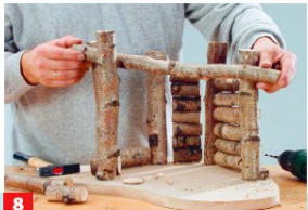
8 Verdübeln Sie nun die beiden Dachsparren seitlich mit den Streben – vorn eine lange, hinten die kurze.
