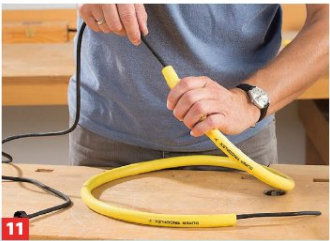
11 Führen Sie die Leitung durch den Schlauch hindurch. Ggf. mit etwas Wasser und Spülmittel leicht anfeuchten.
