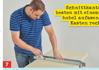
7 Der Plattenzuschnitt erfolgt mit einer Stichsäge oder mit Cutter entlang einer Schiene.
