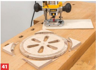
41 Dann den Drehpunkt nach außen versetzen und das Rad durch den Radmittelpunkt von beiden Seiten herausfräsen.
