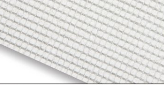
BLÄHGLAS-GRANULAT-PLATTE Veroboard Rapid : Leichtbauplatte aus Blähglasgranulat, mit Glasfaserarmierungsgewebe verpresst. Wasserfest, sehr stabil, direkt flies- und putzbar. Maße: 1200 x 800, 2400 x 1200 und 2600 x 1250 mm. Stärken: 8 bis 20 mm.
