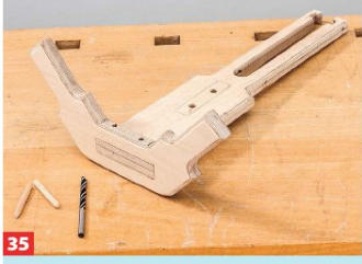
35 Auch Lenker und Gabel jetzt verdübeln: Die Bauteile durchbohren, Leim angeben, Dübel einsetzen und bündig abblenden.
