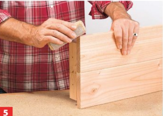
5 Nach dem Deckel wird so auch der Boden gefertigt. Zum Schluss die Kanten glätten.
