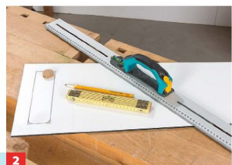
2 Zeichnen Sie an der breiteren Seite die Aussparung für das Handtuch auf; in den Ecken einen 35-mm-Radius anlegen.
