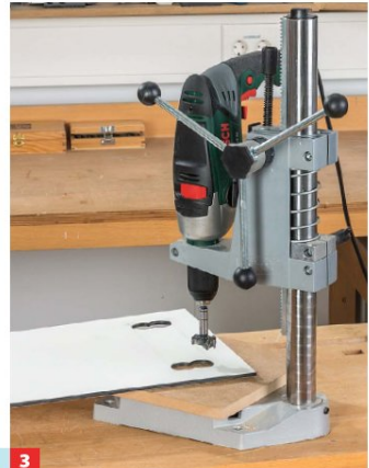
3 Durchbohren Sie die Ecken. Hierzu brauchen Sie einen 35-mm-Kunstbohrer, ein Forstnerbohrer wird mit dem Material nicht fertig.
