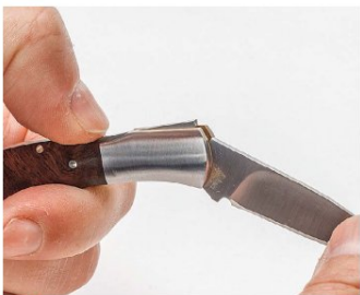
- SCHWERGÄNGIG: Bei Herbertz fällt die Entriegelung der Klinge schwer.
