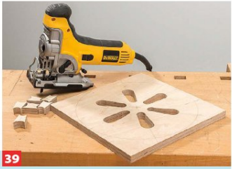
39 ... Lochumrisse miteinander verbinden. Dann die Zwischenteile heraus schneiden.
