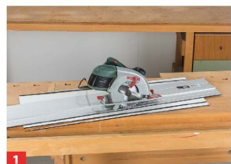
1 Den Zuschnitt erledigen Sie mit einer Handkreissäge mit feinzahnigem, hartmetallbestücktem Sägeblatt entlang einer Schiene.
