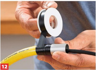
12 Am Fassungsende des Schlauchs ein etwa 3 cm langes Alu-Röhrchen knapp 2 cm überstülpen und mit Isolierband befestigen.
