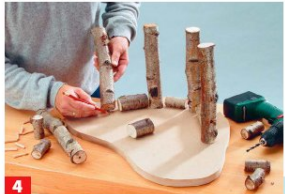
4 Die abgelenkten Seiten- und Querstreben auslegen: So ermitteln Sie die Bohrpositionen.
