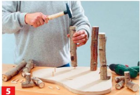
5 Nachdem Sie die Holzdübel eingesetzt haben, erhalten die fünf Seitenstreben ihre endgültige Position.
