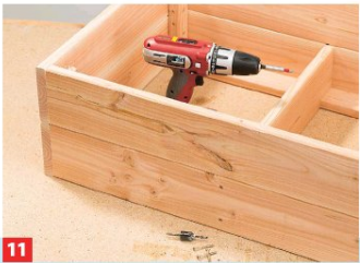
11 Drehen Sie den Korpus auf den „Rücken“ und verschrauben Sie das Brett der Mittelwand mit Deckel und Boden.
