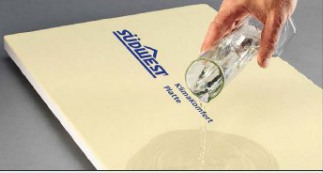
PERLITE-PLATTE Südwest Klimakomfortplatte : Dämmplatte (innerhalb eines Schallschutzsystems) auf Basis von Vulkanstein (Perlite). Feuchtigkeitsregulierend, kann bis zu 13,7 l Wasser/m² aufnehmen! Maße: 625 x 416 x 25 mm.
