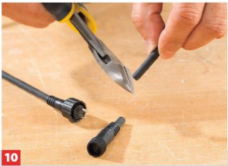
10 Jetzt wird die Buchse der Trafo-Ausgangsleitung abgeschnitten – den Stecker zum Trafo-Ausgang nicht abschneiden!
