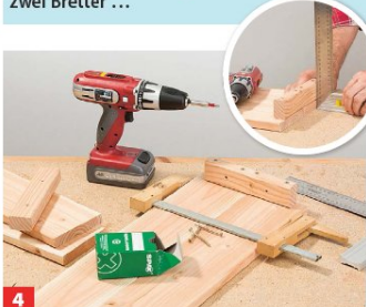
4 Die beiden Bretter verspannen und dann mit den Leisten bündig zum Rand (siehe Detailfoto) verschrauben.
