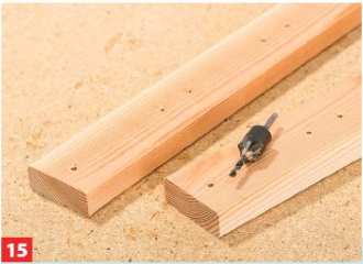
15 ... den Leisten die Löcher anzeichnen, bohren und senken.
