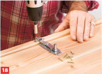
18 Mittig wird dann der Fensterriegel aufgeschraubt. Die Schlaufe wird auf dem Korpus befestigt.
