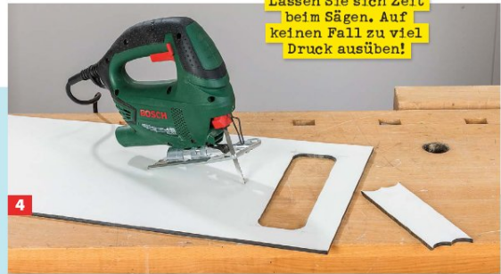
4 Den Rest erledigen Sie mit der Stichsäge. Auch hier ein feinzahniges Blatt verwenden und ohne Pendelhub behutsam die Säge führen.
