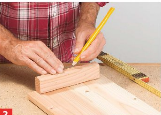
2 ... parallel aus, platzieren Sie an den Enden die aufrechte Leiste (vermitteln) und zeichnen Sie oben und seitlich die Löcher ...
