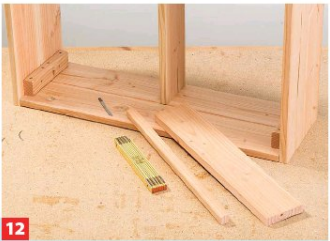
12 Damit die Außenklappe bündig schließt, springt das zweite Brett etwas zurück. Dieses entsprechend auf Breite schneiden.
