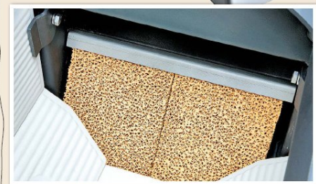
Die Speichermasse befindet sich beim Arena Plus (siehe links) im oberen Bereich des Ofens rund um den Rauchgasabzug und gibt die gespeicherte Wärme noch lange nach Erlöschen der Flammen ab.
