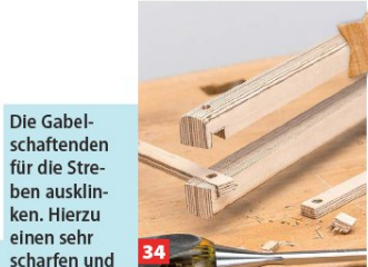
34 Die Gabelschaftenden für die Streben ausklinken. Hierzu einen sehr scharfen und schmalen Stechbeitel verwenden.
