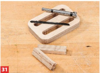
31 Auch der Gepäckträger darf nicht fehlen: Zuschneiden und beidseitig mit dem Abrundfräser bearbeiten.
