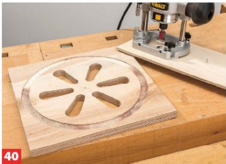
40 Mit Oberfräse und Zirkelplatte sowie einem Fingerfräser nehmen Sie nun etwa die oberste Furnierschicht für den Reifen ab.
