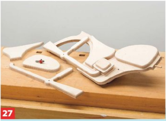
27 Nun werden auch die Tankscheiben, die Deckelscheiben und die Auspuff-Federbein-Bauteile außen mit dem Fräser gerundet.
