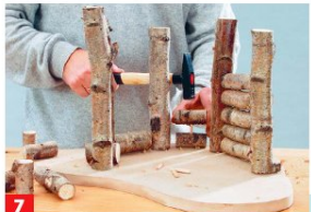
7 ... und miteinander verdübeln. So entstehen nacheinander die beiden geschlossenen Seitenwände.
