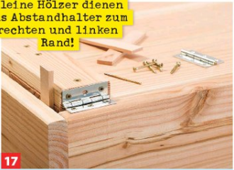
17 Kleiner Hölzer dienen als Abstandhalter zum rechten und linken Rand! Legen Sie die fertige Klappe in Ihre Endposition auf den Korpus und bringen Sie unterhalb der Leisten die Scharniere an.
