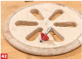
42 Die Speichenzwischenräume mit dem Kegelfräser leicht fassen, den Reifen außen mit dem Abrundfräser runden.
