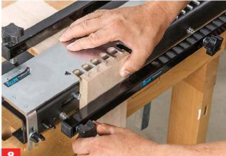
Dann werden die Bauteile gelöst und in folgender Reihenfolge neu eingespannt: Erst das senkrechte Bauteil am Seitenanschlag ...
