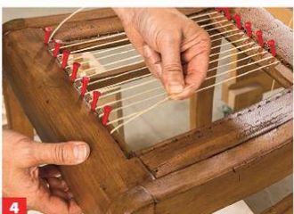
4 ... Schale zeigt immer nach oben! So führen Sie die Rohrschiene immer hin und her. Ist der Faden zu Ende, verwenden Sie ein ...
