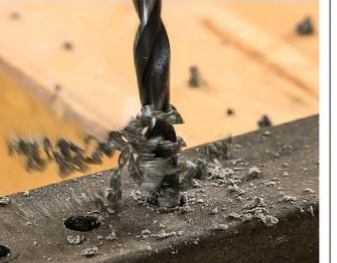
- ANHÄNGLICH: Die Bohrcraft -Wendel setzt sich beim WPC-Bohren schnell zu.
