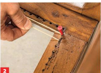
2 ... neben der Eckbohrung unten etwa 10 cm herausstehen lassen und mit den Keilstiften fixieren. Führen Sie das Rohr durch das ...
