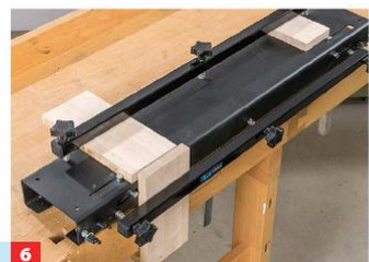
6 ... Bauteile ein und spannen diese ein. Bei kürzeren Teilen am Ende Zulagen mit gleicher Materialstärke einspannen.
