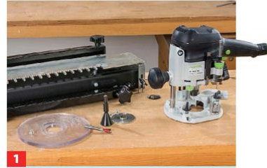
1 Montieren Sie die Zinkenfräseinrichtung entsprechend der Montageanleitung. Danach geht es an das Rüsten der Oberfräse.
