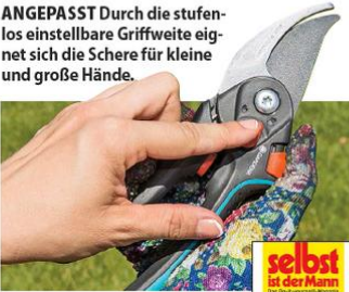
SCHNITT UND WEG: Die Bypass-Schere trennt Zweige und Äste bis zu 24 mm Durchmesser.
