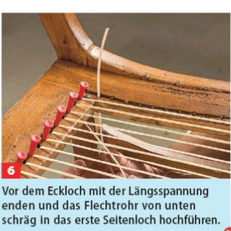
7 Vor dem Eckloch mit der Längsspannung enden und das Flechtrohr von unten schräg in das erste Seitenloch hochführen.
