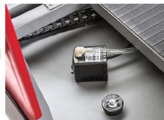
PUMPE: Sie fördert Kühlwasser aus dem Becken unter der Werkstückablage.
