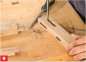
8 Zapfen sorgfältig von Dreck und altem Leim befreien, Schlitz sauber, aber nicht zu stark nachstemmen. Defekte Bauteile ...
