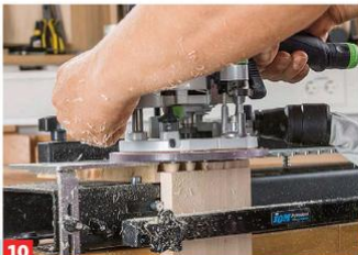
... Bauteil schieben und fixieren. Jetzt kann gefräst werden: Um Ausriss zu minimieren, am besten erst das vordere Brett rundum ...
