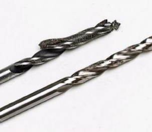
UNTERSCHIED: Mit beiden Bohrern wurde WPC gebohrt, die Hawera -Wendel setzt sich zu.
