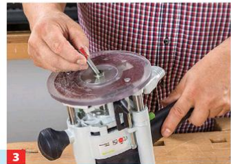
3 ... Senklöcher dort bohren, wo der Frästeller Verschraubungen zulässt, und Platte festschrauben. Danach den Fräser einspannen.
