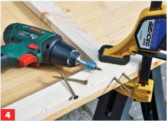
4 ... auf Böcken in einer guten Arbeitshöhe platzieren. Die Verbindungen dann mit Zwingen sichern und verschrauben.
