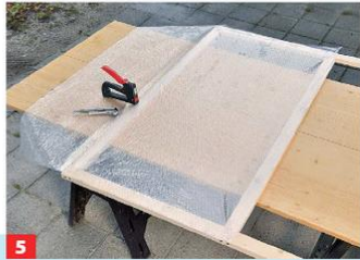
5 Die Seiten werden mit Luftpolsterfolie bezogen. Schneiden Sie diese zunächst grob zu und tackern Sie sie auf dem Rahmen fest.
