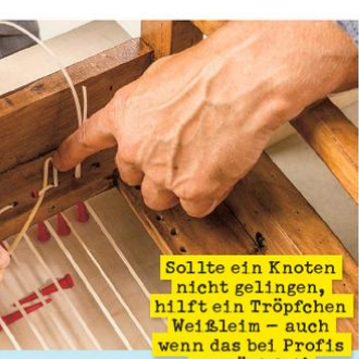
6 Sollte ein Knoten nicht gelingen, hilft ein Tröpfchen Weißleim – auch wenn das bei Profis verpönt ist!
