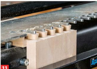
... leicht mit dem Fräser absetzen, dann die Fräse mit der Kopierhülse zweimal exakt entlang der Schablone führen.
