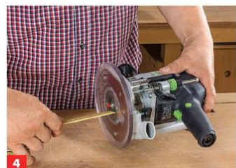
4 Stellen Sie nun die Frästiefe ein. Die in der Anleitung angegebene Tiefe ist nur ein Anhaltspunkt, wir mussten sie nach den ...
