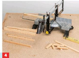
4 Weiter geht es mit dem Gebälk. Die Toreinfassungen bestehen aus 20-x-20-mm-Hölzern, auf den Flächen kommen flache ...
