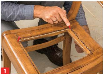
1 Beginnen Sie mit der Längsspannung – bei gleicher Lochzahl seitlich, sonst in der Mitte. Das Flechtrohr im ersten Loch ...
