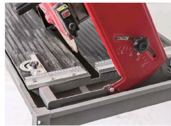
GEHRUNG: Mit geneigter Führung können auch gefaste Kanten hergestellt werden.
