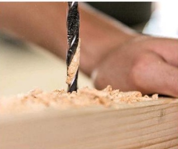
- REIBUNG: Bleibt das Bohrmehl in der Wendel haften, erhöht sich die Reibung – der Vortrieb fällt schwer, der Bohrer läuft heiß.
