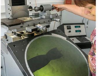
Bei der VPA -Maßprüfung mit dem Profilprojektor gab es keine Beanstandungen.
