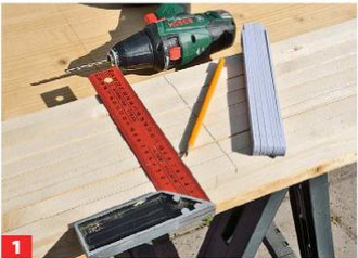
1 Markieren Sie auf den zugeschnittenen Querstreben der Rahmenteile, wo die mittleren Längsstreben befestigt werden.
