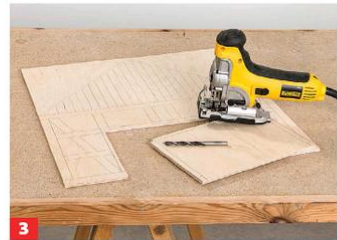
3 Jetzt werden die Einfluglöcher (Scheunentore) mit der Stichsäge herausgetrennt. Hier noch nicht den Giebel zuschneiden!
