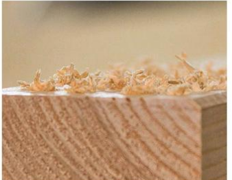
- UNSAUBER: Viele Bohrer schneiden die Holzfasern nicht sauber ab.
