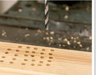
- VERSCHLEISS: Bei einigen Bohrern (hier JN Tools ) ist Verschleiß spürbar.
