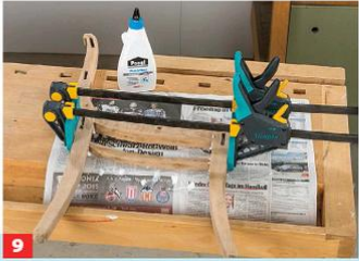
9 ... reparieren bzw. nachleimen. Dann die Baugruppen verleimen: erst die beiden Seitenteile, dann den kompletten Sitzrahmen.
