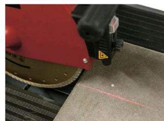
LASER: Ein batteriebetriebener Laser zeigt den Schnittverlauf präzise an.
