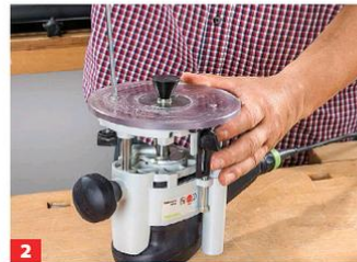
2 Kopierring auf der Acrylglasplatte verschrauben, dann die Adapterplatte auf Ihrer Oberfräse mit dem Zentrierkonus ausrichten, ...
