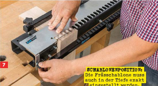
Dann werden die Bauteile gelöst und in folgender Reihenfolge neu eingespannt: Erst das senkrechte Bauteil am Seitenanschlag ...
