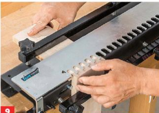
... gegen die Frässhablone schieben und festspannen, dann das waagerechte Element am Anschlag gegen das vordere ...
