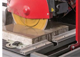
NASS: Das Kühlwasser bindet das freiwerdende Material aus dem Schnittkanal.
