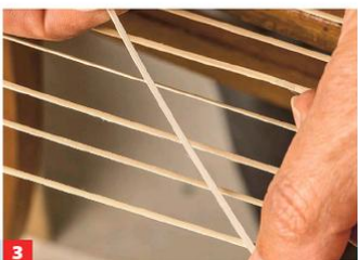
3 ... gegenüberliegende Loch nach unten und durch das Nebenloch wieder hoch. Das Rohr dabei nicht verdrehen; die leicht glänzende ...
