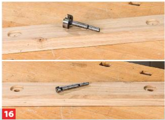
16 Für die Reflexröhrchen zwei Zapfensenkungen bohren: 4 mm tief mit einem 35er Forstnerbohrer schneiden und dann mit dem ...
