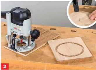
2 In die Front wird die Ringnut zum Einlassen des W 130 X gefräst. Dies gelingt präzise, wenn Sie die Oberfräse mit einer ...
