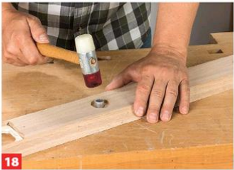
18 Dann schlagen Sie die Röhrchen behutsam senkrecht und bündig mit der Front ein.
