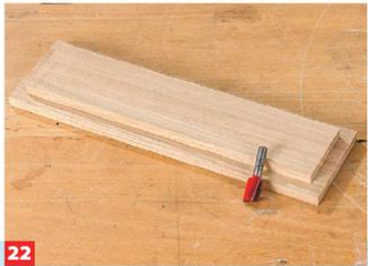
22 Die beiden Rückwände der in einem Gehäuse vereinten Lautsprecher rundum falzen.
