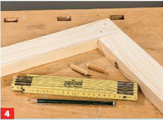
4 Stecken Sie die Schlitz-Zapfen-Verbindung fest zusammen und markieren die Positionen der Holznägel auf der Diagonalen.
