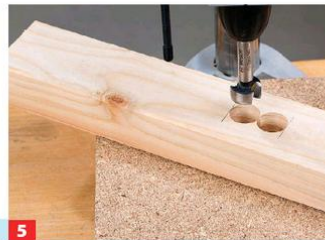
5 Dort mit dem 25-mm-Forstnerbohrer zwei Löcher bohren. Natürlich können Sie auch mit einem kleineren Durchmesser bohren, ...
