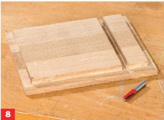
8 Die Rückwand erhält dann noch eine Nut für das obere Basskanal-Sperrholz ...
