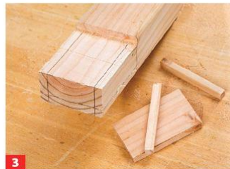
3 Nun den Zapfen mit der Gestellsäge absetzen. Ungeübte können hierfür auch eine Fein- oder Japansäge (ohne Rücken) verwenden.
