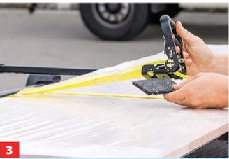
3 ... vorhanden, um beim weiteren Betätigen der Zurrmechanik Zug aufzubauen. Bei empfindlichen Oberflächen ein Schutzpad ...
