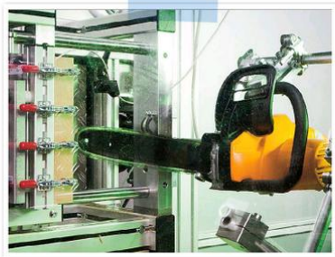
... IP-Prüfung, hier eine Überprüfung einer Ketten-sägenbremse (Kick-back-Prüfung).
