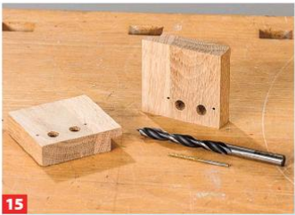
15 Die innenliegenden Seitenwände werden für die Anschlussklemmen (Terminals) gebohrt.
