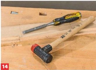
14 Dann werden die vom Einsatzfräsen verbliebenen Fräserradien bei Boden und Deckel sauber ausgestemmt.
