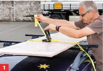
1 Spannratsche aufstellen und den Gurt auf der Gegenseite zur fest angenähten Schlaufe durch das Zurrgelenk hindurchführen.
