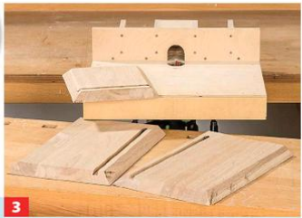
3 ... selbstgebauten Zirkelrinne ausstatten. In Front und Seitenwände fräsen Sie Nuten für die Basskanal-Sperrholzplatten.
