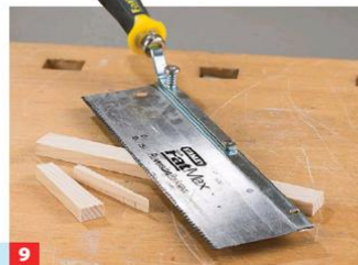
9 Anschließend den Keil zuschneiden. Bei 70 mm Länge und 10 mm Breite verjüngt sich unser Keil von 20 auf 10 mm.
