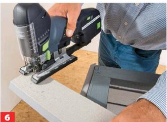
6 Hier müssen Sie nun für die drei Auflager Ausschnitte in Holzstärke anzeichnen und mit der Stichsäge vornehmen.
