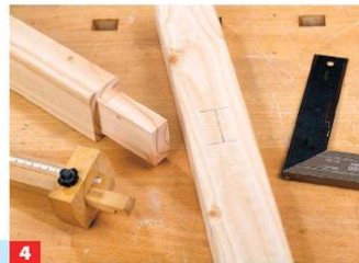
4 Anschließend wird das Zapfenloch aufgerissen. Zeichnen Sie auch die Mittelachse längs über dem Rechteck auf.
