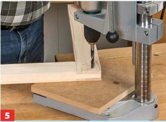
5 Mit einem etwa 0,5 mm kleineren Bohrdurchmesser im Vergleich zur Dübelstange durchbohren Sie nun die Holzverbindung ...
