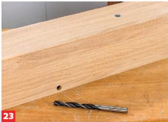
23 Soll die Soundbar an der Wand montiert werden, bringen Sie mittig Durchführungen bzw. Ausklinkungen für Anschlusskabel ein.
