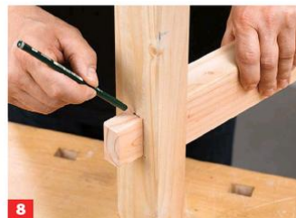
8 ... sitzt, desto stabiler die Verbindung. Zeichnen Sie jetzt oben und unten den Zapfenüberstand an.
