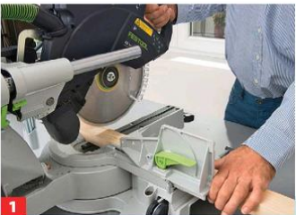
1 Längen Sie zunächst die Streben für das Grundgerüst und die Auflager für die Ablageflächen mit der Kappsäge ab.
