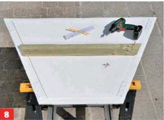
8 Ein Querbrett 25 cm unterhalb der Oberkante dient als Auflager für den inneren Boden. Auf zwei Seitenteilen befestigen.
