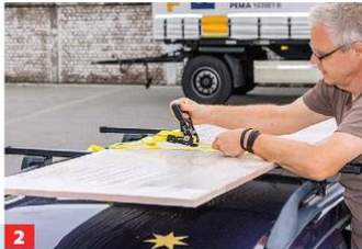
2 Gurt auf Spannung halten und die Ratsche zwei bis dreimal betätigen. Nun ist zwischen den Gurtwindungen ausreichend Reibung ...
