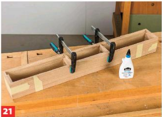
21 Leim angeben und zusammenklappen. Zwischen- und Außenwände ebenfalls bekleben und fixieren. Zwingen ansetzen.
