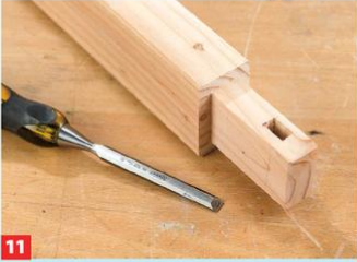
11 Das keilförmige Loch möglichst exakt ausstemmen. Damit der Keil ziehen kann, muss das Loch etwa 2-3 mm über die in Bild 8 ...
