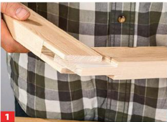
1 Ausgangspunkt ist hier eine Schlitz- und Zapfen-Verbindung, wie wir sie bereits in der Ausgabe 7/2016 dieser Serie gezeigt haben.
