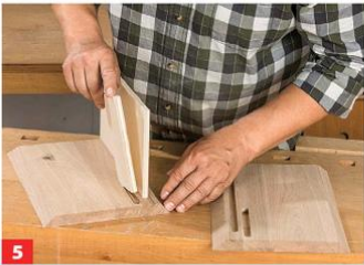
5 Stecken Sie die Platten zur Probe ein: sie sollten stramm in den Nuten sitzen.
