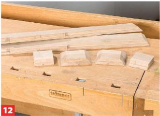
12 Die hinteren Kanten von Deckel, Boden, Außen- und Innenwänden werden nun für die Rückwände gefalzt – bei Deckel und Boden ...
