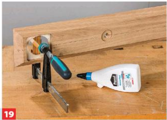
19 Jetzt leimen Sie die Sperrholzplättchen für die Montage der Breitbänder ein. Die nachgefaltete Anschlussseite zeigt nach innen.
