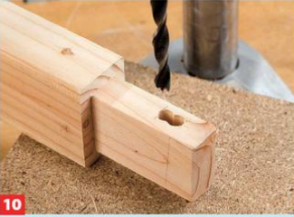
10 Nun muss das Loch für den Keil gebohrt werden. Tipp: Reißen Sie den Winkel des Keils auf den Seiten des Zapfens auf.
