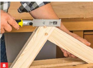
8 Sie können nun auch das zweite Holznagel-Ende fassen – oder beide Enden z. B. mit der Japansäge bündig abschneiden.
