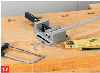
17 ... 15er Bohrer durchbohren. Die Aluröhrchen (Ø außen 15,5, innen 12,5 mm) auf 16 mm Länge kürzen und glatt schleifen.
