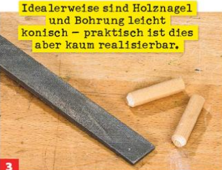
3 ... Durchmesser. Längen Sie zwei „Holznägel“ ab (Materialstärke der Holzverbindung plus ca. 2 cm). Je ein Ende anfasen.
