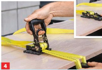
4 ... unter die Ratsche legen, um Druckstellen zu vermeiden. Zum Öffnen der Ratsche Verriegelung lösen und Ratsche flach öffnen.
