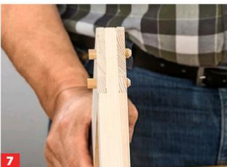
7 Etwa so sollte die Verbindung nun aussehen. Hier hatte die Dübelstange einen Durchmesser von 9,5 mm, gebohrt haben wir 9 mm.
