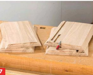
7 Gleiches gilt für die Seiten, den Boden und den Deckel. Hier die nach hinten zeigenden Kanten falzen.
