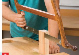
2 ... 4 cm länger sein als das durchdrungene Holz (hier: 45 x 70 mm; Zapfen 25 x 50 mm breit und 45 + 40 = 85 mm lang).
