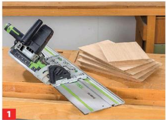
1 Schneiden Sie die Gehäusebauteile aus Eiche-Leimholz sorgfältig auf Gehrung zu.
