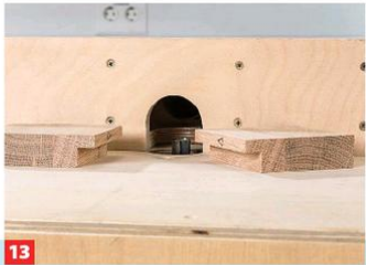
13 ... jeweils nur im Bereich der beiden geschlossenen Gehäuseteile. Wegen der kleinen Bauteile am besten stationär fräsen!
