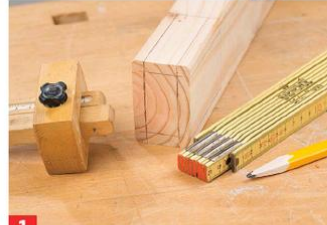
1 Reißen Sie den rundum abgesetzten Fingerzapfen mit dem Streichmaß an. Der Zapfen selbst sollte bei diesem Material etwa ...
