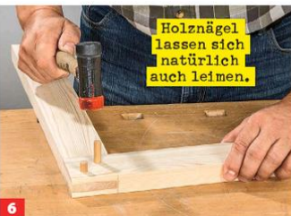
6 ... und schlagen die Holznägel ein, bis sie gleichmäßig, d. h. auch auf der Rückseite um ungefähr 10 mm hervorsteht.
