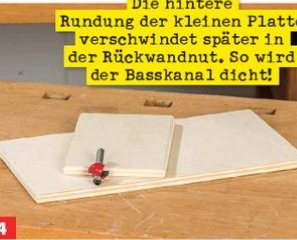
4 Die Platten werden mit dem Abrundfräser bearbeitet: die große Platte nur nach hinten, die kleine nach vorn und hinten.
