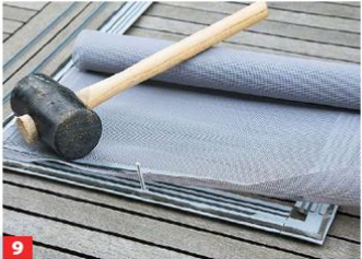
9 Das Gewebe auf der Abdeckung ausrichten und durch Einschlagen des Keder* fixieren. Dann rund um den Keder abschneiden.
