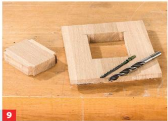
9 ... und dann einen Ausschnitt für das Anschluss-Terminal.
