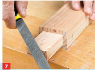
7 Fasen Sie den Fingerzapfen, damit beim Einschlagen in das Zapfenloch auf der Rückseite nichts ausreißt. Je genauer der Zapfen ...
