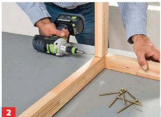
2 Diese werden rechtwinklig zum Rahmen zusammengeschraubt und dann lackiert. In der Zwischenzeit können Sie die ...
