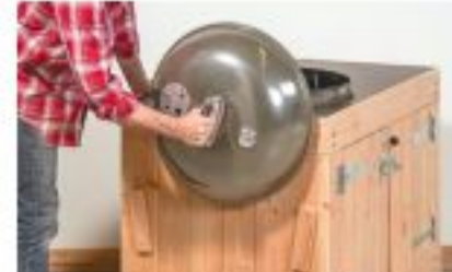
29 Zwei gefaltete und schräg an der Stirnwand angeschraubte Hölzer halten den Deckel, solange dieser nicht benutzt wird.
