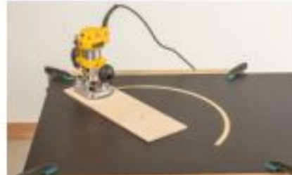
22 Die Position des Grills auf der Arbeitsplatte bestimmen, den Drehpunkt-Nagel mittig einlagern und schrittweise durchfräsen.
