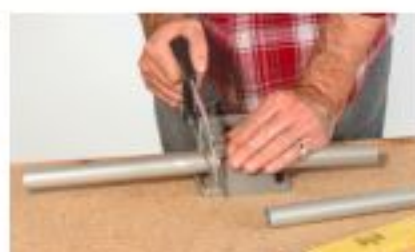
24 Damit Sie das Grillgestell nicht beschädigen, haben wir die Aluminiumbohrer als „Stummelbohrer“ zugeschnitten.
