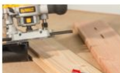
1 Die Douglasien-Glattsantbretter für die oberen und unteren Rahmen mit Übermaß auf der Kapp- und Gehrungssäge abblenden.
