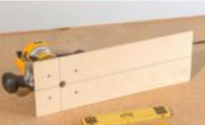
21 ... und Arbeitsplatte etwa 10 mm betragen. Montieren Sie eine Zirkelmarkierung für die Oberfläch mit entsprechendem Radius.
