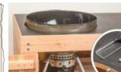
29 ... wird ein Anschlagbrett montiert. Vier Rundkopfschrauben und Alurohr-Abschnitte zentrieren die Grillwanne in der Lochmitte.
