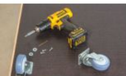
19 In den Ecken schrauben Sie die Lenkrollen fest. Die Feststell-Rollen kommen nach vorn, die Feststeller sollten dabei etwas vorstehen.
