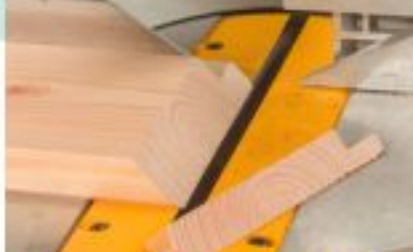
4 Geben Sie wasserfesten Konstruktionsklebstoff an die Gehrungsschnitte.
