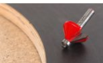
23 Mit dem Facfräser samt Anlaufring wird anschließend die Kante gebrochen. Ölen oder lackieren Sie die Kante der Siebdruckplatte.
