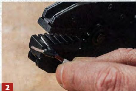
2 ... auf die leicht verdrehten Adern gesteckt und mit einer Spezialzange verpresst.
