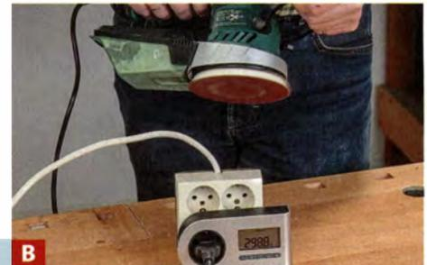
**B** ... angeschlossen werden. Bei Netzspannung verwendet man ein **ENERGIE-MESSGERÄT**.
