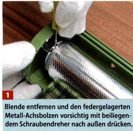
**1** Blende entfernen und den federgelagerten Metall-Achsbolzen vorsichtig mit beiliegendem Schraubendreher nach außen drücken.
