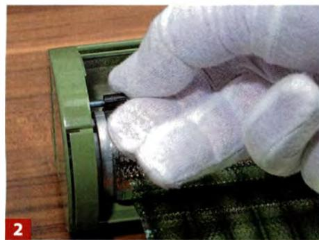
**2** Ggf. das Reibrad herausdrehen\*. All dies geschieht zum Schutz der Folie mit Handschuhen. Rollowickel komplett entnehmen.
