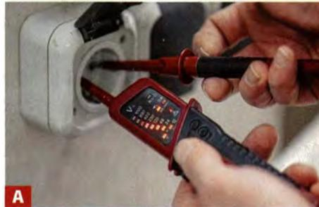
**A** Schnell ermitteln Sie Spannungen mit dem **DUSPOL**. Bei Kleinspannungen ...
