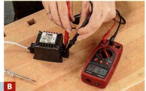
**B** ... erlaubt allerdings das **MULTIMETER** in der Regel eine genauere Anzeige.
