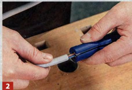
2 ... Länge einlegen, Klappe schließen. Dann das Werkzeug etwas drehen und ...
