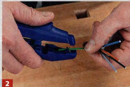
2 ... und das Adernende für die Verbindung in Klemmen abisolieren. Eine Skala ...
