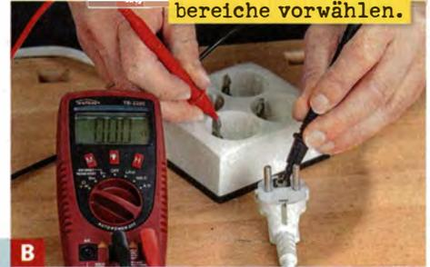
**B** ... **MULTIMETER** prüfen. Je nach Gerät ist die Anzeige optisch und/oder akustisch.
