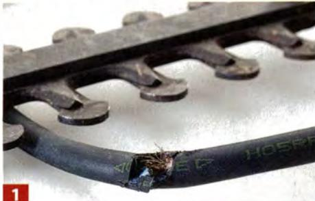
**1** Werden Zuleitungen oder Verlängerungskabel äußerlich verletzt, die Leitung auf keinen Fall mit Klebeband reparieren!
