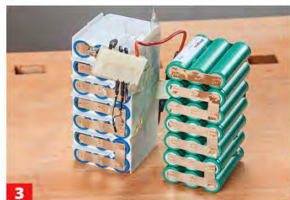
3 Anschlüsse und Sensoren vom alten Akku vorsichtig ablösen, sie müssen wieder eingebaut werden. Neue Anschlüsse ...
