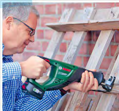
SÄBELSÄGE: Ein extrem vielseitiger Trenner, auch für gewachsenes Grün nutzbar
