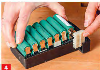
4 ... wieder an gleicher Stelle anlöten, das Zellenpaket wieder in das Gehäuse setzen und dieses wieder verschrauben.
