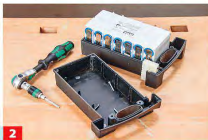
2 Die Lösung sind Ersatz-Zellen: Um Typ und Anzahl der Zellen zu ermitteln, müssen Sie den Akkupack meist öffnen.
