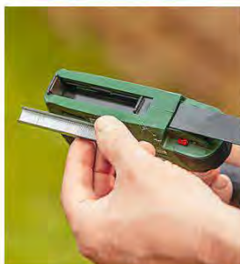
NACHSCHUB: Akkutacker arbeiten mit den üblichen Heftklammern, die Abmessungen variieren je nach Gerätetyp.
