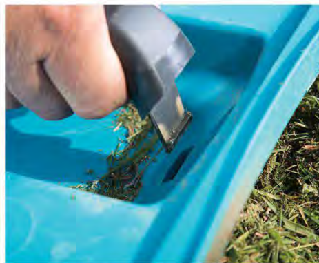
GELÖST: Bei Gardena löste sich im Praxistest der Griff vom Fangkorb.
