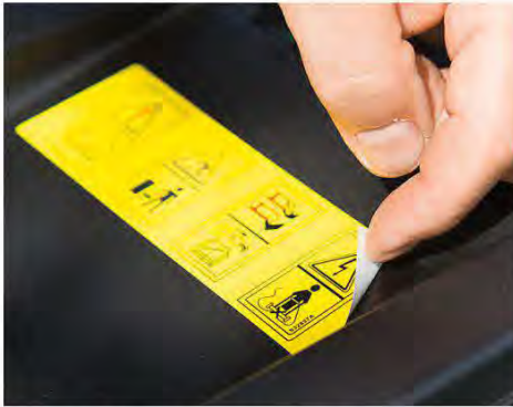
ABZIEHBILD: Die Sicherheits-Piktogramme sind bei Wingart zu leicht lösbar.
