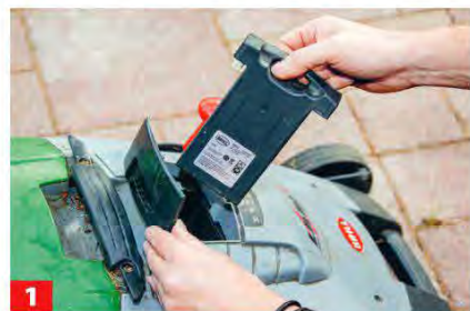
1 Nach rund 10 Jahren lieferte dieser Rasenmäher-Akku kaum noch Leistung. Ein Ersatzakku war nicht mehr erhältlich.
