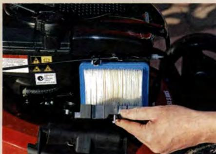
**LUFTFILTER** Kontrollieren Sie diesen regelmäßig. Den Lamellenfilter ausklopfen oder von innen nach außen mit Druckluft ausblasen.
