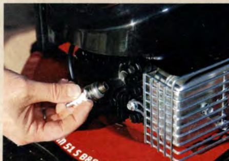
**ZÜNDKERZE** Die Elektroden sollten trocken und braun oder grau gefärbt sein. Ein Wechsel ist etwa alle 100 Betriebsstunden nötig.
