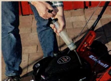
**ALTÖL** mit einer Pumpe entfernen, alternativ Ablassschraube (seitlich oder unter dem Mähdeck) öffnen und das Öl auffangen.
