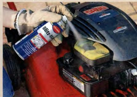
**STARTHILFE** Manchmal hakt es einfach. Dann das Spray von *Caramba* drei Sekunden in den Luftfilter oder die Ansaugöffnung sprühen.
