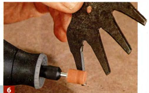
**6** ... reinigen. Dann die nun freiliegenden Schneiden mit einem rotierenden Schärfstein schleifen – hier mit einem *Dremel*.
