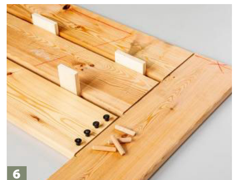
6 Die Ablagefläche besteht aus drei parallel angeordneten Brettern mit Abstand zueinander.
