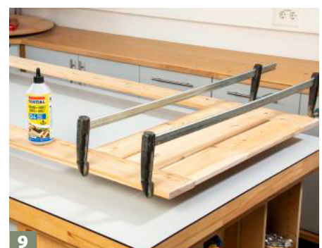
9 Wasserfesten PU-Kleber in die Dübellöcher geben, und die Bretter zusammenführen. Mit Zwingen verpressen.
