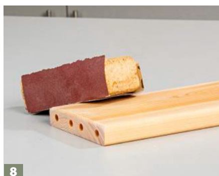
8 Vor dem Zusammenbau werden die Schnittkanten der Bretter gebrochen.
