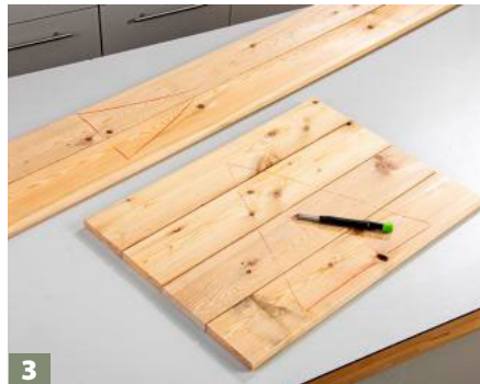
3 Auf die Bretter wird dann das Schreinerdreieck gezeichnet, um die Lage der Bauteile jederzeit sicher ...
