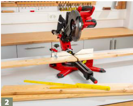
2 Dann schneiden Sie die Lärchenbretter mit der Kappsäge zu.
