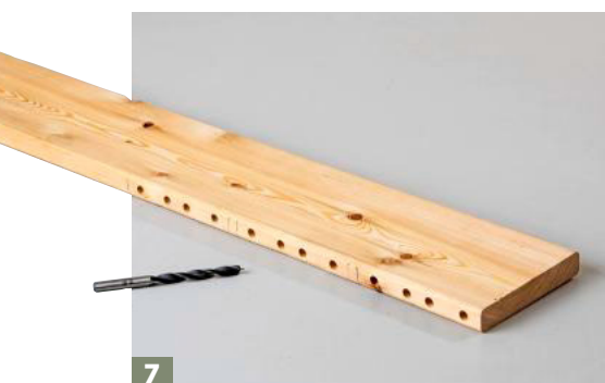
7 Hier sind die Bohrungen inklusive aufgezeichneter Dehnungsfuge zu sehen.
