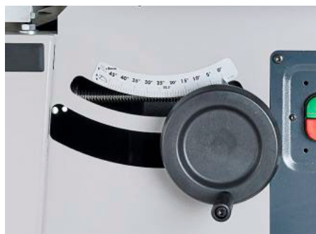
Präzise kann der Neigungswinkel des Sägeblatts vorgewählt werden.
