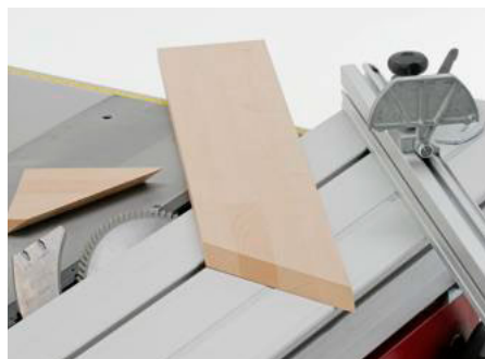
Gehrungs- und Doppelschrägschnitte lassen sich präzise ausführen.
