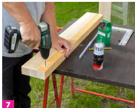
7 Für das Anschrauben der Sitzbankenelemente werden Holzleisten benötigt. Diese sind im Vorfeld vorzubohren.
