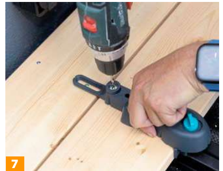
... Terrassenbohrmobil und Vorbohrer zum geführten, fluchtgerechten Vorbohren sowie einer Montagezwinde.
