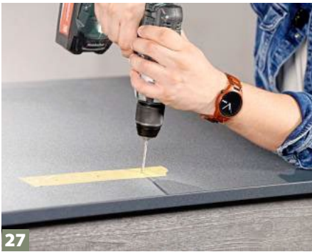
27 Für die Griffmontage am Deckel Kreppband aufkleben. So hat der Bohrer Halt und man kann sicher durch das ...
