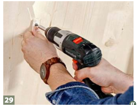
29 Das Gurtband zuschneiden und dann mit Schraube und Unterlegscheibe von innen am Deckel befestigen.
