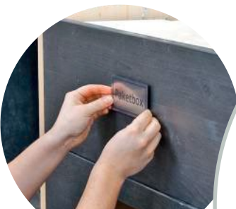
27 Für die Griffmontage am Deckel Kreppband aufkleben. So hat der Bohrer Halt und man kann sicher durch das ...
