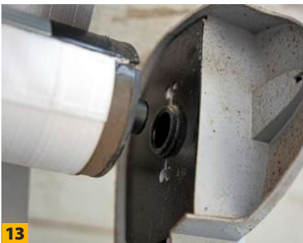
11 Die elektrische Leitung sollte nach dem Einsetzen des Motors nach unten zeigen. Die Markise hier wurde nicht ...
