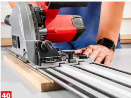
**40** Jetzt schneiden Sie die Schubkastenfront für den Boden ein – Sie können komplett durchnuten.
