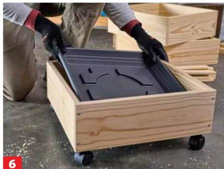
**6** Anschließend die Box wieder wenden: Jetzt kann die Pflanzschale hineingesetzt werden, sie sollte perfekt passen.
