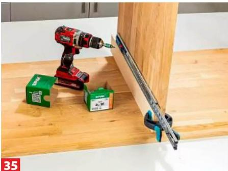
**35** Die äußeren Schienen im Korpus auf richtiger Höhe ausrichten und dort festschrauben.
