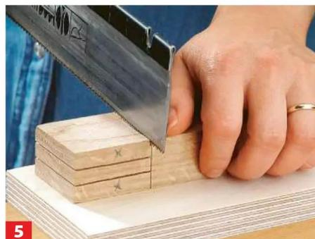
**5** Der Zapfen entsteht, indem Sie die Seiten mit der Feinsäge abschneiden.
