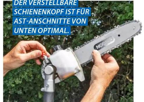
**DER VERSTELLBARE SCHIENENKOPF IST FÜR AST-ANSCHNITTE VON UNTEN OPTIMAL.**
