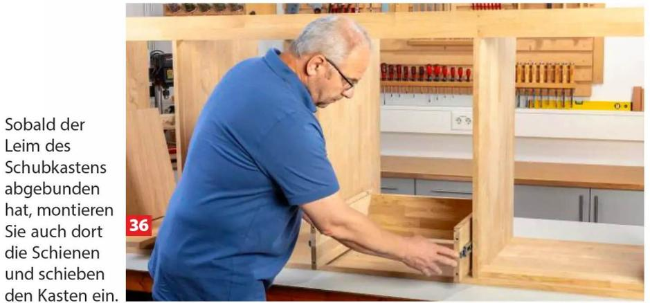
Sobald der Leim des Schubkastens abgedunstet hat, montieren Sie auch dort die Schienen und schieben den Kasten ein.
