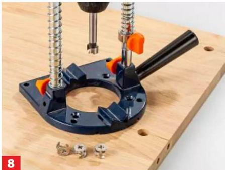
Bei den Wänden werden die Schraubdübellöcher von einer Seite für die Exzenter mit einem 15er Forstnerbohrer ...
