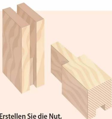
Erstellen Sie die Nut, noch bevor Schlitz und Zapfen herausgearbeitet werden.
