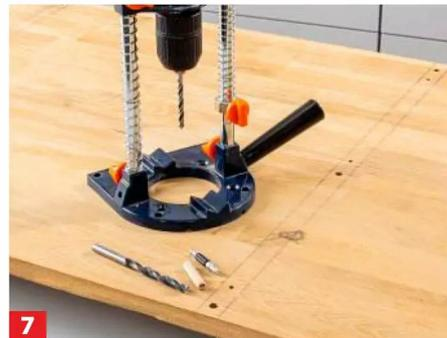
... Dübelstifte wird nun gebohrt: jeweils ein Dübelloch (8 mm) und ein Exzenter-Schraubdübelloch (5 mm).
