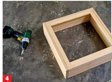
**4** ... innen bündig zur Brettseite aufsetzen (die Schmalseite sitzt auf) und quer durch die Leiste hindurch festschrauben.
