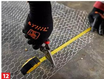
**12** Den Boden der oberen Kiste fertigen Sie aus Hasendraht (so kann der Humus auf die Etage darunter fallen).
