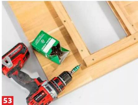
**53** Die Leisten bohren, senken und dann unter die Platte schrauben.
