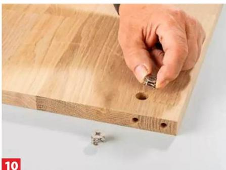
Setzen Sie die Exzenter des *Rastex 15*-Beschlags in die Löcher. Der Pfeil bzw. der offene Exzenter zeigt dabei nach oben.
