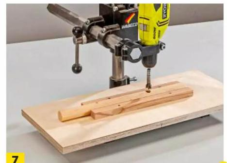
Der Bohrmittelpunkt des 16-mm-Bohrers liegt im Abstand von 115 mm zum geraden Rundstabskopf. Dort durchbohren.
