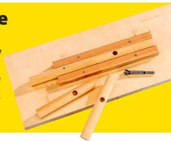
Sie brauchen Rundstäbe in den Durchmessern 15 und 27 mm. Längen Sie zunächst vier 15er Stangen auf eine Länge von 800 mm ab.
