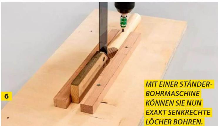
**MIT EINER STÄNDER-BOHRMASCHINE KÖNNEN SIE NUN EXAKT SENKRECHTE LÖCHER BOHREN.**
