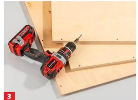
Die vier Wände werden stumpf zusammengesetzt und verschraubt. Markieren Sie dazu die Positionen der Schrauben ...
