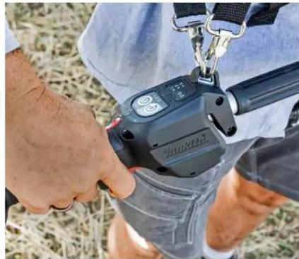
**+** **RÜCKWÄRTSGANG:** Ideal ist der Kurzzeit-Rückwärtsgang bei *Makita* – zum Lösen von Blockaden.
