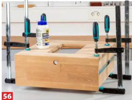
**56** Darauf leimen Sie anschließend die vorbereitete massive Platte. Die Auszüge ebenfalls montieren.
