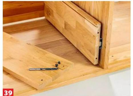
**39** Zeichnen Sie auch die exakte Nutposition auf die Innenseite. Dann bohren Sie die Gegenlöcher an den Markierungen.
