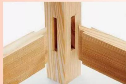
Bei einer Eckverbindung kann es je nach Holzquerschnitt vorkommen, dass die Zapfen gegeneinanderstoßen. Um dies zu vermeiden, werden die Zapfenköpfe auf Gehrung geschnitten. Prüfen Sie vor dem Verleimen, ob die Verbindung passt. Schlitz und Zapfen sollen sich mit leichtem Druck ineinanderschieben lassen. Erst dann den Leim auftragen und verpressen.
