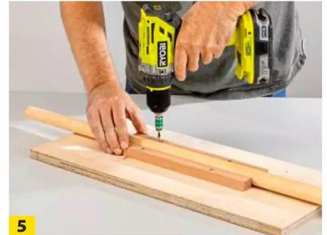
Legen Sie das 27-mm-Rundholz auf eine Holzplatte und schrauben Sie die Leisten rechts und links des Rundstabs fest.
