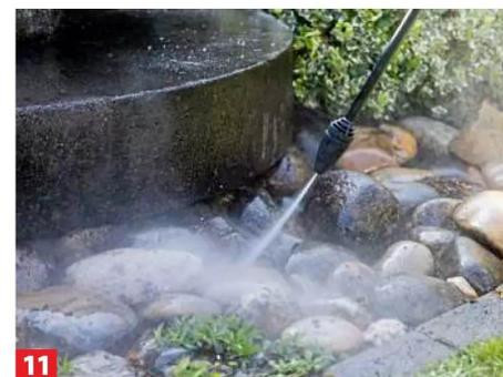
**11** ... Schmutz wie vermoosten Flächen setzt man den **Dreckfräser mit Rotordüse** und rotierendem Punktstrahl ein.
