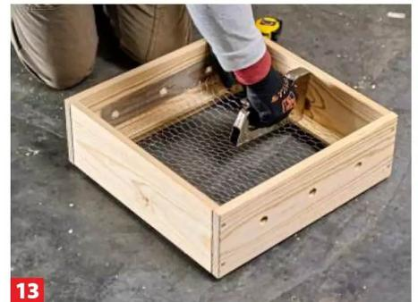
**13** Abmessen, mit einer Drahtschere zuschneiden, in die Box legen und ebenfalls festtackern.
