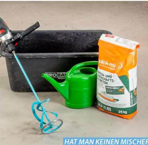
**HAT MAN KEINEN MISCHER ZUR HAND, GEHT DAS ANRÜHREN AUCH MIT DER BOHRMASCHINE UND DEM RÜHRQUIRL.**
