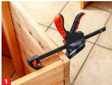
**1** Fixieren Sie die Bauteile mit Schraubzwingen aneinander. Das erleichtert das Verschrauben.
