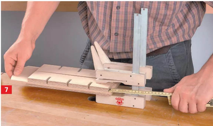
Boden, Deckel und Zwischenwände aufeinander ausrichten – exakt in der Position, in der sie später liegen!
