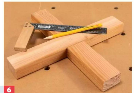
6 Stecken Sie die Bauteile zusammen und markieren Sie den Mittelpunkt der Überblattung.
