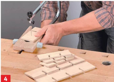
4 Die Überblattungen anzeichnen und mit der Laubsäge (oder einer Dekupiersäge) zuschneiden.
