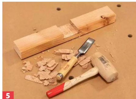
5 Die Lamellen können Sie nun mit einem Hammer herausbrechen, die Überblattung lässt sich mit einem Beitel glätten.
