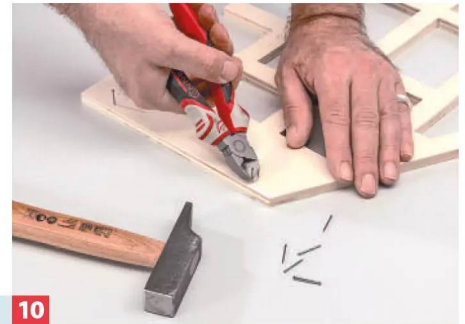
10 Schlagen Sie behutsam je zwei kleine Drahtstifte pro Seite in die Rückseite der Frontplatte und kneifen Sie die Nägelchen ab.
