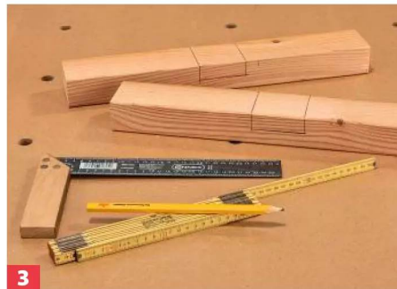
3 Auf beiden Stücken markieren Sie mittig die 70 mm breite und 22,5 mm tiefe Überblattung.
