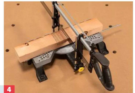
4 Sägen Sie die Hölzer dort lamellenförmig ein. Benutzen Sie hierzu am besten eine Gestell-Gehrungssäge mit Tiefenstopp!
