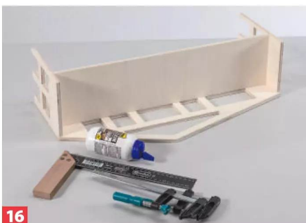
16 Zunächst leimen Sie die durchgehende mittlere Etage so ein, dass sie bündig mit den Sims der Fensterreihe liegt.
