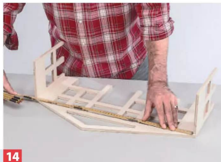
14 Sind beide Seiten verleimt, messen Sie die Breite der Zwischenböden aus. Insgesamt gibt es 3 unterschiedlich breite Böden, ...
