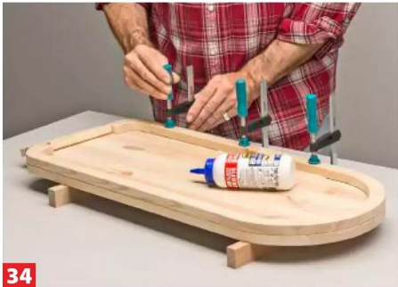
31 Wenn alles funktioniert, leimen Sie die Ecken mit der eingesetzten Klappe auf. Nicht zu viel Leim angeben!
