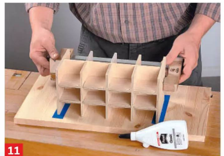
11 Nach dem Trocknen können Sie die vordere und hintere Bordwand aufleimen.
