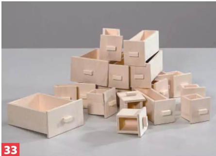
33 Ein kleiner, auf die Front geleimter Sperrholzabschnitt dient als Griff. Als letztes wird die große Giebelschublade gebaut.
