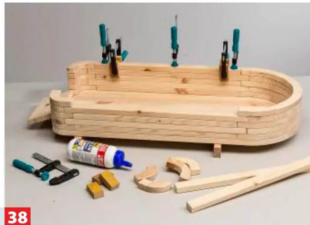
38 Alles weitere ist reine Fleißarbeit und wird bis einschließlich der sechsten Lage über der Bodenplatte nach gleichem Schema ...
