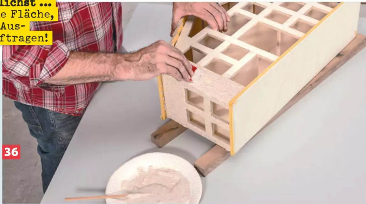
37 Das Klebeband möglichst zügig abziehen. Hier sehen Sie, wie der Holzleim bereits farblos (statt zuvor milchig) aufgetrocknet.
