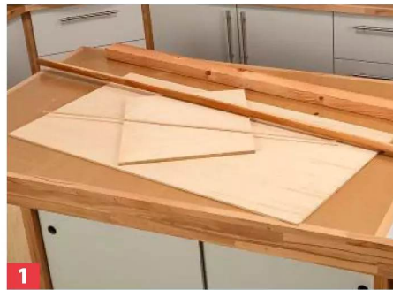
1 Der Baum besteht aus einem 28-mm-Kiefern-rundstab, 70-x-45-mm-Konstruktionsholz sowie 12 und 6,5 mm starkem Birke-Multiplex.
