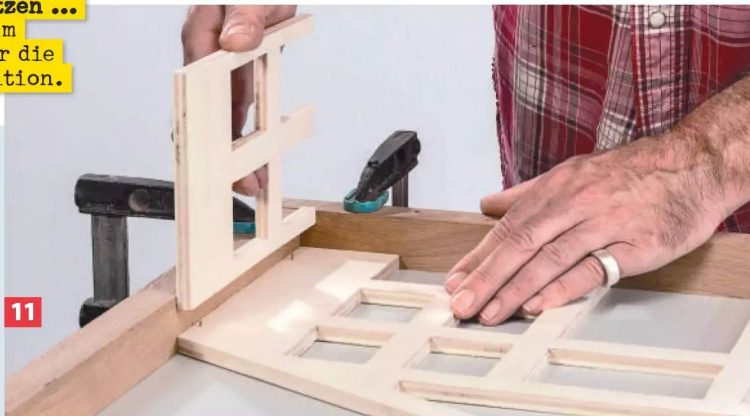
12 Leim an die Kante der Seitenwand geben und sie so gegen die Frontplatte setzen, dass die Nagelspitzen ihre Abdrücke finden.
