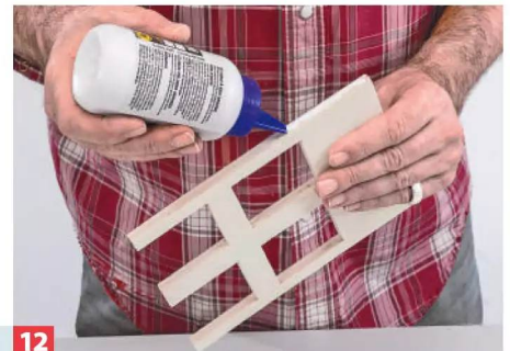
12 Leim an die Kante der Seitenwand geben und sie so gegen die Frontplatte setzen, dass die Nagelspitzen ihre Abdrücke finden.
