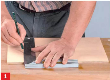
1 Zeichnen Sie zunächst die Bauteile der Laderaum-Teilung auf eine Sperrholzplatte.
