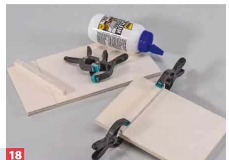
18 ... Sie die Abstände von der Wand bis zum Fensterrahmen. Leimen Sie in diesem Abstand Anschlagstreifen auf die Teilböden.
