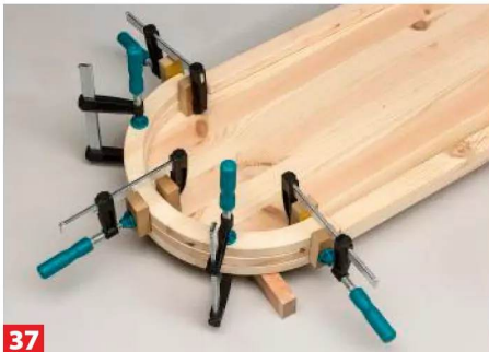
37 Das funktioniert genauso bei den Bögen am Bug. Denken Sie daran: immer abwechselnd lange und kurze Bauteile verleimen.
