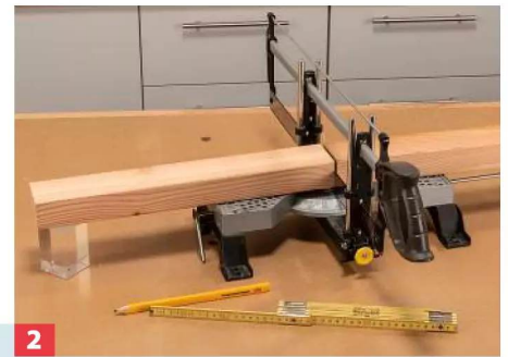
2 Schneiden Sie von dem Konstruktionsholz zwei Stücke von 450 mm Länge mit der Gestell-Gehrungssäge für das Fußkreuz ab.
