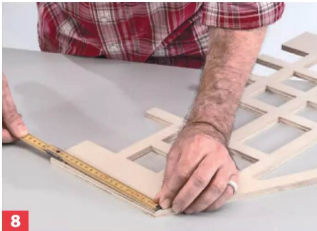
8 Messen Sie die Höhe der Giebel-Seiten aus und schneiden Sie die Seitenwände zu.
