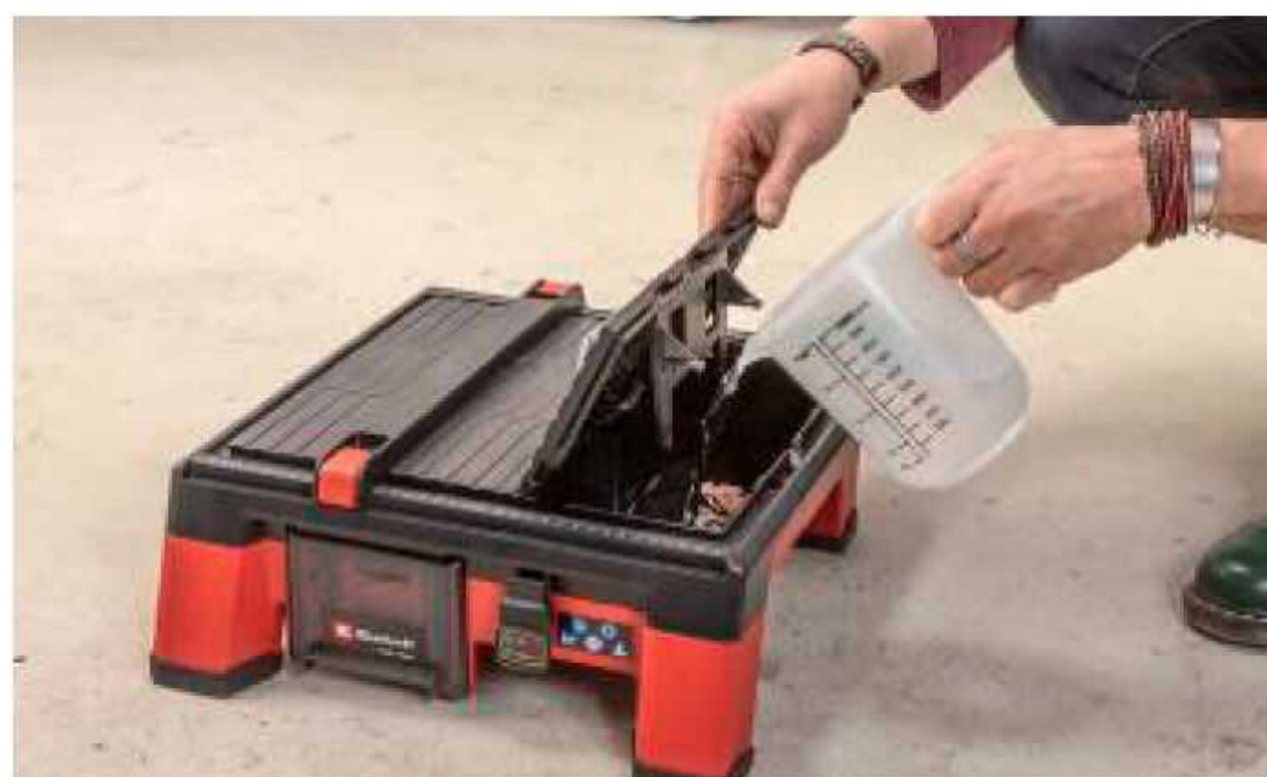
VORRAT: Das Wasser wird in eine Kammer unter dem Säge Tisch gefüllt.
