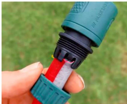
KLEMMT: Die Nasen an den Parkside -Kupplungen sitzen sehr eng.
