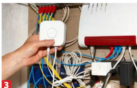
3 ... verbinden. Bei Bedarf einen Netzwerk-verteiler (Switch) am Router anschließen!
