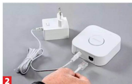
2 Zunächst das Netzteil und das Netzwerk-kabel anschließen und mit dem Router ...
