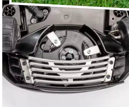
Ein zweites kleines Mähwerk an der Front des Geräts pflegt den Rasen randnah.
