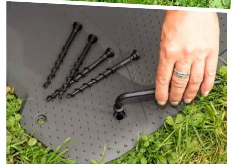
Die Basisstation wird wie üblich auf dem Untergrund verankert.
