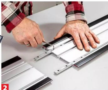
2 ... und Kleinmaterial. Die Schienen können (endlos) miteinander verbunden werden.
