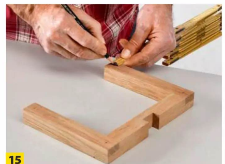
15 Anschließend zeichnen Sie die vier Positionen der Schnurlöcher exakt mittig (13 mm von vorn, 13 mm vom Rand) ein.
