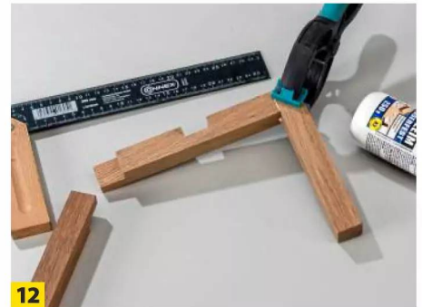
11 Die Gestelle werden nun verleimt. Geben Sie an alle Kontaktstellen der Überblattung Leim.
