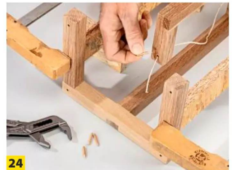
24 Stecken Sie den angespitzten Dübelstangen-Abschnitt von außen in das erste Loch mit der Paketschnur.
