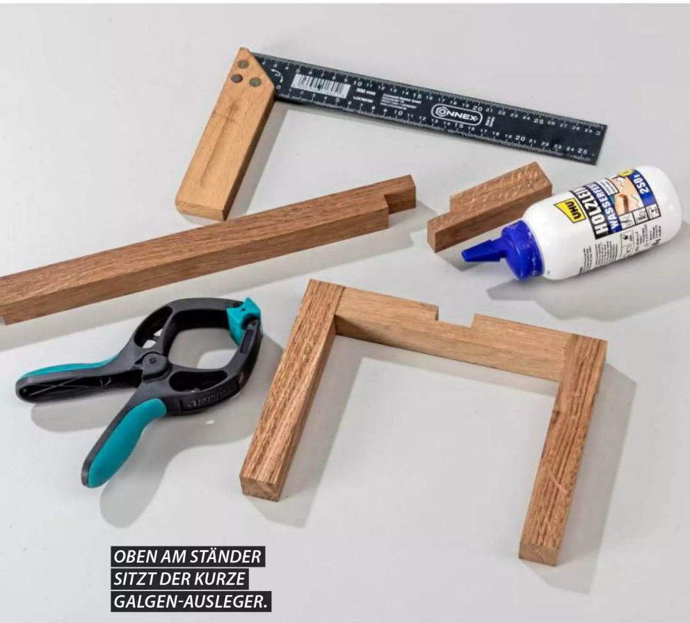
9 Die Basis (boden- und tischplattenseits) bildet ein „U“. Mittig darauf sitzt der Ständer, der ebenfalls als ...
