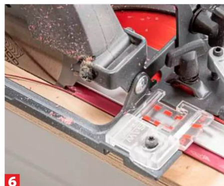
3 Der Schlitten wird mit der Lehre an einer geraden Holzkannte ausgerichtet. Daran ...
