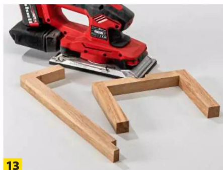
13 Zunächst werden die Hölzer geschliffen und die Kanten leicht gebrochen.
