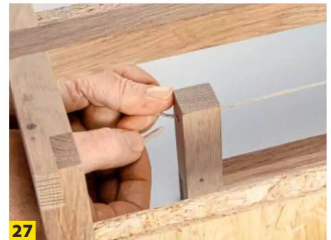
27 Das gleiche machen Sie auf der gegenüberliegenden Seite. Die Schnur dabei jedoch stramm spannen!
