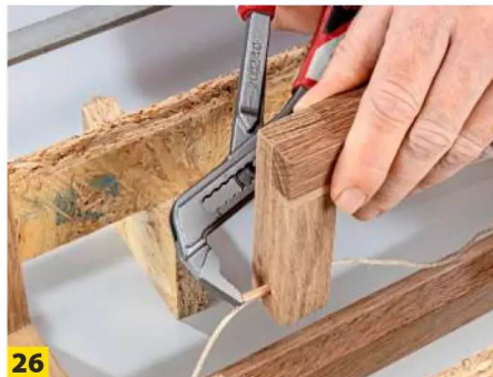
26 Setzen Sie die Zange auf dem Holzdübel und unter dem Loch an und drücken Sie ihn stramm hinein.
