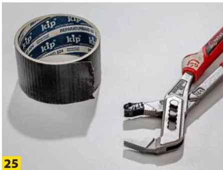
25 Tipp: Um Zangenabdrücke im Holz zu verhindern, kleben Sie die untere Backe der Wasserpumpenzange ab.
