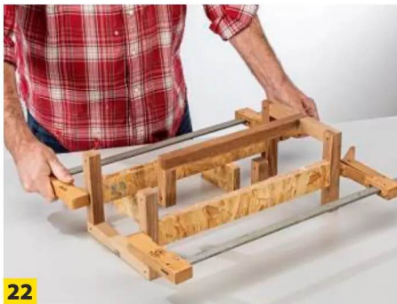
22 Zwei Distanzhölzer und Zwingen fixieren die Gestellteile im erforderlichen Abstand, die Bohrungen liegen alle exakt ...
