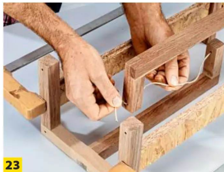
23 ... in einer Flucht. Fädeln Sie die stabile Paketschnur zunächst durch die mittleren Galgen-Löcher.
