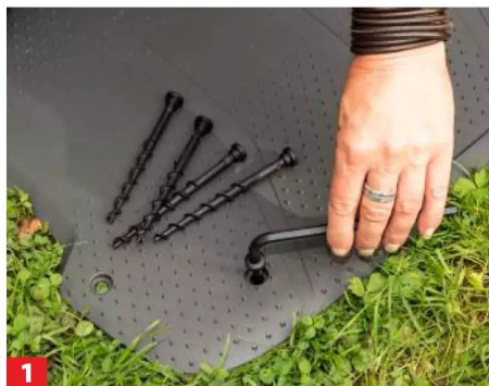
1 Die Basisstation wird mit Sichtverbindung zum Satellitenempfänger befestigt.
