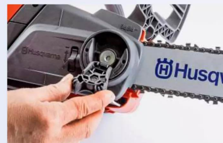
Die Kettenwartung erfolgt werkzeuglos – dennoch ist die Maschine flach gestaltet.
