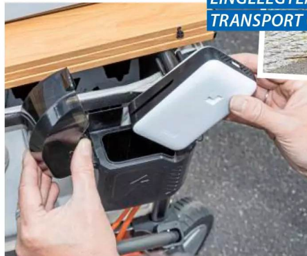
Ein flaches Fach an der Front des Wagens nimmt die Powerbank für den Antrieb auf.
