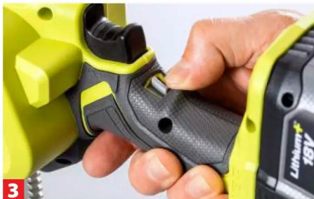
3 Zur Betätigung die Einschaltsperre unterhalb des Betriebsschalters lösen.
