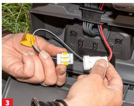
3 Stecker anschließen, Stromverbindung mit der Ladestation herstellen.
