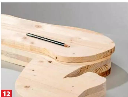
9 Die Schritte Aufdoppeln und Nacharbeiten wiederholen Sie nun mit der dritten Pferdeplatte, also der zweiten Außenseite.
