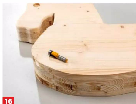
16 ... und die Überstände wie gehabt beidseitig bis zum Hals bündigfräsen.
