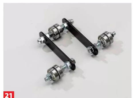
21 So sollten die Schwungmechaniken nach der Montage aussehen – Sie fertigen zwei Stück mit insgesamt zwölf Kugellagern.
