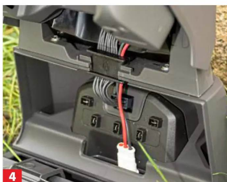
4 Die vorgesehenen Kontakte für die Suchschleife bleiben ungenutzt.
