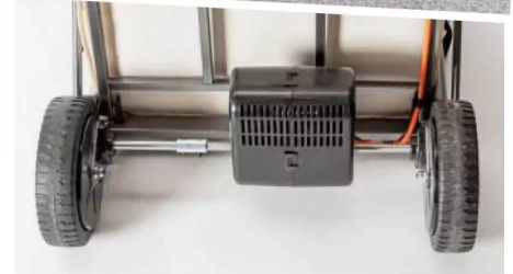
Der recht kraftvolle Motor sitzt unter dem Wagen an der Hinterachse.
