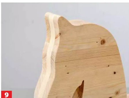
7 Beide Platten so übereinander legen, dass die Mittelplatte rundum etwas übersteht. Dann mit mehreren Zwingen verpressen.
