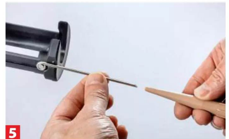
5 Am Kartuschenhalter ist ein Dorn integriert, um verklebte Düsen zu durchstoßen.
