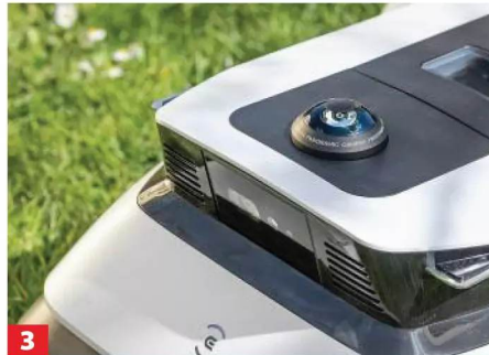
3 Kameras ergänzen teilweise die GPS-Orientierung – hier die Rundum-Videoerfassung bei Ecovacs .
