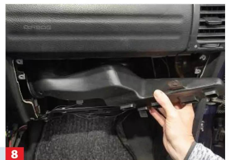
8 Nun ist noch ein Luftleitgehäuse im Weg – es wird einfach abgesteckt.
