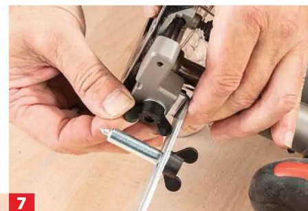
7 Die große Flügelmutter lässt sich beim Zirkel-Anschlag nur sehr schlecht festziehen.
