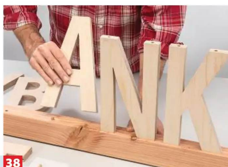
38 Mit Dübeln (hier 6 mm) können Sie die komplette Rückenlehne nun zusammenstecken.
