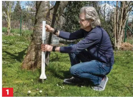
1 Beim Mähroboter von Ecovacs werden mehrere Leitbaken aufgestellt, die für die Nahorientierung des Geräts sorgen.
