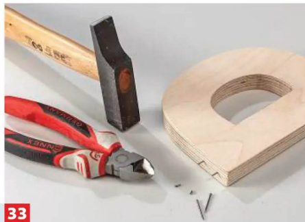
33 ... um alle Löcher zu übertragen, haben wir Drahtstifte eingeschlagen und abgekniffen. Wichtig: Auch bei einem „I“ mindestens ...
