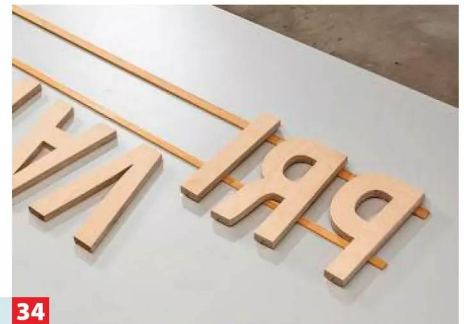
34 ... drei Dübel wegen der Verdrehsicherheit setzen! Jetzt richten Sie den Schriftzug auf zwei Leisten exakt spiegelverkehrt aus.
