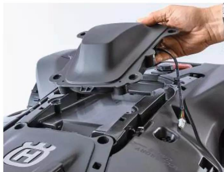
Erst mit einer nachgerüsteten GPS-Antenne kann der Husqvarna Epos -Roboter ohne Begrenzungsdraht navigieren.
