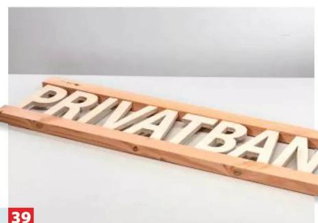
39 Verleimen bzw. verkleben Sie die Rückenlehne jedoch noch nicht! Die Einzelelemente lassen sich einfacher und sauberer streichen!
