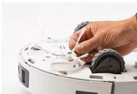
Rotierende Frontbürsten fördern den Staub aus Kanten und Ecken in den Saugbereich.
