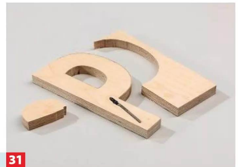
31 Mit einer Stichsäge und einem Kurvensägeblatt oder mit einer Dekupiersäge schneiden Sie sie dann sorgfältig aus.
