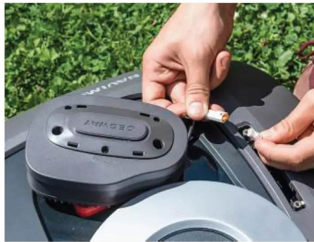
Das Segway -Gerät kann mit einer optionalen Kamera besser auf dem Rasen navigieren – sie wird auf dem Gehäuse montiert.
