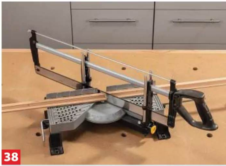
38 Schneiden Sie die Füllungsleisten auf Geh-rung zu.
