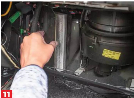
11 Nach Öffnen der Klappe sind die Lamellen des aufrecht sitzenden Filters sichtbar.
