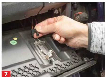
7 Vorsicht: Oft gibt es noch elektrische Verbindungen – wie hier zur Fachbeleuchtung. In diesem Fall den Stecker abziehen.
