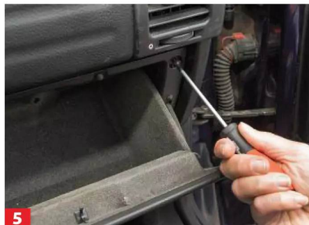
5 Weitere Schrauben befinden sich auf der Seite des Fachs – zum Lösen wird der Deckel geöffnet.
