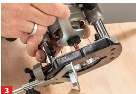
3 ... eingestellt. Das Spannfutter mit Spindel-arretierung ist gut erreichbar.
