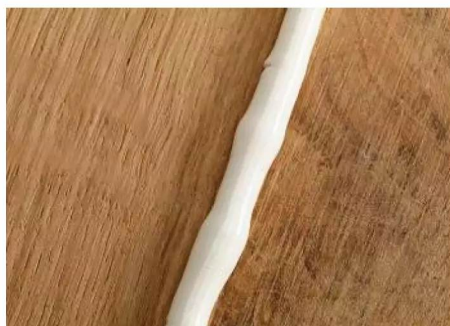
STREIFENFÖRMIG Klebstoffe trägt man zum Beispiel in gleichmäßigen rund 0,5 cm breiten Streifen mit 20 bis 30 cm Abstand auf.
