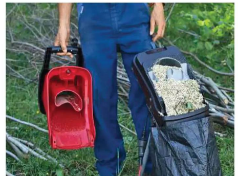
Verstopft: Bei Einhell kann sich das Material im Auswurf stauen.
