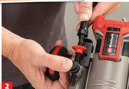
2 Die Frästiefe wird über einen Revolveranschlag und eine Schnell-/Feinjustierung ...
