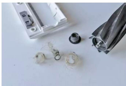
Beim Praxistest wickelten sich gelegentlich Haare um die Führungen der Gummirolle.
