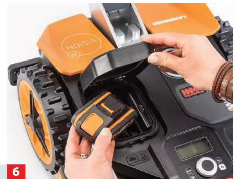
6 Alle Geräte beziehen den Strom aus Li-Ion-Akkus – bei Works leicht wechselbar..
