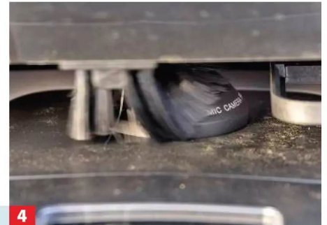
4 Die Kameras bei Ecovacs werden vor jedem Mäher-Start mit einem kleinen Besen mechanisch gereinigt.
