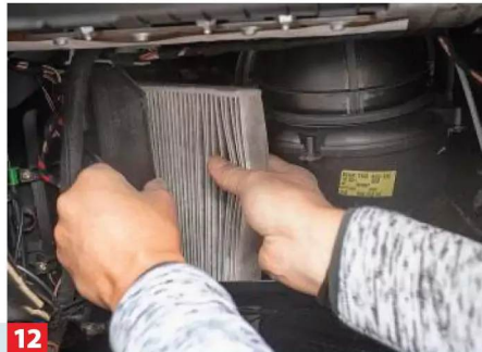
12 Filter vorsichtig herausziehen – achten Sie dabei auf eventuell störende Verbindungskabel und Bowdenzüge.
