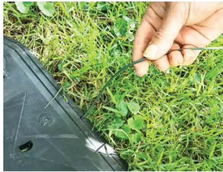
Der Einhell -Roboter findet seine Ladestation mit einem wenige Meter langen Suchdraht, der bei der Installation verlegt wird.
