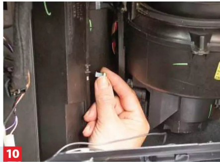
10 Kleine Clips sichern den Deckel – mit einem Schraubendreher vorsichtig öffnen.
