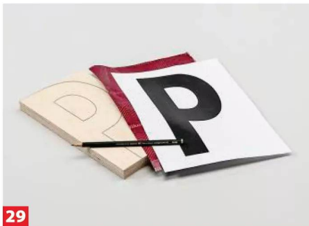
29 Die Buchstaben für den Schriftzug „Privatbank“ befinden sich als Schablone auf dem Bauplan, bei einem anderen Text ...
