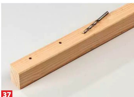
37 Ziehen Sie die Drahtstifte heraus. Dann bohren Sie die Dübellöcher in die Buchstaben und in beide Lehnriegel.
