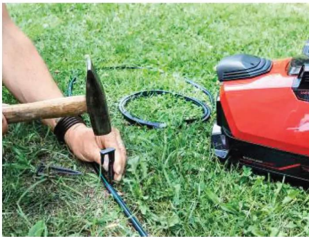
Unklare Grenzbereiche werden bei Einhell mit einem Magnetstreifen für den Roboter „sichtbar“ gemacht.
