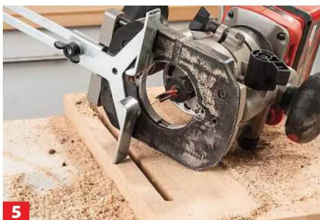
5 Der Parallelanschlag ist einfach montiert und eingestellt.
