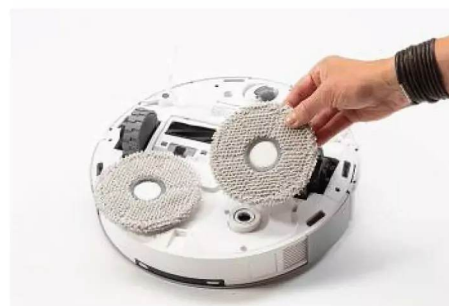
Die beiden runden Frottee-Mopps für die Wischfunktion sind werkzeuglos wechselbar.
