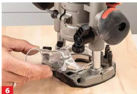
6 Mit Absaughaube ist – wie zu erwarten – die Fräsermontage schwieriger.
