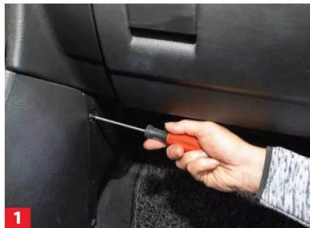
1 Um das Handschuhfach demontieren zu können, muss hier zunächst eine untere Blende abgebaut werden
