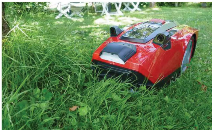
Erst mit einer nachgerüsteten GPS-Antenne kann der Husqvarna Epos -Roboter ohne Begrenzungsdraht navigieren.
