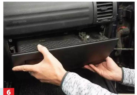
6 Sind alle Schrauben gelöst, wird das Handschuhfach nach hinten herausgezogen.
