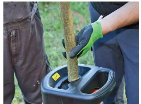
Eng: Bei Atika limitiert der Einwurfkanal die Aststärke.
