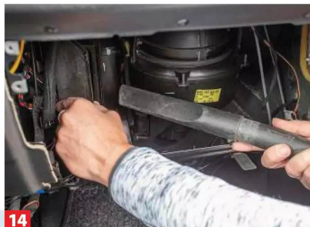
14 Vor dem Einsetzen des neuen Lamellenfilters den Filterkasten und den Wärmetauscher mit einem Sauger reinigen.
