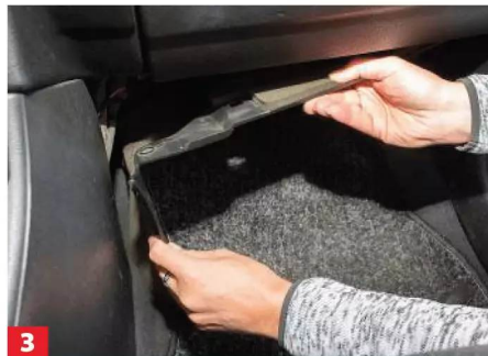
3 Danach kann die Blende zwischen Handschuhfach und Fußraum nach unten abgenommen werden.
