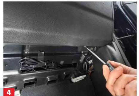
4 Unter der Verkleidung kommen Befestigungsschrauben für das Handschuhfach zum Vorschein.
