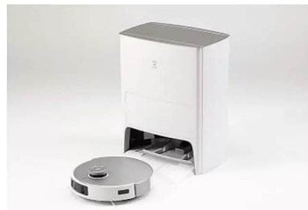
Der Roboter sucht die Station immer wieder auf, um den Staubbehälter zu leeren.
