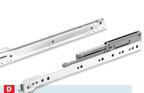
D Das Dämpfungselement mit Selbsteinzug sitzt dabei auf einer Schiene. Dennoch ist der Schubkasten werkzeuglos aushängbar.
