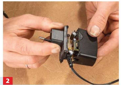
2 Gehäuse vorsichtig öffnen, um eventuell freiliegende verbindende Leitungen nicht zu beschädigen.
