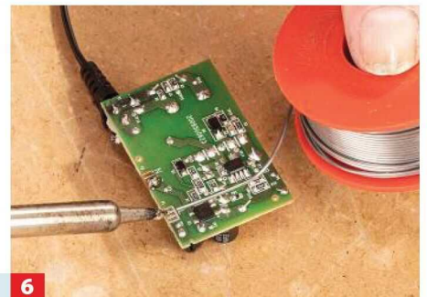
6 Falls die Zuleitung nicht angelötet war, die Kontaktfahnen zunächst mit Radiolot verzinne.
