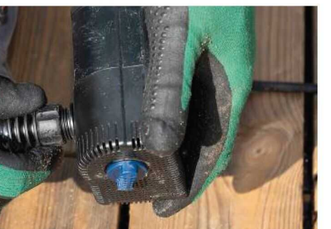
23 ... herausgeführt werden. Befestigen Sie das Gegenstück am Verbinders samt Schlauch.
