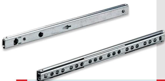
B ... ist er für Schubkästen von 155 bis 600 mm Tiefe. Der Beschlag liegt in einer 17-mm-Nut und trägt bis zu 10 kg.
