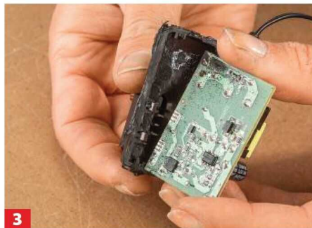
3 Enthaltene Elektronik-Platine entnehmen. Hier war die Netzstecker-Verbindung nur in Klemmen gesteckt.
