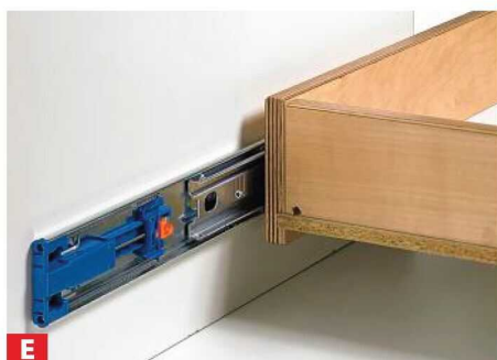
E Der KA 4532-Vollauszug mit hinten sitzender Dämpfung, dem Silent-System, schafft 50 000 Zyklen. Die Schienen sind nach ...
