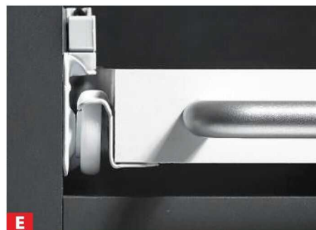
E Hier ist die aufliegende Montage gut erkennbar. Eine Schiene wird im Korpus, die andere unter der Zarge verschraubt.
