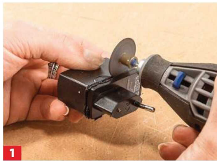
1 Trennen Sie das alte Gehäuse auf – am besten an einer erkennbaren Verbindungsfuge. Mit der Trennscheibe nicht eintauchen.
