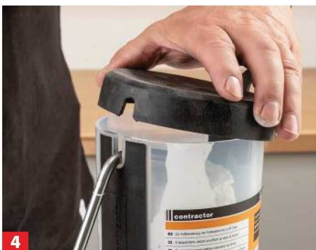
4 Der Bügel liegt dabei in der Aussparung des Köchers. Dann den Deckel fest aufdrücken.
