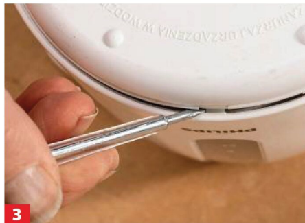
3 Danach konnten wir die Grundplatte aus den Führungen hebeln. Vorsicht, falls hier elektrische Verbindungen verlaufen!
