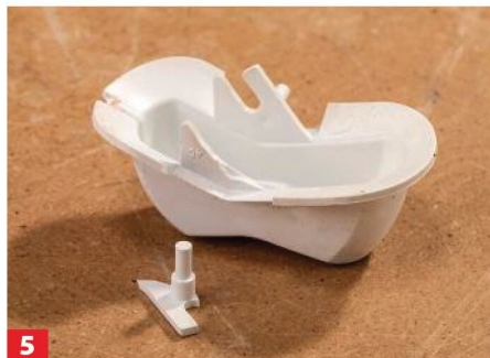
5 Problem gefunden: Die Kulisse der Schalterabdeckung ist auf einer Seite abgebrochen.
