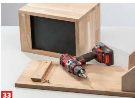
33 Nun schrauben Sie die Aufhängeleiste fest, die Sie schon in einem früheren Arbeitsschritt zugeschnitten haben (siehe Bild 18).
