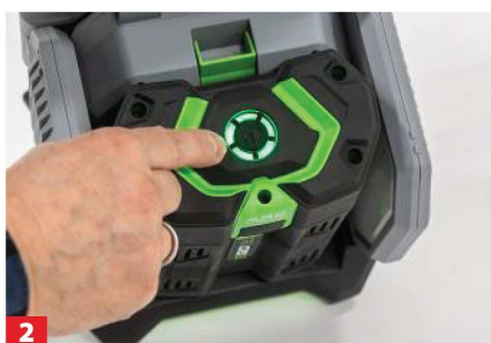
2 Der 56-V-/5-Ah-Akku zeigt auf Knopfdruck den Ladezustand an.
