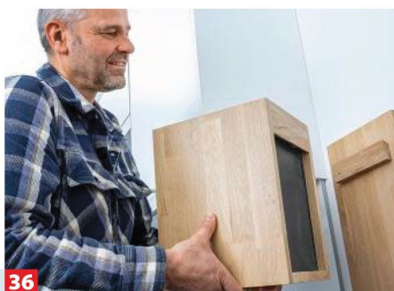
34 Auch der Halter sollte geschliffen und klar lackiert werden, um Flecken im Holz zu verhindern.
