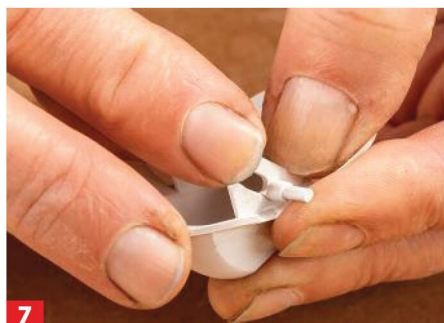
7 Beim Sekundenkleber kommt es dann auf die passgenaue Verbindung an. Ein langes Zusammenpressen ist nicht nötig.
