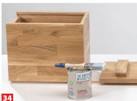
34 Auch der Halter sollte geschliffen und klar lackiert werden, um Flecken im Holz zu verhindern.
