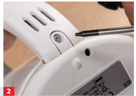
2 Zusätzlich haben wir die Verschraubung am Griff gelöst, um die Grundplatte des Gehäuses abnehmen zu können.
