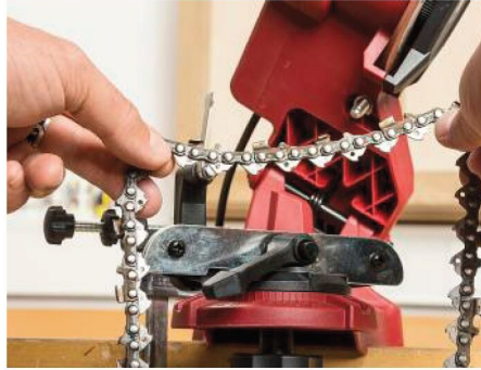
Praktisch: Ein Kettenschärfgerät mit Akku funktioniert auch, wenn es im Wald gebraucht wird.
