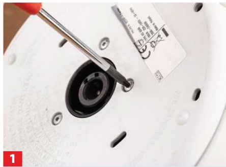
1 Um den Defekt zu ergründen, muss man das Gerät zunächst öffnen. In unserem Fall war die Grundplatte lösbar.
