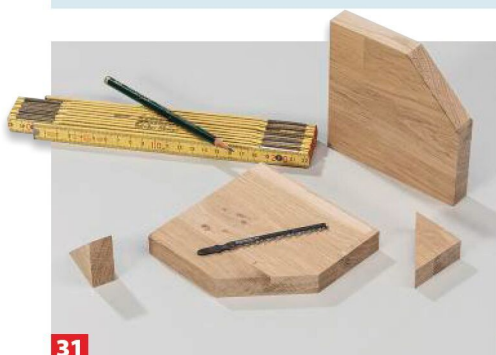
31 Jetzt schneiden Sie die Verstärkungsecken aus Leimholz zu. Sie stützen die Rückwand gegen die Bodenplatte ab.
