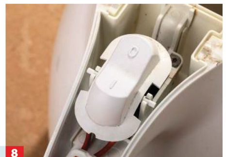
8 Passt: Der Schalter kann wieder einrasten, die Klebestelle ist stabil genug.
