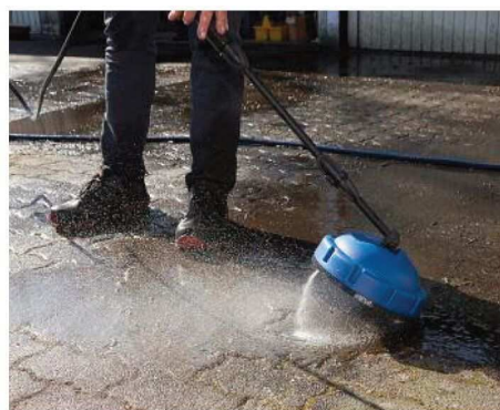
WACKELIG: Bei Scheppach klappt der Flächenreiniger unvermittelt hoch.
