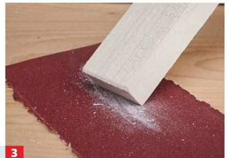
**3** Schleifen und entgraten Sie die Kopfflächen mit Schleifpapier.
