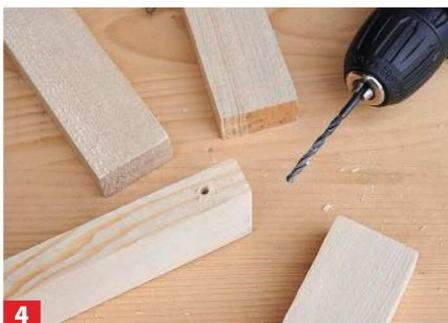
**4** Bohren Sie Schraubenlöcher durch die Schmalseiten der vier 130 mm langen Rahmehölzer und senken Sie sie. Die Hölzer ...
