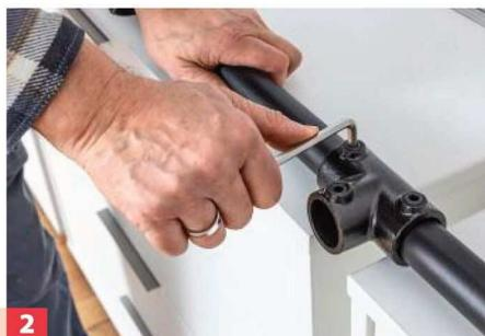
**2** Die Rohre können Sie sich auf Maß zuschneiden lassen und mit Verbindern montieren.
