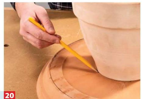
**20** Das Anzeichnen des Umrisses bietet Ihnen beim späteren Zusammensetzen eine kleine, aber nützliche Montagehilfe.
