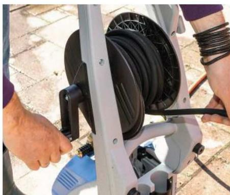
**ORDNUNG:** Eine Trommel für den Hochdruckschlauch hilft bei der Unterbringung.
