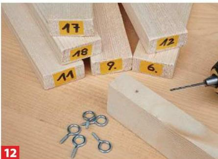
**12** Nummerieren Sie die Latten (wie auf der Schablone) entsprechend der Längenverteilung. So können Sie leicht die richtige ...
