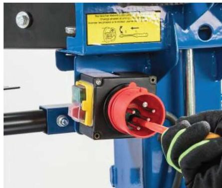
**DREHUNG:** Die Phasenlage ist bei Bedarf unkompliziert anzupassen.
