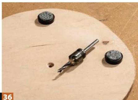
**36** Etwa in Plattenmitte für die zentrale Schraube ein 4-mm-Loch bohren und senken
