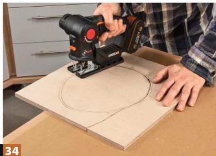
**34** Die Platte selbst sollten Sie rundum etwa zwei Zentimeter kleiner zuschneiden, damit sie später zurückspringt.
