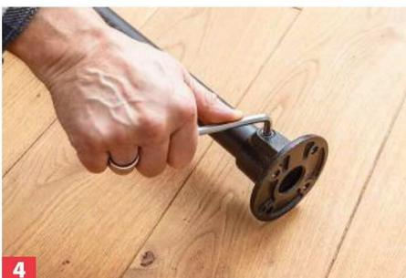
**4** Mit diesen Fittings werden auch Standrohre zum Boden hin abgestützt.
