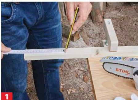
**1** Spannen Sie die Dachlatten am Werkstisch fest und zeichnen Sie die Längen der Abschnitte ein.
