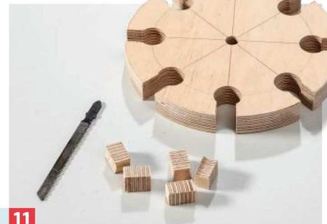
**11** ... Durchmesser rundum die Löcher für die Werkzeugaufnahmen. Dann den Kreis zu- und die Löcher bis zum Rand aufschneiden.
