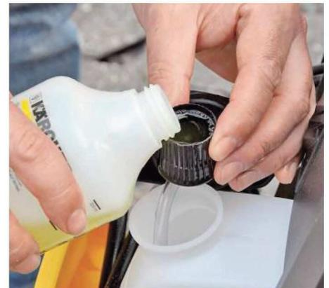
**INTEGRIERT:** Bei größeren Geräten wird Reiniger aus einem eingebauten Tank zugeführt.
