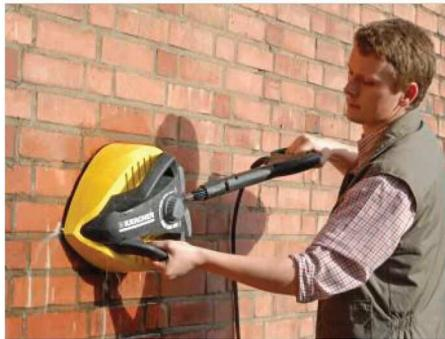
**FLÄCHENREINIGER:** Der Vorsatz ist auch an vertikalen Flächen gut einsetzbar.
