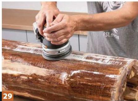
**29** Anschließend haben wir den Stamm einmal komplett rundum geschliffen, um die Harzfalten zu entfernen, die von der Folie ...
