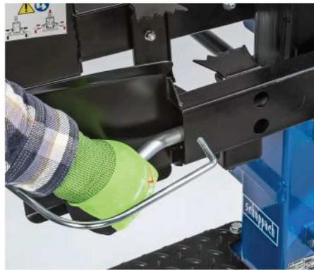
**SICHER:** Zweihandbedienung und Schutzbügel sichern die bedienende Person.
