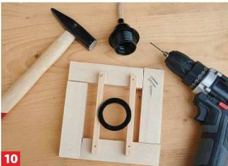
**10** Auf der Unterseite des Rahmens bringen Sie die Halteleisten für die Fassung an. Sie können geschraubt oder genagelt werden.
