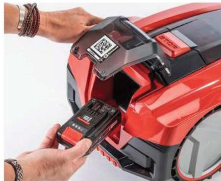
**WECHSEL:** Der *Einhell*-Roboter arbeitet mit einem Werkzeugakku des Herstellers.
