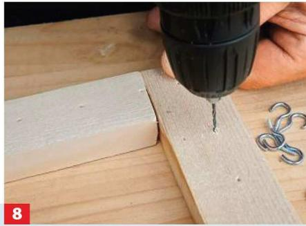
**8** Mit einem 1 bis 2 mm dicken Bohrer (je nach Schraubhakengröße) bohren Sie die markierten Löcher nun vor.
