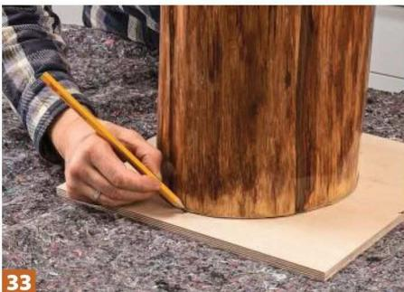
**33** Der Stamm ist fertig, nun geht es an die Beleuchtung: Zeichnen Sie auf eine Multiplex-Platte den Umriss der Stamm-Standfläche.
