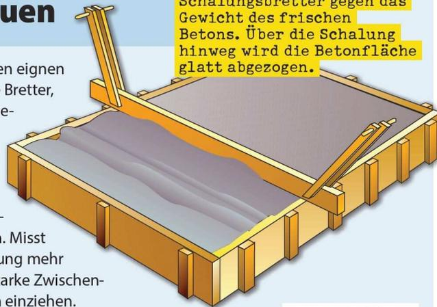
Pflöcke sichern die Schalungsbretter gegen das Gewicht des frischen Betons. Über die Schalung hinweg wird die Betonfläche glatt abgezogen.
