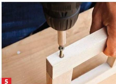
**5** ... versetzt zu einem geschlossenen Kranz zusammensetzen und verschrauben. So entsteht ein quadratischer Lampenrahmen.
