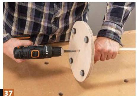
**37** Schrauben Sie dort eine 20-x-20-mm-Quadratleiste fest. Die Leiste ist etwa 30 mm kürzer als der Hohlraum tief. Vorbohren!
