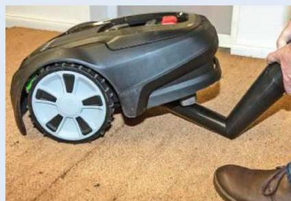
**UN SICHER:** Zwei Roboter bestanden den Norm-Test „kniendes Kind“ nicht.
