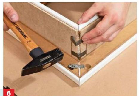
**6** Die Zargenteile mit Stahlklammern verbinden, die man mit einem Hammer einschlägt.
