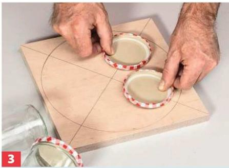
**3** Die Deckel der Gläser werden später darauf montiert. Sie dürfen nicht zu dicht beieinander liegen, um sich gut greifen zu lassen.
