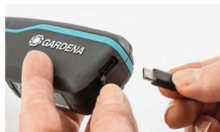
**BEQUEM:** Geladen wird per USB-C-Verbindung, das dauert rund 100 Minuten.
