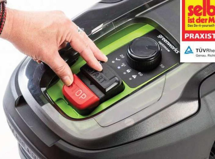
**AN – AUS:** Mehr kann beim Roboter von Greenworks nicht am Bedienpanel vorgewählt werden. Die App ist zwingend erforderlich.
