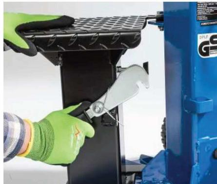
**KLAPPBAR:** Der Spalttisch kann für Meterholz seitlich ausgeschwenkt werden.
