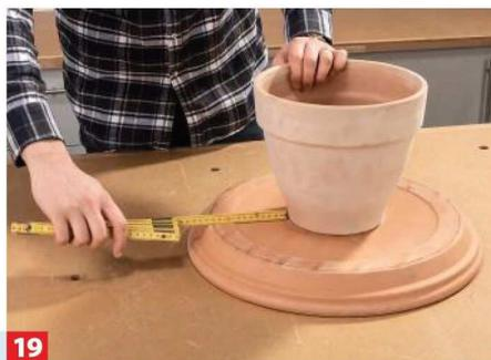
**19** Nachdem der Mörtel ausgehärtet ist, bereiten wir die Unterkonstruktion vor. Messen Sie dazu die Position des Topfes aus.
