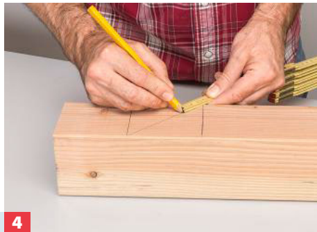
1 Die Douglasienbalken lassen sich mit einer größeren Kapp- und Gehrungssäge auf Maß schneiden. Beachten Sie die verschiedenen ...
