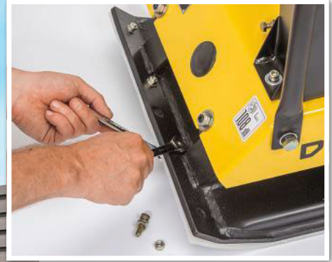
MONTAGE: Eine Kunststoffmatte ist auf Pflaster notwendig.
