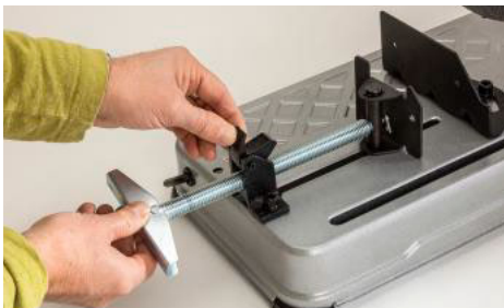
CLEVER: Ein klappbarer Riegel ermöglicht die schnelle Anpassung des Anschlags.
