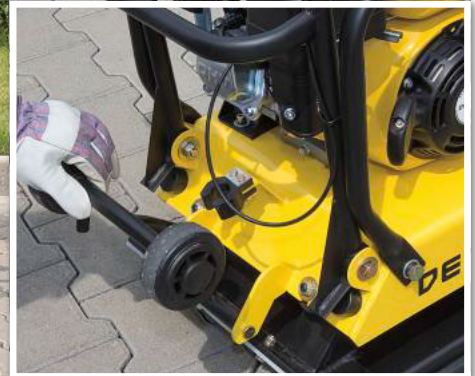
ROLLEN: Mit dem klappbaren Fahrwerk ist ein Transport möglich.
