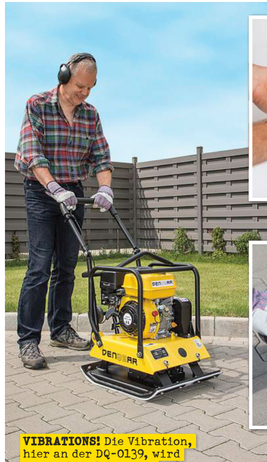
MONTAGE: Eine Kunststoffmatte ist auf Pflaster notwendig.
