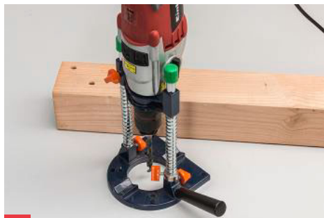
6 Verwenden Sie einen Bohrständler! An den Markierungen des unteren Balkens setzen Sie den Bohrer erneut an und durchbohren ihn.
