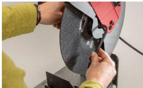
RIEGEL: Für den Scheibenwechsel wird die Antriebsachse werkzeuglos blockiert.
