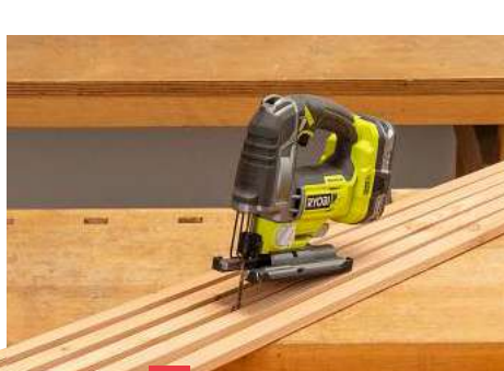
19 Schneiden Sie aus einem weiteren Glattkantbrett Anschlagleisten zu.
