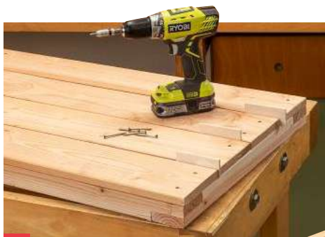
18 Anschließend die Bretter mit Abstand auf ein Deckel-Element schrauben.
