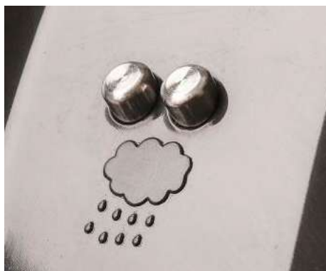
REGENSENSOR: Bei einigen Geräten kann man die Arbeit bei Regen deaktivieren.
