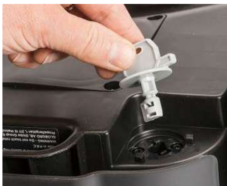
SCHLÜSSEL: Nur einige Geräte sind mit einem solchen Schlüssel zusätzlich gesichert.
