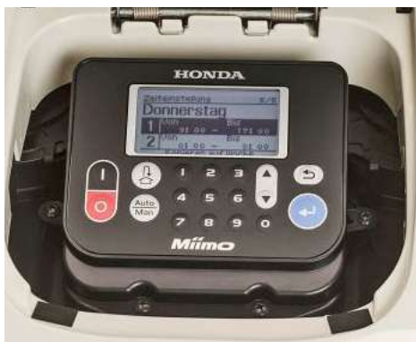
BEQUEM: Ein Klartext-Display und eine Zifferntastatur erleichtern die Bedienung.
