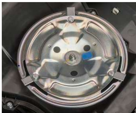
KLINGENSYSTEM: Die kleinen Klingen verschleiben schneller, sind aber preiswert.
