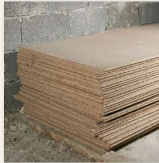
Die Spanverlegeplatten sind 205 x 62,5 cm groß.
