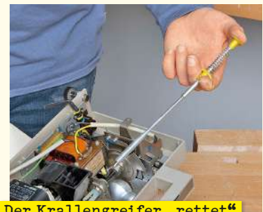
Der Krallengreifer „rettet“ Kleinteile, die in enge Bereiche hinabgefallen sind.
