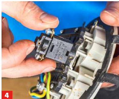
4 Die Sicherung ist nur in die Kunststoffkulissee des Steckdosenverteilers eingeschoben und wird einfach abgezogen.
