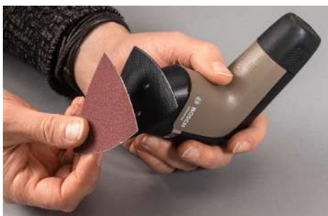
KLETT: Wie üblich werden die Schleifblätter einfach auf die Schleiffläche gelegt.
