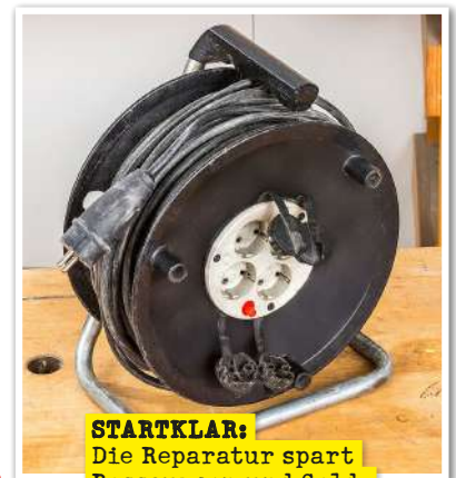
8 Vor der erneuten Montage haben wir die Steckdosen der Verteilung auf Funktion geprüft.
