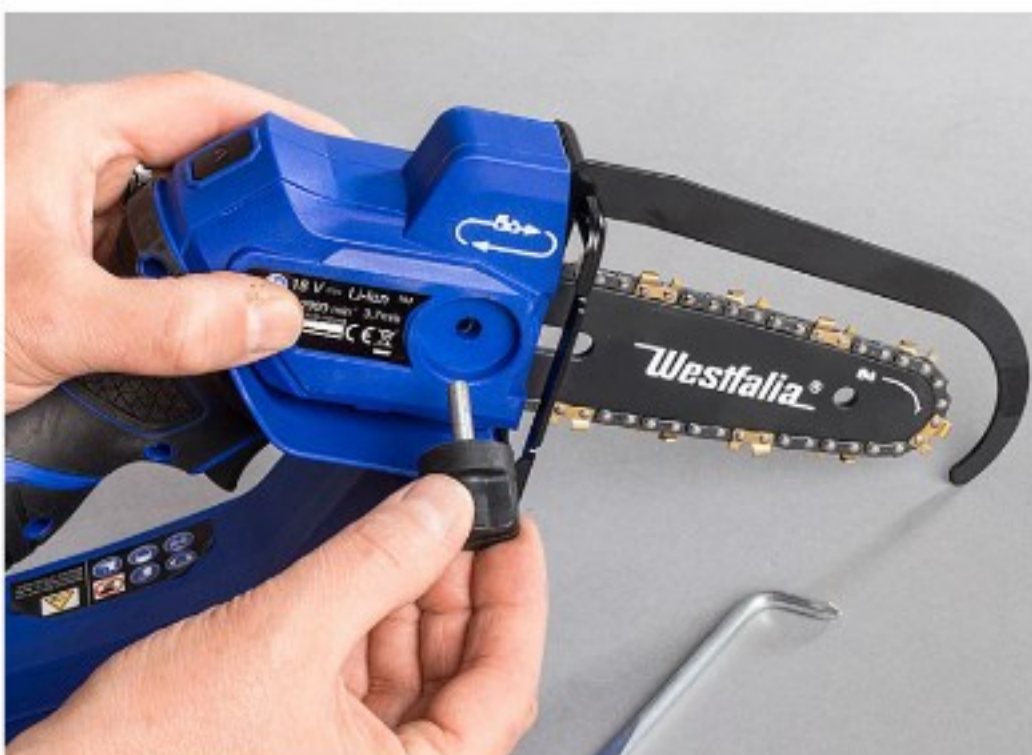
EINFACH: Der Antrieb der Kette ist nach Lösen einer Schraube zugänglich.
