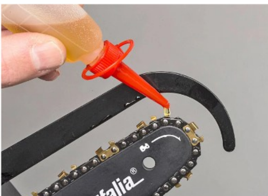
SIMPEL: Das Schneidöl wird aufgetropft – ausgelegt auf gelegentliche Nutzung.
