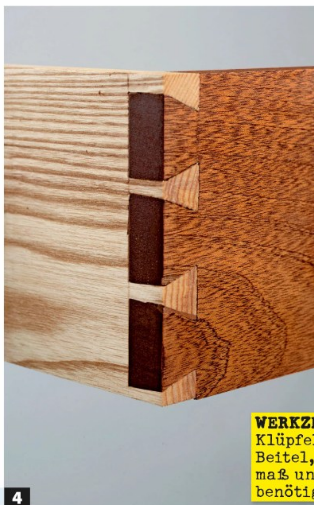
2 Diese als Auf- oder Einzinker bezeichnete Holzverbindung schafft sehr belastbare Traversen oder Queraussteifungen.
