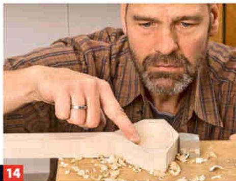
**14** Durch genaues Fluchten und Fühlen mit dem Finger ermitteln Sie die Stellen, die ggf. noch nachbearbeitet werden müssen.
