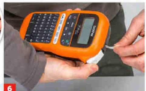
**6** ... mit dem Trennschalter abgeschnitten. Später kann die Kassette einfach ohne Fädeln ein- und ausgesetzt werden.
