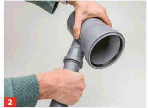
**2** Stecken Sie das Rohr tief und fest bis zum Anschlag hinein. Hier gut zu sehen: Die schwarzen Lippendichtungen.
