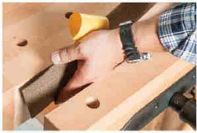
**AMBOSS** heißt dieser Kanten-schutz, der in zwei Tischlöchern auf der Bankplatte soliden Halt findet. Auf dieser Grundlage kann man robuste Arbeiten mit Metall ausführen.
