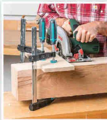
Spannwerkzeuge können mehr als pressen: Mit ihnen können Sie auch zu schonende Oberflächen mit Zulagen sicher schützen oder – wie hier – ein Brett als Führungshilfe für ein Elektrowerkzeug aufspannen. Ideal ist es daher, Federzwingen und einige Schnellspannzwingen direkt am Arbeitsplatz bereitzuhalten. Gurte machen sich darüber hinaus auch bei Transportaufgaben nützlich – etwa als Tragehilfe an großen Gegenständen oder als Fixierung beim Transport im und auf dem Auto oder Anhänger.
