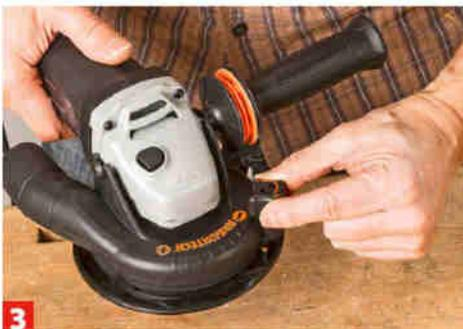
**3** Durch ein Stellrad kann die Sohle der Haube angehoben oder abgesenkt werden. Auch der Anschluss eines Staubsaugers ist möglich.
