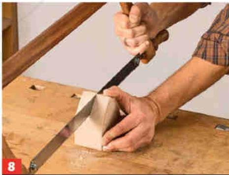
**8** Aus einem mach zwei: Teilen sie nun den Rohling der Länge nach auf.
