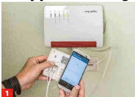
**1** Bei der Installation sollte die Verbindung zwischen Gateway und App direkt verifiziert werden – hier per QR-Scan.
