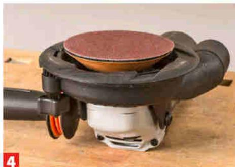
**4** Die Haube kann für den Flächenabtrag in Verbindung mit dem Schleifteller oder der Turbo Plane verwendet werden.
