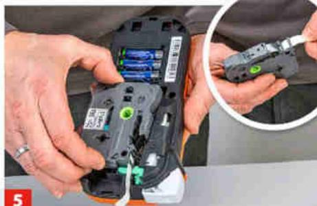
**5** Die Kassette wird oben eingesetzt – dabei wird der Bandstreifen nach oben aus dem Gerät geführt und vor der ersten Nutzung ...
