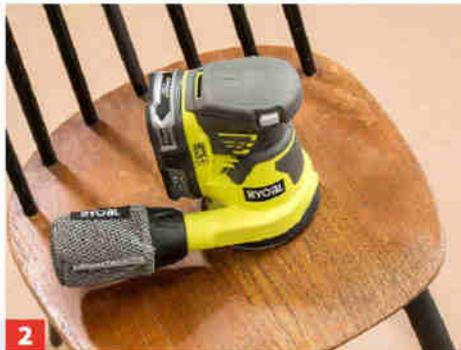
**2** ... Schleifschwamm oder Schleifvlies von Hand. Die Sitzfläche können Sie auch mit einem Exzentrerschleifer bearbeiten.
