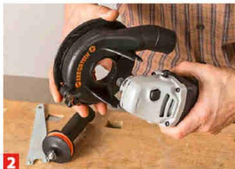
**2** Die Standard-Metallhaube lässt sich einfach gegen die Staubfang- oder – hier im Bild – Nivellierhaube austauschen.
