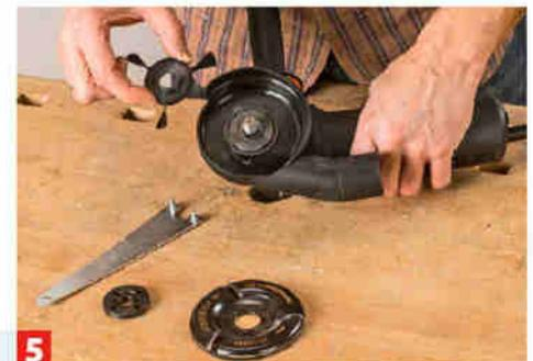
**5** Nicht überzeugen konnte die Kombination Absaughaube, Absaugschlauch, Ventilator und Turbo Plane. Der Ventilator verschleißt!
