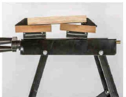
**- KEIN HALTEN:** Hier wird die Backe beim Festziehen stark angehoben.
