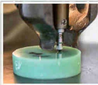
Bei der Prüfung wird mit einer Diamantpyramide eine definierte Kraft aufgebracht.
