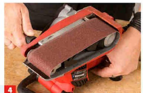
4 Nachdem das Band gespannt ist, Maschine mit voller Drehzahl laufen lassen und die seitliche Führung per Stellrad justieren.
