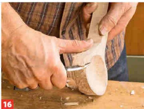
**16** ... dies auch mit dem Schnitzmesser bewerkstelligen, allerdings sind die Schnitzarbeiten quer zur Faser etwas schwierig.
