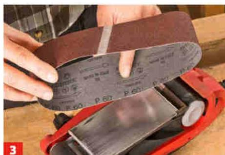
3 Achten Sie beim Einfädeln des neuen Schleifbands auf die Laufrichtung – sie ist im Bandinneren mit einem Pfeil markiert.
