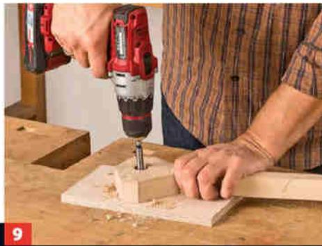
**9** In ein Bauteil schneiden Sie dann mit dem 20-mm-Forstnerbohrer an der angezeichneten Stelle das Loch.
