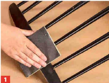
**1** Schleifen Sie die Oberflächen gründlich an. Bei den runden und gewölbten Bauteilen geht dies am besten mit einem ...
