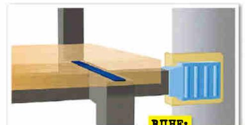
**RUHE:** Spezielle Wandanker sorgen für Entkopplung und gedämpfte Auflage.
