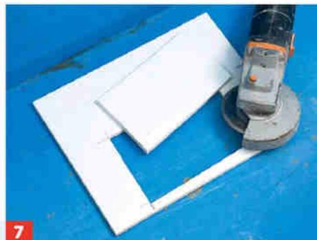
**7** Entweder Löcher bohren und mit Papageienzange „freiknabbern“ oder den Zuschnitt mit dem Winkelschleifer vornehmen.
