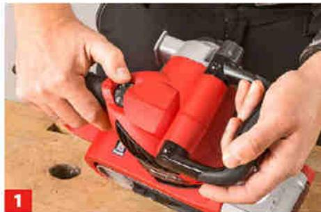
1 Holz wird mit voller Drehzahl geschliffen, doch für andere Werkstoffe ist eine mögliche Drehzahlvorwahl sinnvoll.
