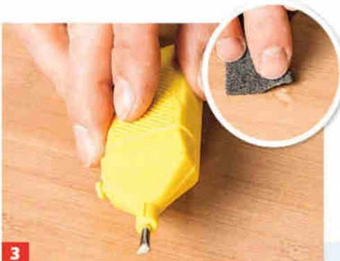
3 Überstände mit dem geriffelten Rücken des Schmelzers abstoßen. Je nach Oberfläche weitere Farbtöne darüber auftragen, ...
