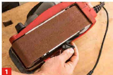
1 Mit einem im Inneren des Bandlaufs angeordneten seitlichen Hebel wird zunächst das Band entspannt.
