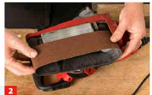
2 Es kann dann aus der offenen Seite des Bandlaufs aus der Maschine ausgefädelt werden.
