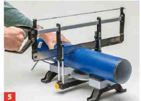
**5** Beim Rohrzuschnitt auf gerade Schnitte achten. Gut gelingt das mit einer Gehrungssäge oder mindestens mit einer Gehrungslade.
