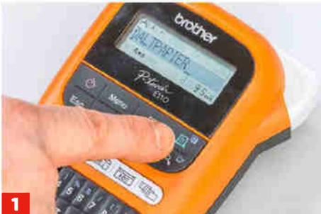
**1** Über die Tastatur wird der gewünschte Text ganz einfach eingetippt – auch mehrzeilig. Auf dem Display ist eine Kontrolle möglich.
