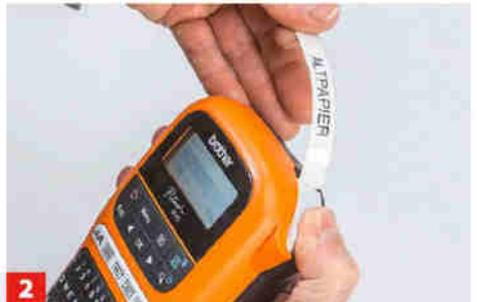
**2** Auf Tastendruck wird der Wunschtext auf das Band gedruckt und ausgegeben. Die Trenntaste schneidet das Band ab.
