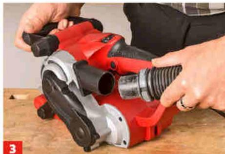
3 Bei Arbeiten in geschlossenen Räumen sollten Sie unbedingt einen Werkstattsauger oder eine Absauganlage anschließen.
