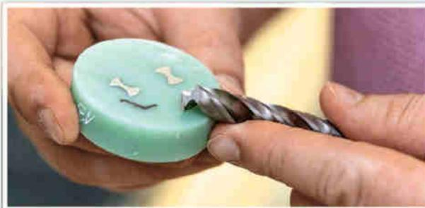
Zunächst wird die Bohrspitze abgesägt und dann eine Scheibe der Wendel in Kunststoff eingebettet.
