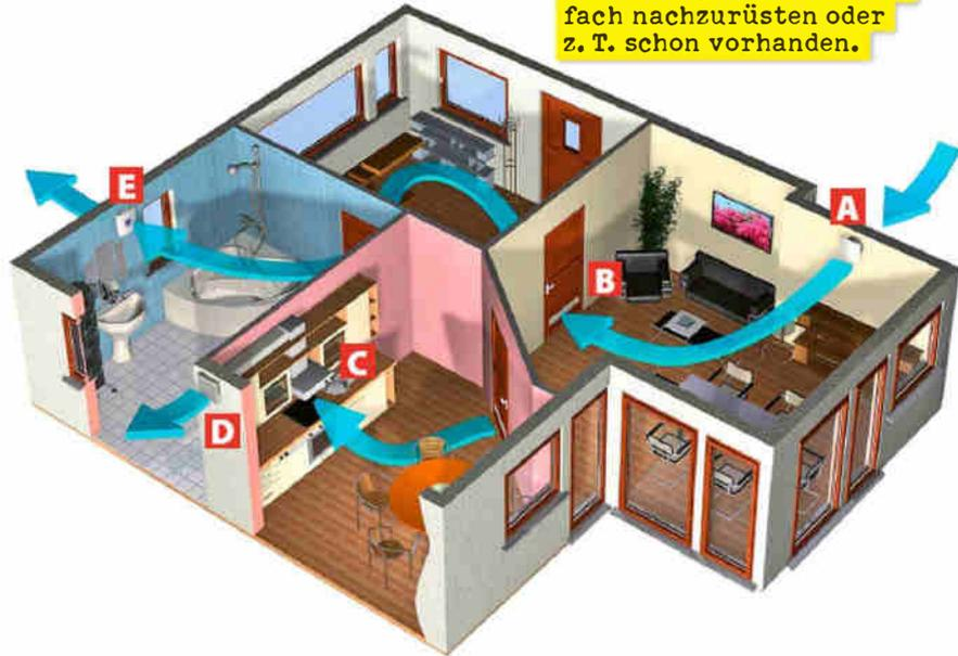
**DEZENTRAL GEREGLT** **A** Durch Zuluftkanäle, am besten mit Pollenfilter und Isolierschluss, ggf. auch mit Wärmetauscher, gelangt frische Luft in den Wohn- und Schlafbereich. **B** Durch Lüftungsgitter in Türen strömt die frische Luft in andere Räume. **C** Über die Dunstabzugshaube und **D** deren Abluftkanal sowie über **E** Ventilatoren wird die verbrauchte Luft aus dem Haus befördert.
