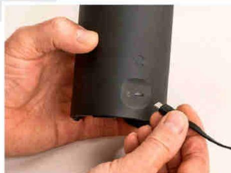
**ANSCHLUSS:** Mit einem USB-Stecker wird das Gerät mit Strom versorgt.
