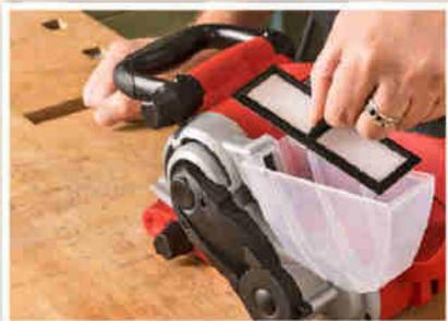
Beim Bandschleifer ist eine Staubfangbox eher als Notlösung anzusehen, da die Menge des Schleifstaubs sehr groß ist.
