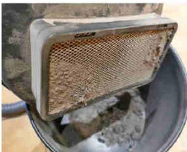
**VOLL:** Der Filter ist nach wenigen Minuten Aschesaugen zugesetzt.
