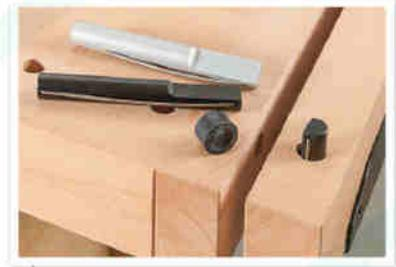
**BANKHAKEN** aus Stahl oder Aluminium ermöglichen es, Werkstücke auf der massiven Tischfläche der Bank sicher zu fixieren. Gespannt wird mit Hinter- oder Vorderzange. Die Ringschoner heißen bei Sjöbergs Werkzeugschutz.
