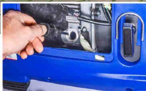
**KONTROLLE:** Der Ölstand wird am Peilstab hinter einer Abdeckung kontrolliert.
