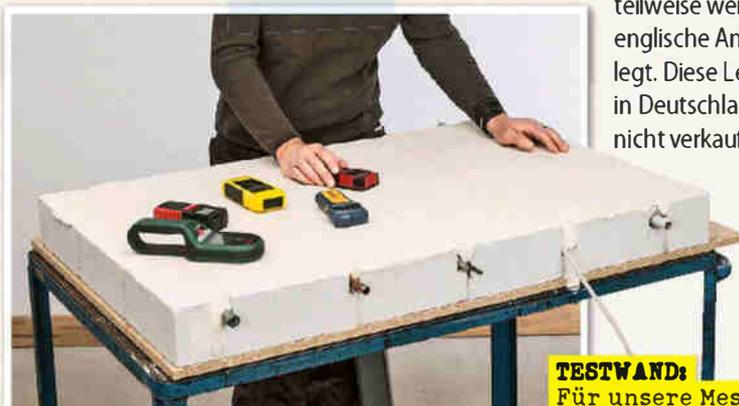
**TESTWAND:** Für unsere Messungen wurden Rohre und Leitungen in definierten Tiefen in einer Wand „versteckt“.
