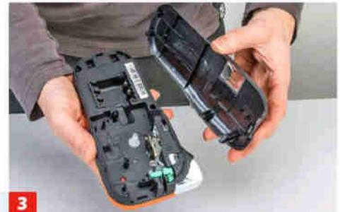
**3** Für den Wechsel wird das Gerät an der Rückseite geöffnet – damit werden alle für eine Wartung nötigen Bereiche zugänglich.
