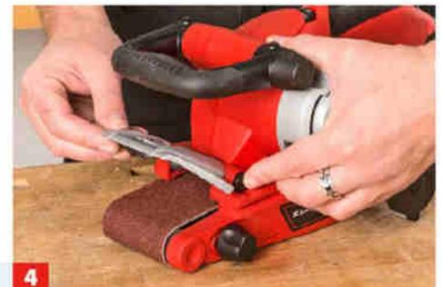
4 Randnahe Arbeiten werden mit einer solchen klappbaren Abdeckung erleichtert. Hier ist der vordere Umlauf zusätzlich flacher.
