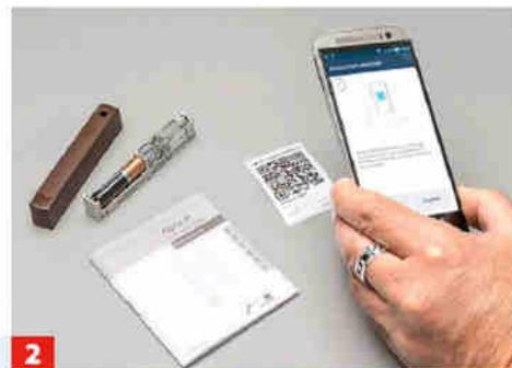
**2** Bei *Homematic IP* wird auch jedes verwendete Endgerät per Scan mit der App verbunden – damit wird Missbrauch erschwert.
