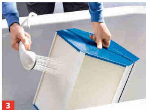
**3** Die Membran des Wärmetauschers (hier von Zehnder) ist wasserbeständig: Einfach unter fließendem Wasser reinigen.
