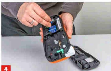
**4** Der Betrieb erfolgt mit üblichen AA-Batterien oder Akkus, die im unteren Bereich des Geräts eingelegt werden.
