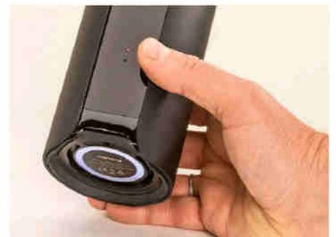
**SIGNAL:** Licht an der Unterseite des Geräts signalisiert, wenn die Kamera in Betrieb ist.
