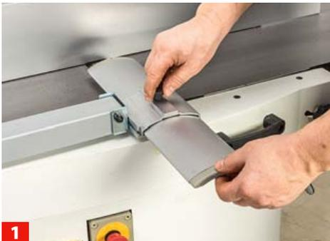
**1** Die Sicherheitsabdeckung lässt sich bis rund 75 mm Höhe einstellen. Bei stärkerem Holz kann sie verschoben oder entfernt werden.
