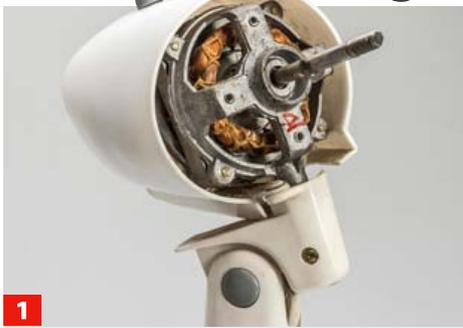
**1** Nach Demontage des Propellers wird der Motor sichtbar. In unserem Fall lässt sich die Welle nur sehr schwer drehen.
