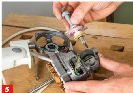
**5** Das Getriebe wird über eine Schnecke direkt über die Motorachse bewegt und kann mit einem Schieber ausgekuppelt werden.
