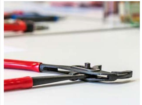
**LOSE:** Nach kurzem Gebrauch löst sich der Verbindungsniel bei *Dema*.
