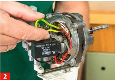
**2** Sicherheitshalber den noch montierten alten Kondensator kurzschließen, um eine unkontrollierte Entladung beim Ausbau ...
