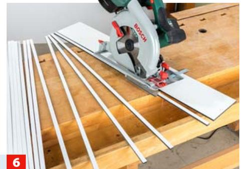
**6** ... Fingerfräser 7 mm tief einlassen. Dann schneiden Sie aus der Bauallzweckplatte 16 Federn als Führungsschienen.
