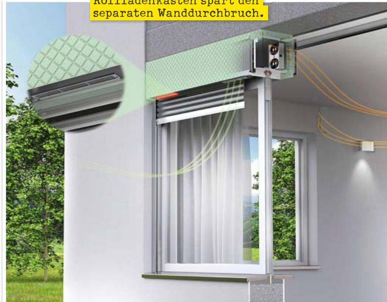
**SAUBER:** *Roka-Top 2 RG Airfox 5* ist ein raumseitig geschlossener Aufsatzrolllädchenkasten aus EPS-Hartschaum mit seitlich integriertem Lüftungssystem – Frischluft bedarfsgerecht, wohldosiert und gefiltert.
