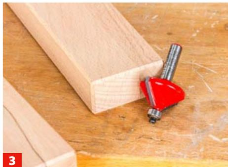
**3** Die Leisten werden an allen Kanten – auch an den Köpfen – fein gefast. Am besten gelingt dies mit einer stationären Oberfräse.
