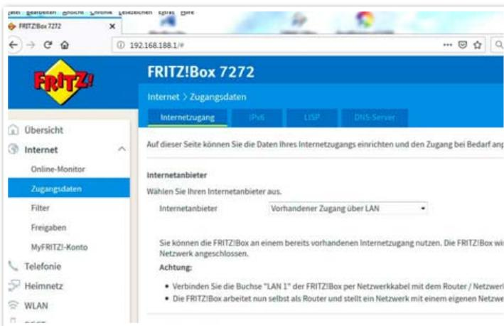
**ANSCHLUSS:** Als Internetanbieter wird eine LAN-Verbindung ausgewählt. Je nach Gerät wird eine LAN-Buchse des ersten Routers mit dem WAN- oder (falls nicht vorhanden) LAN1-Anschluss verbunden.
