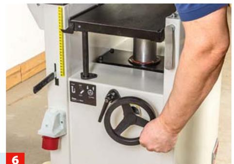
**6** ... gehobelt werden. Die Vorschubgeschwindigkeit ist nicht regelbar. Der untere Tisch wird per Handrad eingestellt.
