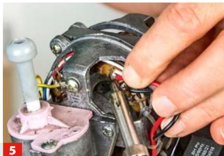
**5** Anschlussenden polrichtig an den Lötstellen des alten Kondensators anlöten – in unserem Fall direkt an der Motorwicklung.
