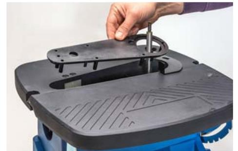
Eine Einlage aus Kunststoff verschließt den Bereich der Bandführung im Tisch.
