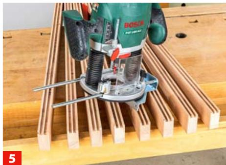
**5** Auf der Innenseite werden diese Zargen auf ganzer Länge mit zwei parallelen Längsnuten versehen, die Sie mit einem ...
