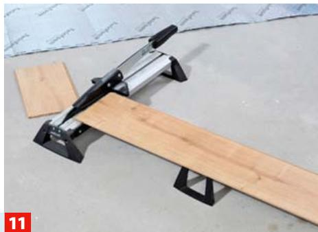
**11** Statt einer Stichsäge kann man einen Laminatschneider zum Kürzen verwenden. Geht etwas schneller und viel staubärmer.
