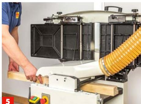
**5** Nach Umlegen der Haube – auch sie rastet ein – kann der Vorschub per Hebel eingekuppelt und das Material auf Dicke ...
