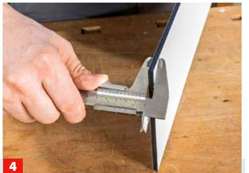
**4** Als Führungsschienen für die Auszugsplatten haben wir eine 6 mm starke HPL-Platte, (auch Bauallzweckplatte) verwendet.
