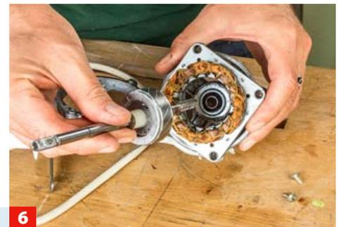
**6** Schließlich können Sie die Motorwelle aus dem Wicklungskäfig herausziehen. Deutlich sichtbar das Läuferpaket in der Mitte.
