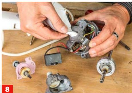
**8** Verschmutzungen zum Beispiel mit Zellstoff abnehmen, danach alle Lager ölen oder mit Silikonspray behandeln.
