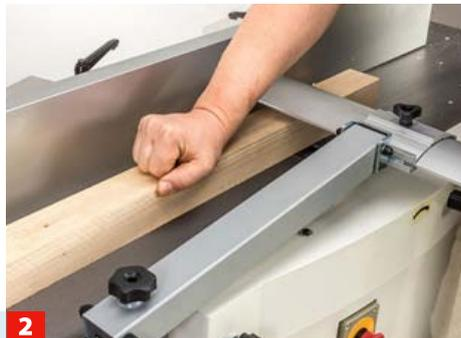
**2** Die Tischfläche sollten Sie zunächst mit Silbregleit einreiben. Bis zu 3 mm Spanabnahme erlaubt die Tischhöhenverstellung.
