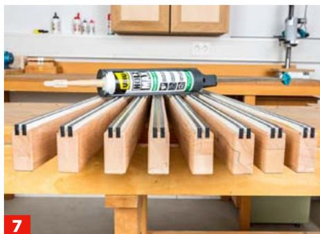
**7** Mit einem Polymer-Montagekleber wie z. B. Uhu Holz Max kleben Sie die Federn bündig ein. Nicht zu viel Klebstoff auftragen!
