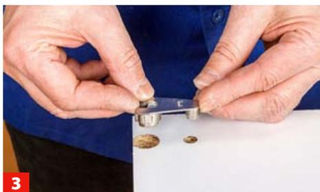
**3** Nach dem Fräsen mit der Kopierhülse können Sie die VB einsetzen. Hier der VB 36 ...
