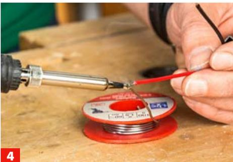
**4** Die Litzenenden des neuen Kondensators ein Stück abisolieren, verdrehen und mit Radiolot verzinnen.
