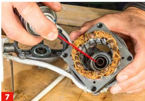
**7** Nach der Demontage alle Lager und Führungen mit Reinigungsspray (zum Beispiel WD-40) behandeln, einwirken lassen.
