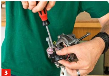
**3** ... auszuschließen. Kondensatorgehäuse abschrauben, Lötstellen mit Lötkolben erhitzen und Verbindungen abziehen.
