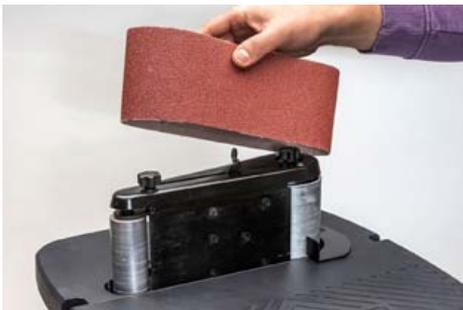
Das Schleifband wird werkzeuglos gewechselt – per Hebel auf der Oberseite des Antriebs.
