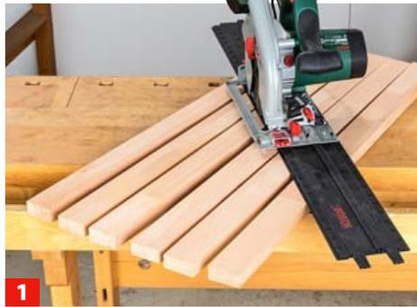
**1** Schneiden Sie das 27-mm-Buche-Leimholz in 54 mm breite Riegel auf. Achten Sie darauf, die Platte möglichst zwischen den ...
