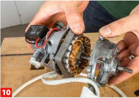
**10** Nun die demontierten Teile in umgekehrter Reihenfolge wieder zusammenbauen. Dabei die Leichtgängigkeit der Welle ...
