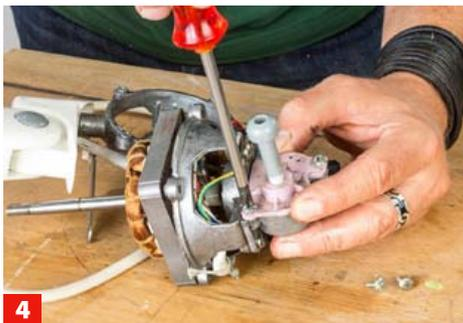
**4** ... Kondensator des Drehstrommotors. Hier ist der Antrieb für die Pendelbewegung des Geräts zu demontieren.
