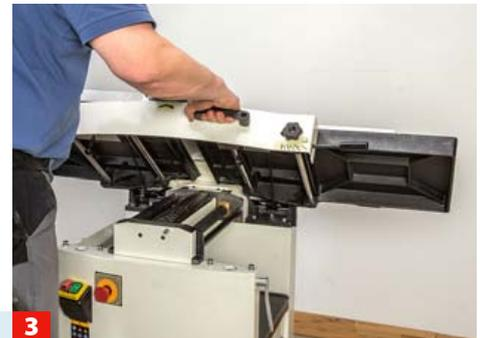
**3** Der Umbau zum Dickenhobel ist einfach: Klemmhebel lösen und Tisch nach hinten klappen. Dort rastet ein Klapphaken ein.
