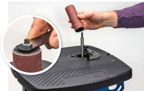
Die Antriebsachse nimmt die Führungsrollen für die zylindrischen Schleifkörper auf.
