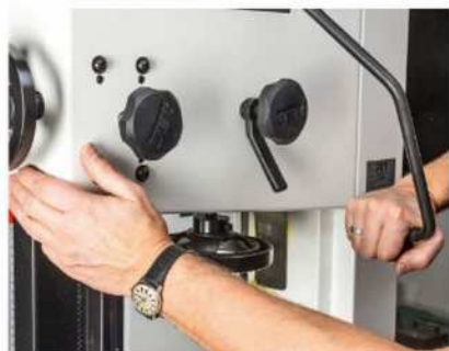
Der Schnellspann-Hebel ermöglicht einen raschen und einfachen Wechsel des Blatts.
