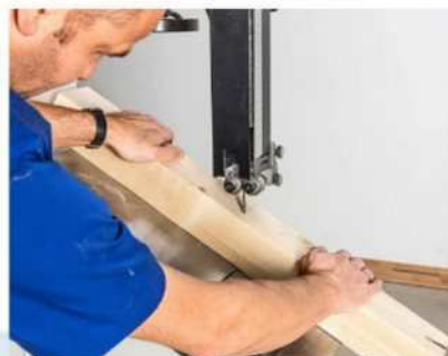
Der 55 x 40 cm große Guss-Arbeitstisch lässt sich stufenlos bis 45° neigen.
