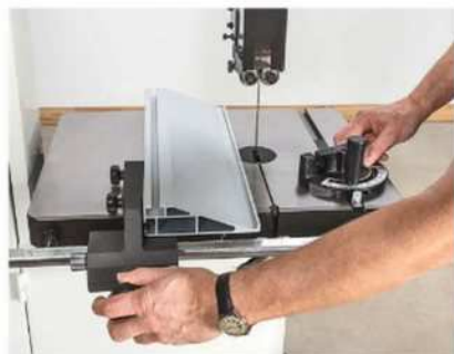
Die Maschine besitzt einen kippbaren Längs- und ein verstellbaren Winkelanschlag.
