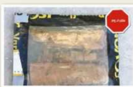
FAUL Nach 10 Jahren ist das mit simpler PE-Folie verpackte, feuchte Holz faul und verschimmelt.
