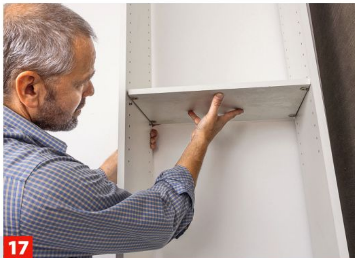
14 Zum Aufbau markieren Sie die Positionen der Konstruktionsböden und drehen in die entsprechenden Löcher die Schraubdübel ein.
