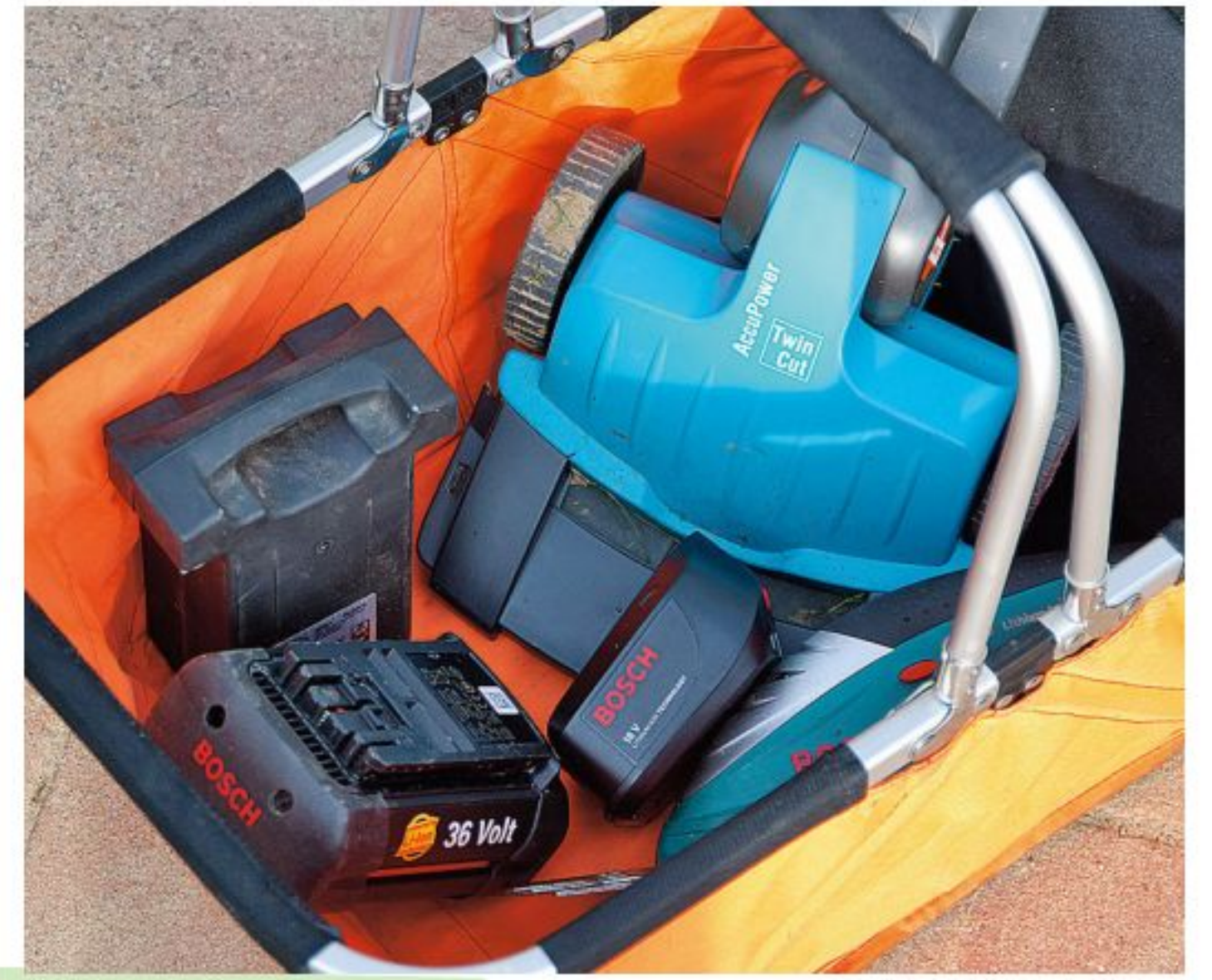
GERÄTE-AKKUS: Lagern Sie Akkus separat von Geräten und Werkzeugen frostsicher ein.
