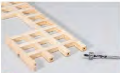
28 ... Überblattungen für die Schwellen der Giebelwände überstehen. Dann verkleben. Auch hier Dübellöcher in die Querriegel bohren.
