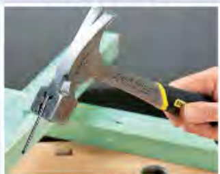
Praktisch ist ein Nagelhalter am Kopf des Latthammers.
