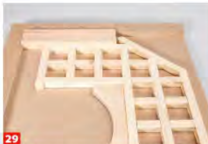
29 Diese Löcher müssen auf die entsprechenden Eckpfosten der Giebelwände übertragen werden. Mithilfe eines dickeren ...
