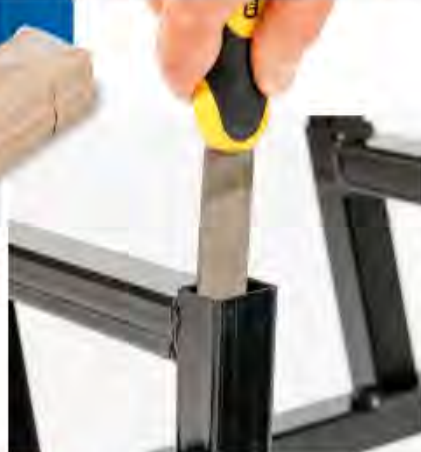
NACHARBEIT: Beim Modell von D&S Vertrieb störte eine Schweißstelle die Montage.
