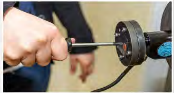
HANDARBEIT: An einer Messdose kann man objektiv ermitteln, wie stark man wirklich an der Schraube drehen kann.
