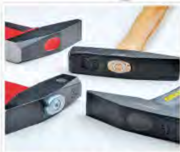
An einer sichtbaren Befestigung können Sie die Qualität beurteilen.
