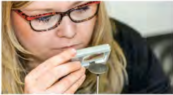
EXAKT VERARBEITET? Die VPA Remscheid testet für uns regelmäßig PH- und PZ-Klingen auf normgerechte Profile.
