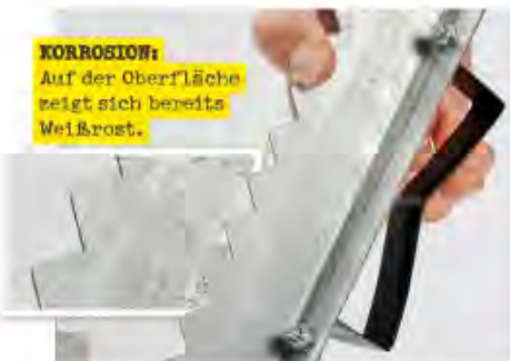
MÄNGEL: Korrosion und dünnes Material beim Sägebock von Deuba.
