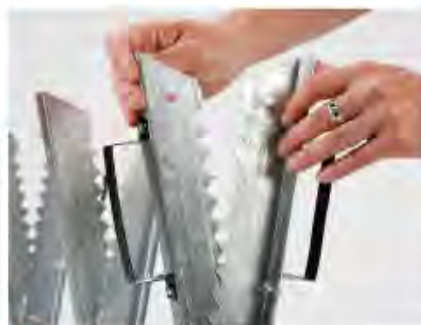
VERBOGEN: Der Deuba-Sägebock klemmt beim Zusammenklappen.
