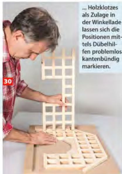
27 Beim Übertragen der Dübellöcher für die Schwellen müssen Sie seitlich jedoch eine Leiste als Zulage verwenden, damit die ...
