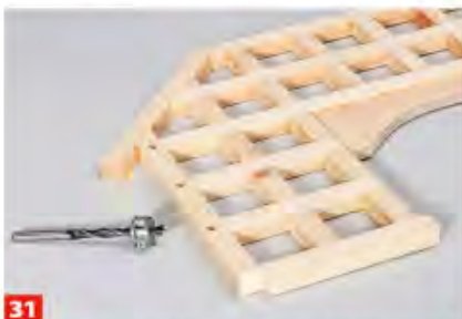
31 Dort die Sacklöcher mit dem Holzbohrer und eingestelltem Tiefenstopp einlassen. Stellen Sie so zunächst alle Dübellöcher her!
