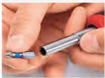
VIELSEITIG: Viele der Kombi-Schraubendreher sind mit Wechselbits nutzbar.
