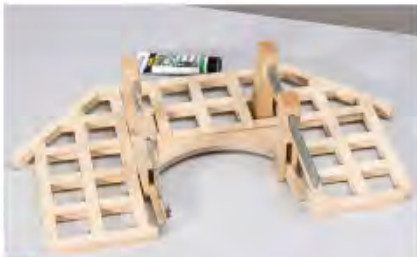
25 Dann Klebstoff angeben, Dübel einsetzen, zusammenfügen und verpressen.
