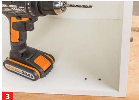
**3** Dort bohren Sie zwei Löcher mit dem 5-mm-Bohrer. Achten Sie auf die Bohrtiefe, nicht durchbohren!
