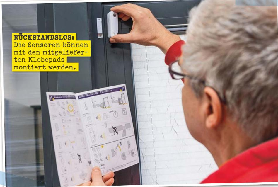
**RÜCKSTANDSLOS:** Die Sensoren können mit den mitgelieferten Klebepads montiert werden.
