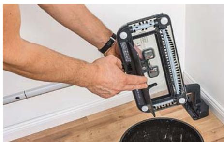
**BÜRSTENWERK:** Staub wird (meistens) vom Boden in den offenen Behälter befördert.
