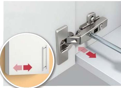
Durch Eindrehen der Verstelle schraube wird die Tür von der Wand weggedrückt, durch Lösen derselben rückt sie näher an die Wand.
