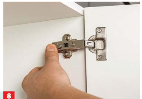
**8** Den Scharnierarm von vorn in die Montageplatte einhängen und aufklipsen oder aufschieben und verschrauben. Dann justieren.
