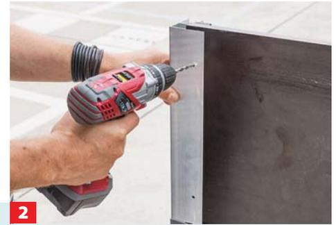
Sie Seitenwände haben wir fest mit den Eckprofilen verschraubt, sodass sie als komplette Einheit auf die Hängerwand ...
