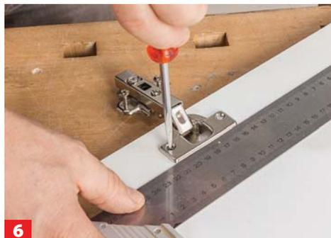
**6** Je nach Scharniertyp das Topfband werkzeuglos an die Tür klipsen oder wie hier ankorner und mit zwei Schrauben fixieren.
