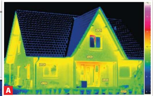
**A SANIERT Gut gedämmt:** Alle Hausbereiche weisen eine einheitliche Farbe auf. Nur das satte Rot zeigt: Dauernd gekippte Fenster vergeuden Energie.
