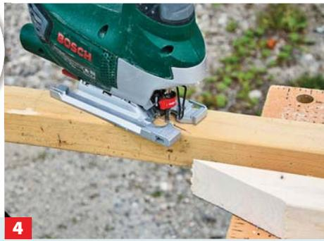
**4** Die Latten für die Giebel schneiden Sie so zu, dass sie in Dreiecksform passgenau zusammengesetzt werden können.
