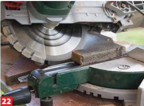
**22** Die einzelnen Dielen werden mit der Kapp- und Gehrungssäge passgenau zugeschnitten.
