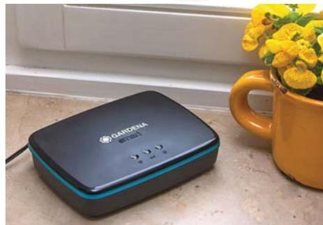
Die *Gardena Systemzentrale (Gateway)* baut über den heimischen Router eine Verbindung zum Internet auf. Die kompatiblen ...
