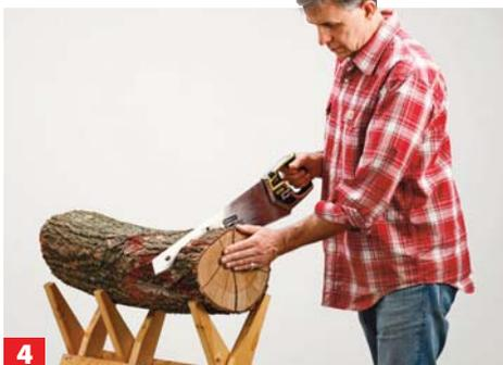
**4** Nun schneiden Sie den Stamm mit dem Fuchsschwanz oben und unten maximal bis zur Stammhälfte ein. Anschließend ...
