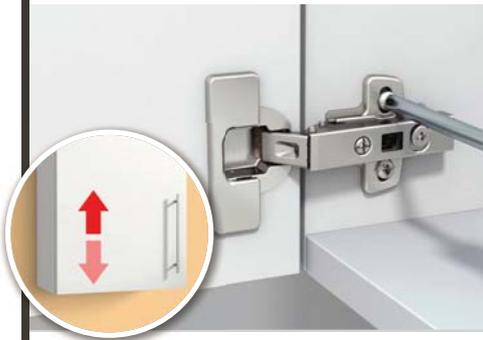
Lösen Sie die Schrauben der Montageplatten und heben oder senken die Tür. Dann die Schrauben fest anziehen.
