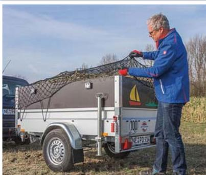
Die montierte Bordwanderhöhung gilt nicht als konstruktiver Bestandteil des Anhängers, sondern ist Teil der Ladung – eine besondere Zulassung oder TÜV-Abnahme ist daher nicht nötig. Zusammen mit den transportierten Gütern sind Sie als Fahrzeugführer dafür verantwortlich, dass die Ladung gesichert ist – entsprechend sollten Spanngurte oder ein Netz die transportierten Materialien zusätzlich fixieren.
