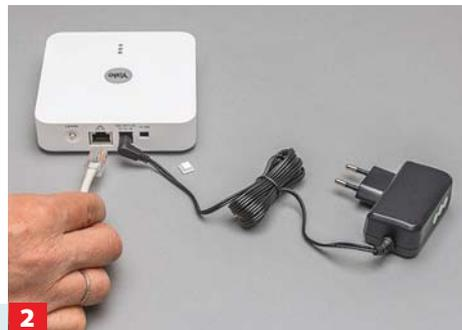
**2** Die (akkugepufferte) Zentrale benötigt eine LAN-Anbindung an den heimischen Router.
