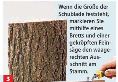
Wenn die Größe der Schublade feststeht, markieren Sie mithilfe eines Bretts und einer gekröpften Feinsäge den waagerechten Ausschnitt am Stamm.
