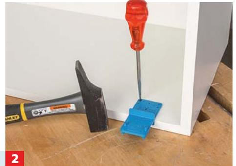
**2** Legen Sie die Schablone (die 37-mm-Lochreihen-Seite zeigt nach oben) auf und können die beiden Bohrlöcher (32 mm) an.
