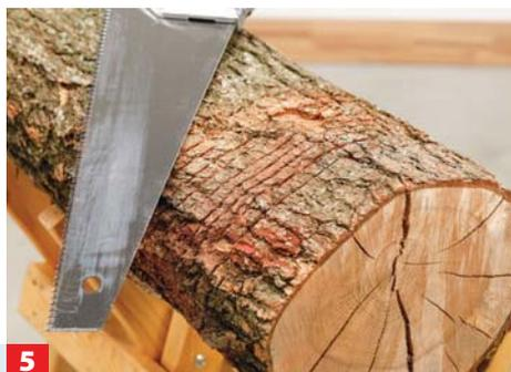
**5** ... mehrmals lamellenförmig einschneiden. Diese Schnitte können Sie auch gut mit einer Motorsäge erledigen.
