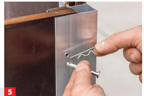
Front- und Heckbrett haben wir zur einfacheren Beladung mit solchen Bolzen mit Splintloch und passender Sicherheitsspanne versehen.
