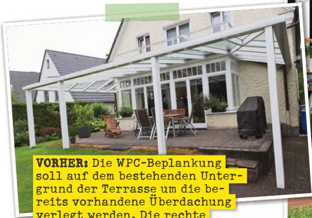
**VORHER:** Die WPC-Bepflankung soll auf dem bestehenden Untergrund der Terrasse um die bereits vorhandene Überdachung verlegt werden. Die rechte Terrassenseite wird stufenweise durch Gabionen abgegrenzt.
