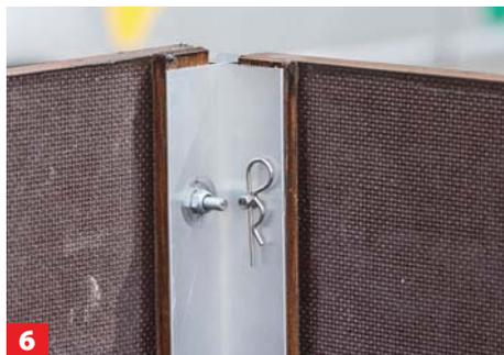
Mit dieser Befestigungslösung kann im Heck auf eine aufwendige Klappbefestigung der Bordwand verzichtet werden.
