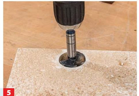
**5** ... das Bohrloch an der 35-mm-Position ankorner. Dort bohren Sie mit dem 35-mm-Topfbandbohrer ein ca. 13 mm tiefes Loch.
