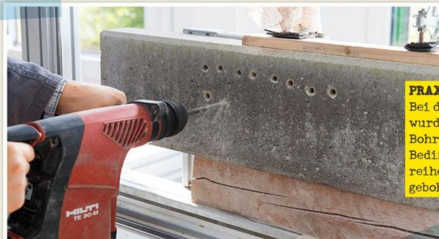
**PRAXISTEST:** Bei der *VPA Remscheid* wurden mit jedem Bohrer unter gleichen Bedingungen Testreihen mit Zeitmessung gebohrt.
