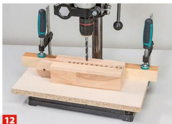
Das Zapfenelement wird zum oberen Schenkel mit Befestigungsschlitz für die Werkstück-Montageplatte. Bohren Sie entlang ...
