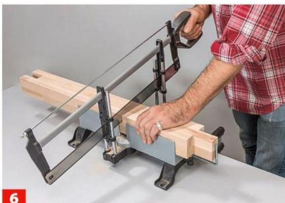
**6** Ausgetretenen Leim entfernen und den Schenkelrohling auftrennen. Dadurch erhalten Sie ein Schlitz- und ein Zapfenstück.
