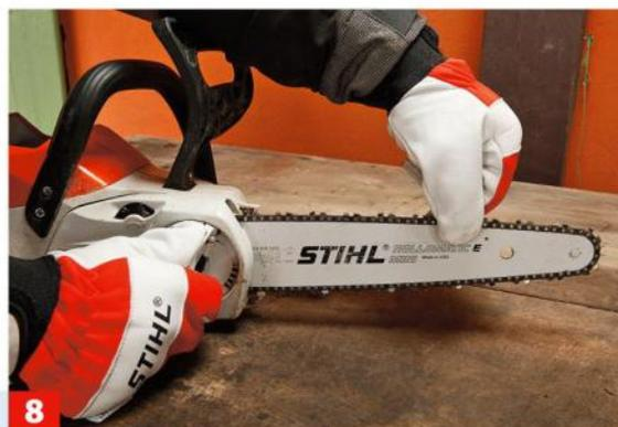
**8** Spannen Sie die Kette nur so stark, dass sie noch per Hand über die Schiene gezogen werden kann.
