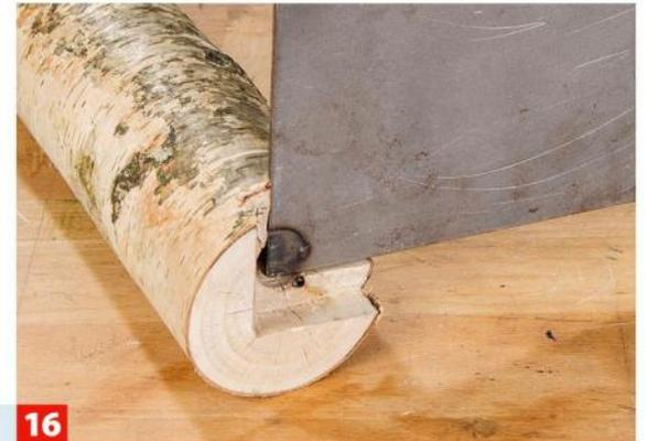
**16** Dann stecken Sie die Eisenplatte mit den angeschweißten Bolzen ein. Tisch aufstellen, Beine ggf. richten und trocknen lassen.
