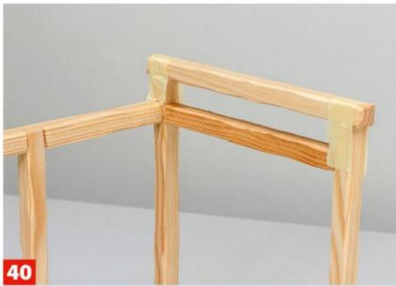
**40** Auf die überstehenden Ständer wird ein Balken geleimt, der später die Sparren des Schleppdachs trägt.
