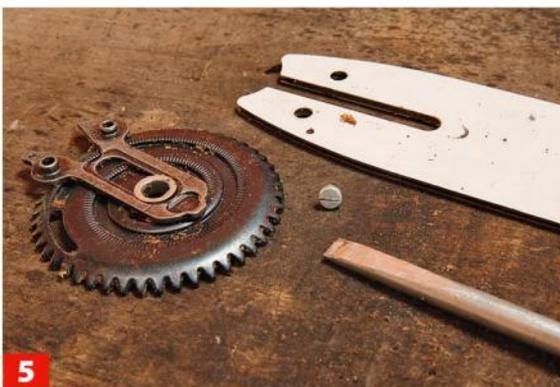
**5** Reinigen Sie auch das Schwert. Sofern eine Spannscheibe vorhanden ist, sollte diese dazu demontiert werden.
