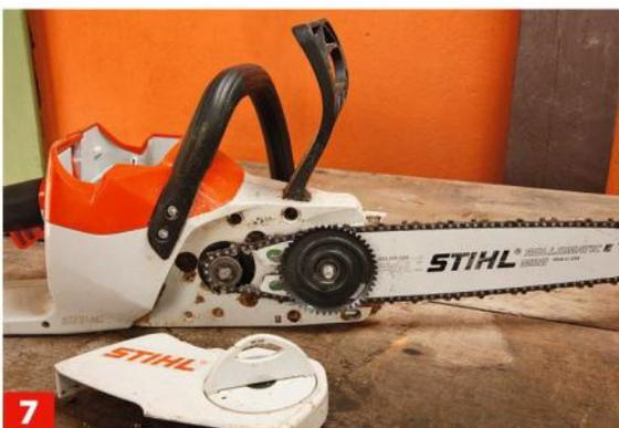
**7** Antrieb und Kette sind wieder sauber – die Maschine kann bis zum nächsten Sägevorgang eingelagert werden.
