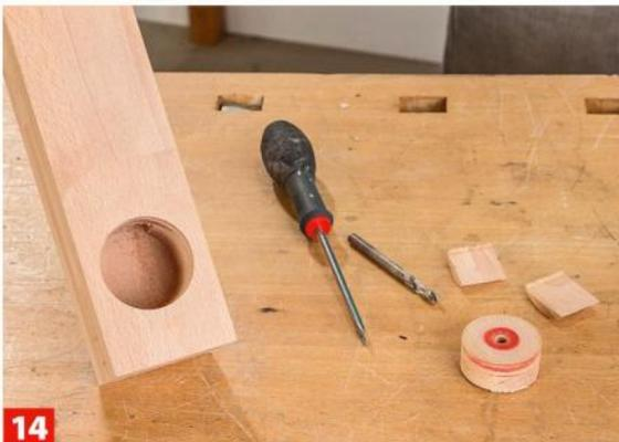
**14** Den Deckelkreis und die beiden Segmente der Seitenwände können Sie leicht heraushebeln, den Rest glätten und schleifen Sie.
