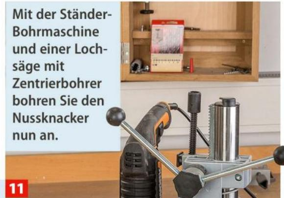
**11** Mit der Ständer-Bohrmaschine und einer Lochsäge mit Zentrierbohrer bohren Sie den Nussknacker nun an.
