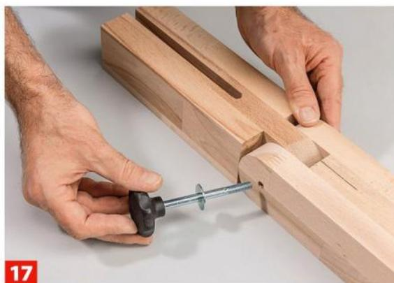
... Sechskantschraube M8 x 90 ausgetauscht werden. Handraddeckel schließen, Karosserie-scheibe aufstecken und Schraube festziehen.
