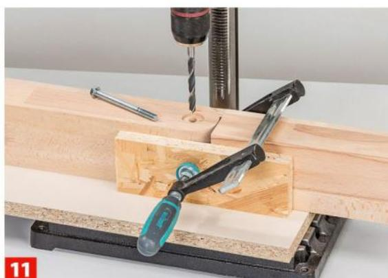
Fixieren Sie beide Bauteile mit Zulagen und durchbohren mit einem 8-mm-Bohrer mittig durch die Zapfensenkung alle Holzlagen.
