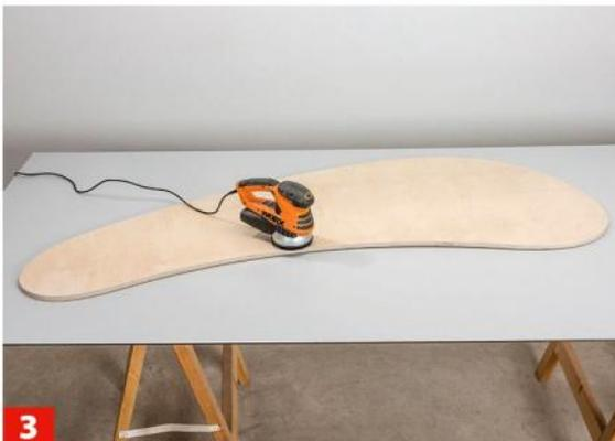
**3** Um Unregelmäßigkeiten an der Schnittkante zu egalisieren, am besten mit einem Exzentrerschleifer nacharbeiten
