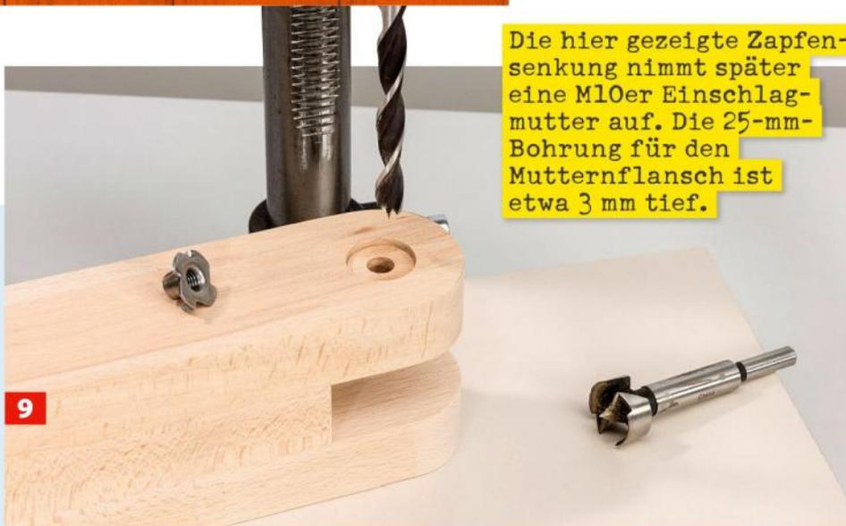
Die hier gezeigte Zapfensenkung nimmt später eine M10er Einschlagmutter auf. Die 25-mm-Bohrung für den Mutternflansch ist etwa 3 mm tief.
