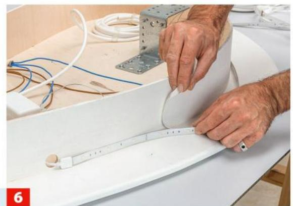
**6** ... montiert. Die LED-Zuleitung führen Sie durch eine Bohrung nahe der Deckplatte heraus. Damit ist die Verkabelung abgeschlossen.
