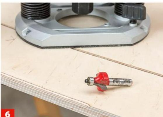
**6** Die Außenkanten mit einem Abrundfräser mit Anlauftring auf beiden Seiten abrunden oder alternativ anfasen.
