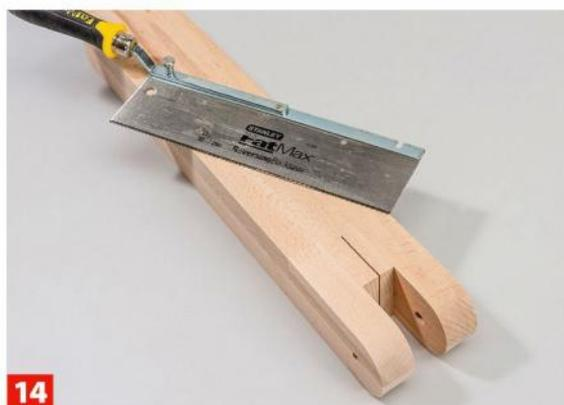
Damit sich die Schenkel besser verspannen lassen, muss die Basis des Schlitzbauteils noch mittig eingeschnitten werden.
