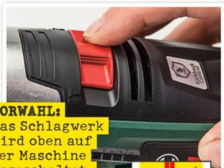
**VORWAHL:** Das Schlagwerk wird oben auf der Maschine zugeschaltet.
