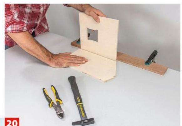
**20** Rückwand, rechte und linke Seite stoßen stumpf an und werden mithilfe des Nageltricks markiert und später verleimt.
