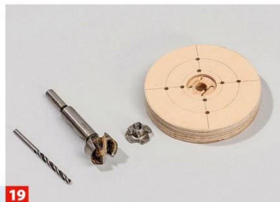
Mittig die bekannte Zapfensenkung für die Einschlagmutter und im Fadenkreuz insgesamt acht 4-mm-Löcher bohren.
