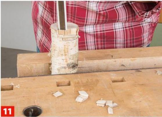
**11** Mit einem scharfen Beitel stemmen Sie nun zunächst den auf dem Kopf äußeren Anriss bis zum oberen Anriss des Umfangs aus.
