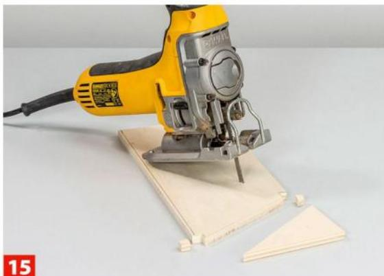
**15** Die Giebelwände – wegen des besonderen Grundrisses sind es drei – zuschneiden und für die Dachbalken ausklinken.
