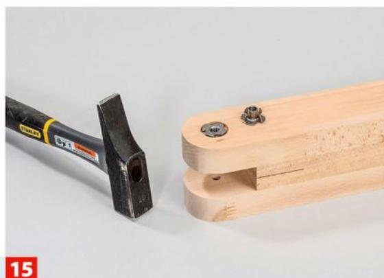
Jetzt können Sie die Einschlagmutter mit einem Hammer in die Zapfensenkung treiben.
