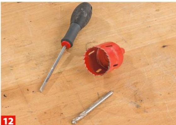
**12** Den Zentrierbohrer der Lochsäge jetzt so weit wie möglich zurückziehen – der Bohrer soll nicht aus der Krone herausragen!
