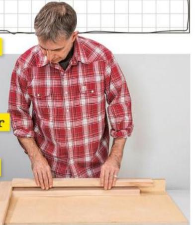
**3** ... werden Nägel eingeschlagen und abgeklopft. Dann drücken Sie die mittlere Lage um Materialbreite versetzt fest auf ...
