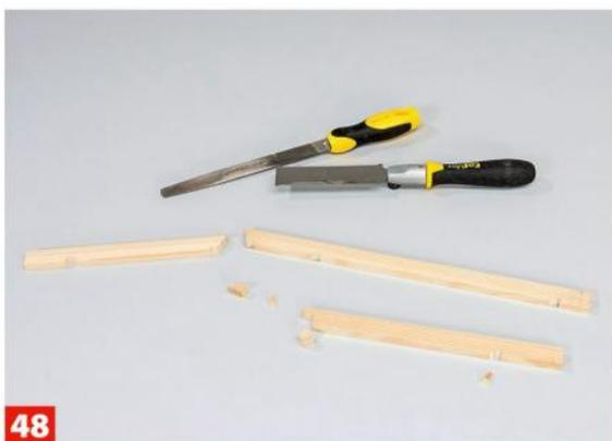
**48** Mit der Zieh- oder Feinsäge und einer Dreiecksfeile (ggf. mit einem Stechbeitel) arbeiten Sie alle Ausklinkungen sauber heraus.
