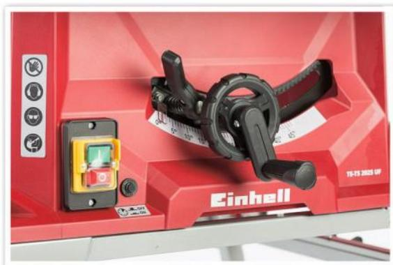
**BEDIENUNG:** Das doppelte Stellrad unter dem Sägertisch beeinflusst Sägertiefe und Neigung des Sägeblatts. Es ist arretierbar.
