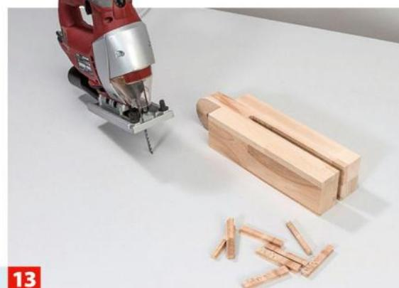
... der Mittelachse mehrere 8-mm-Löcher und schneiden rechts und links der Reihe mit der Stichsäge einen Schlitz.
