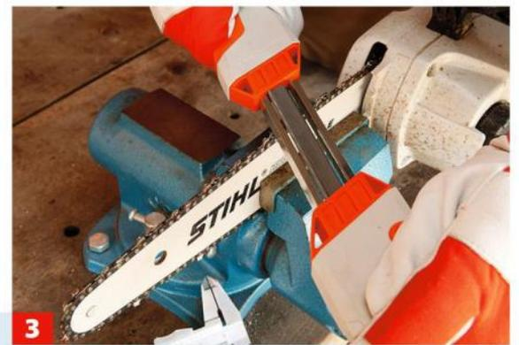
**3** Beginnen Sie am markierten Schneidezahn mit dem Nachfeilen – legen Sie dazu die Kettenbremse ein. Feilen Sie in einem ...
