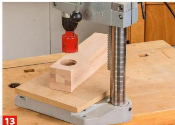
**13** Spannen Sie die Lochsäge wieder ein und schneiden vorsichtig das Loch bis zur Bodenplatte. Werkstück gut festspannen!
