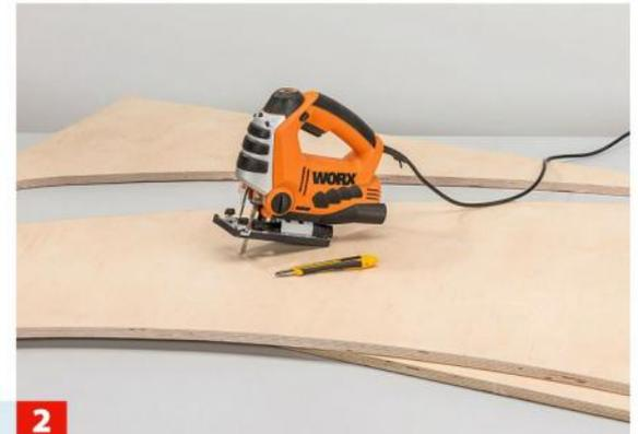
**2** Mit einer Stichsäge die Form ausschneiden – um Ausriss zu vermeiden, die Kontur mit einem Cuttermesser zuvor anritzen.
