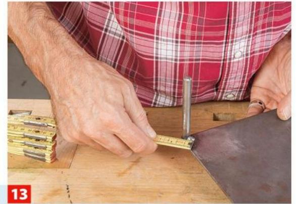
**13** Durchmesser und Höhe der Schweißraupen an den Ecken ausmessen. Die Raupen müssen auch ins Holz eingelassen werden!
