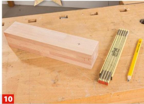
**10** Anschließend markieren Sie die Position des Sacklochs, in das die Nüsse eingelegt werden.
