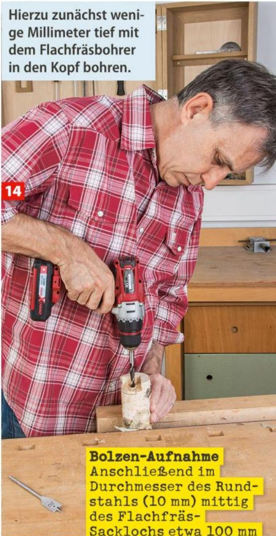
Hierzu zunächst wenige Millimeter tief mit dem Flachfräsbohrer in den Kopf bohren.
