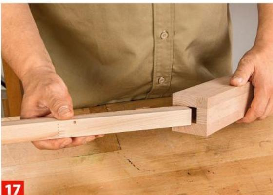
**17** ... bis er sich leicht und vollständig in die Öffnung am Kopf einstecken lässt.
