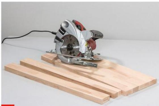
**1** Die Einspannvorrichtung wird aus 27-mm-Buche-Leimholz gebaut. Schneiden Sie das Material in gleich breite Streifen auf.
