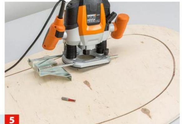
**5** ... eine gute Hilfe. Frästiefe von 10 mm mit 6-mm-Nutfräser in mehreren Schritten herstellen, Nut dann auf 7 mm Breite erweitern.
