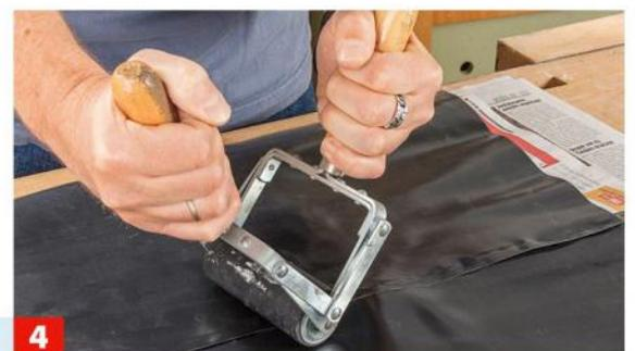
**4** Die Verklebung wird unmittelbar danach möglichst stark zusammengepresst. Eine Fixierung der Verklebung ist nicht nötig.
