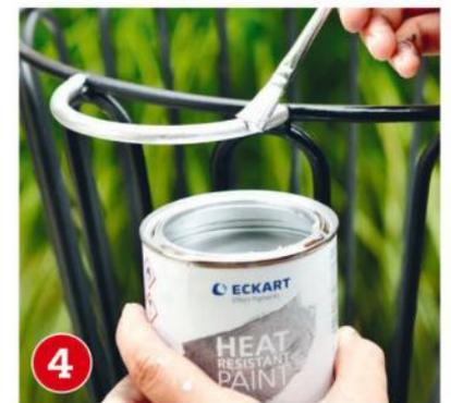
**4** Setzen Sie nun mit dem Thermolack Silber Akzente und heben Sie Verzierungen hervor. Rühren Sie den Lack gut auf und tragen Sie ihn gleichmäßig außen auf die bisher ausgesparten Bereiche Ihres Feuerkorbs auf. Bereits nach 30 Minuten ist die Oberfläche wieder trocken.
