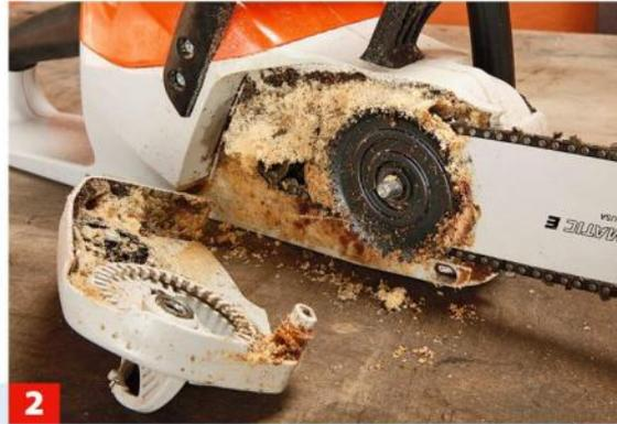
**2** ... Masse aushärten könnten. Öffnen Sie zunächst den Kettenraddeckel und lösen Sie die Kettenspannung.
