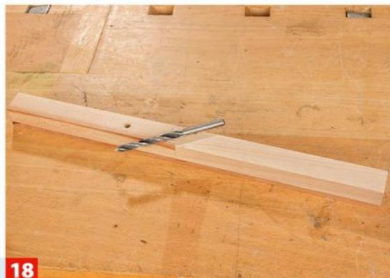
**18** Nun bohren Sie auch in den Schlagbolzen ein Loch für das Gummiseil.
