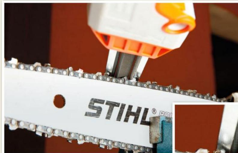
**Arbeitshilfe:** Mit den passend zur Kette ausgerichteten Feilen ist der Schärfvorgang auch für Gelegenheitsnutzer einfach.
