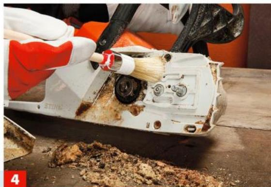
**4** Mit einem Pinsel können Sie den Schmutz aus dem Antriebsbereich entfernen. Auch Nuten werden gut erreicht.
