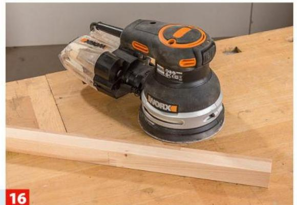
**16** Den Schlagbolzen müssen Sie nun z. B. mit einem Exzentrerschleifer nachschleifen, ...
