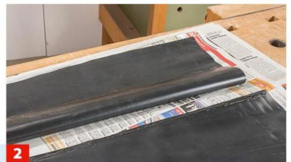
**2** ... zunächst mit dem Klebstoff benetzt und lüften dann bis zur oberflächlichen Trocknung des Klebstoffs ab.
