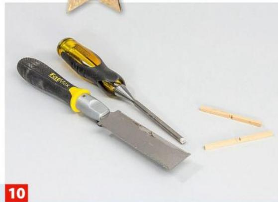
**10** Sie werden mit einer feinen Ziehsäge bis zur Hälfte eingesägt, die Überblattung wird mit einem schmalen Beitel freigestemmt.
