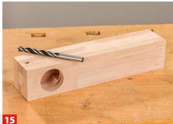
**15** Quer zu der Nussfalle wird an der Basis ein Loch für das Gummiseil gebohrt. Auch hierfür den Bohrstand verwenden!
