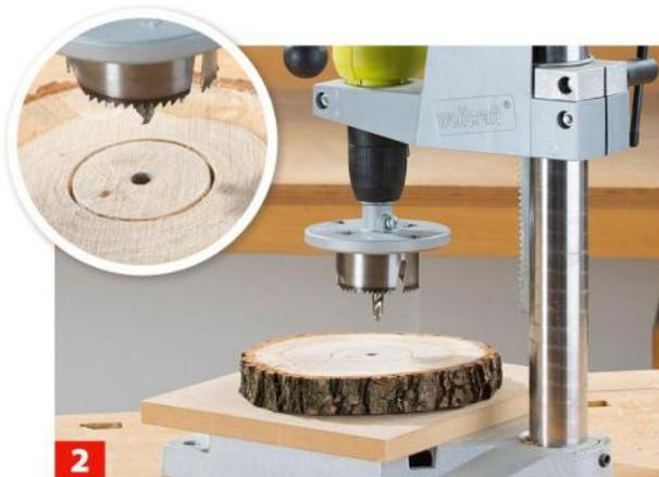
Mit der Lochsäge wird nun die unterste dünne Scheibe angebohrt, bis der Zentrierbohrer unten herauskommt.
