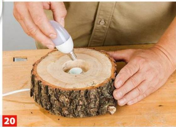
**20** Schrauben Sie das Leuchtmittel in die Fassung. Überprüfen Sie die Funktion der Lampe, bevor Sie weitermachen.
