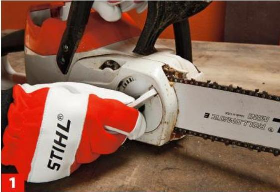
**1** Nach jedem Einsatz sollten Sie die Schneidgarnitur reinigen, da Verschmutzungen mit dem Sägekettenöl zu einer hemmenden ...
