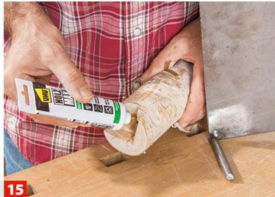
**15** Geben Sie etwas Montage- oder Holz-Kombi-Kleber an das Loch und an die Auflage für die Stahlplatte.
