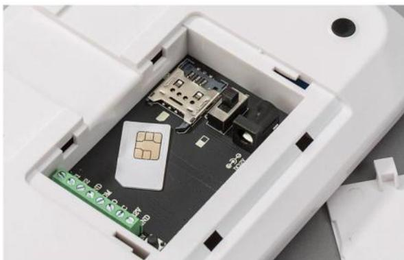
**AUTARK:** Die Zentrale benötigt einen Standort, an dem Handyempfang möglich ist – sie arbeitet mit dem GSM-Handnetz.
