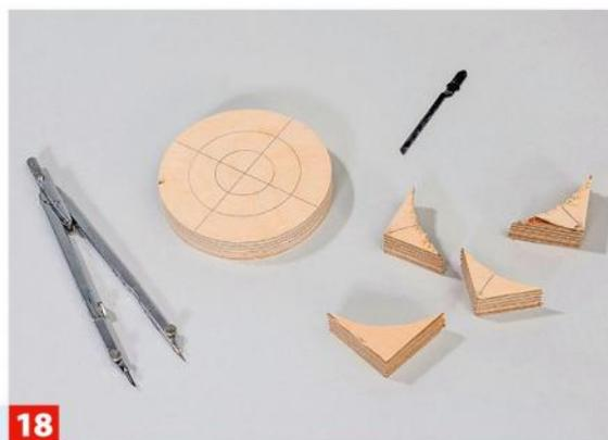
Als Werkstück-Aufnahme schneiden Sie einen Kreis aus 18-mm-Multiplex mit der Stichsäge und einem Kurvensägeblatt aus.
