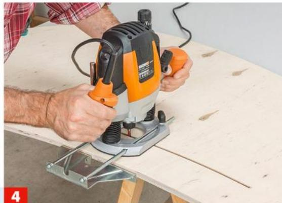
**4** Mit der Oberfräse und Nutfräser schaffen Sie die Haltenut für die Blende aus Biegesperrholz. Der Parallelanschlag leistet dabei ...
