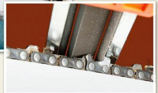
chen erfolgt eine optimale Führung der beiden Feilen. Sie müssen lediglich auf die Ausrichtung der Feile achten – dabei hilft der Rand der Griffbereiche, die den richtigen 30°-Winkel aufweisen.
