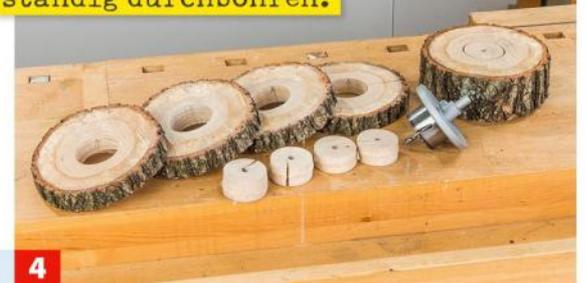
Legen Sie nacheinander die restlichen dünnen Scheiben unter die angebohrte Scheibe und übertragen Sie die zentrale Bohrung.
