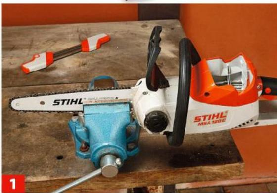
**1** Spannen Sie die Kettensäge mit dem Schwert in einen Schraubstock. Achten Sie darauf, dass die Kette nicht eingeklemmt ...
