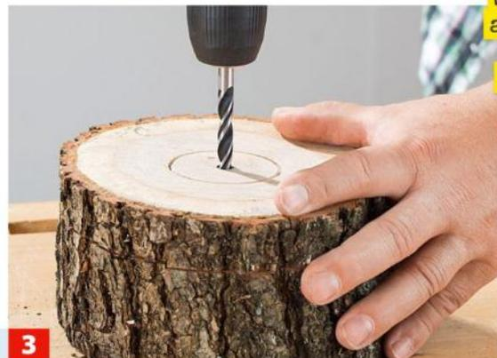
Legen Sie die Scheibe auf das Bodenstück und bohren Sie durch das Loch in der Mitte ein Zentrierloch für den Boden.
