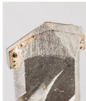
**LÖTFEHLER:** Bei *Work Plus* sind deutliche Löcher im Lot erkennbar.
