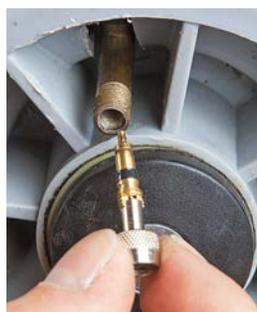
Mit dem Ventilschlüssel lassen sich Ventileinsätze lösen.
