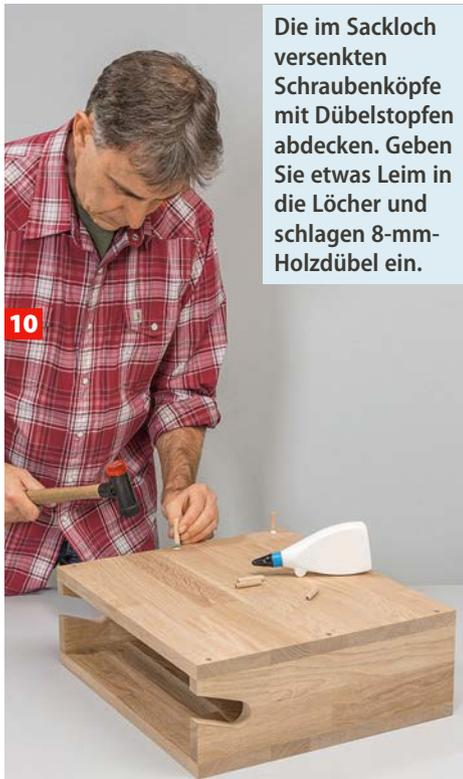
Die im Sackloch versenkten Schraubenköpfe mit Dübelstopfen abdecken. Geben Sie etwas Leim in die Löcher und schlagen 8-mm-Holzdübel ein.
