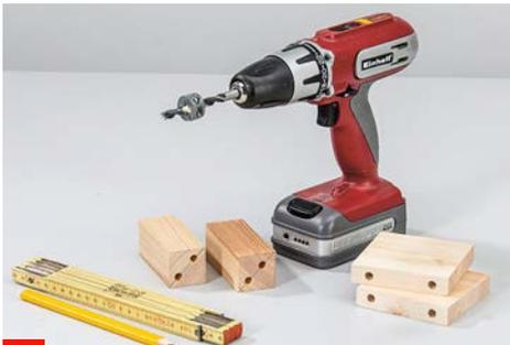
**9** Beide Rahmenteile werden durch Fuß-Querstreben und Auflageplatten miteinander verbunden. Bohren Sie hierzu ...
