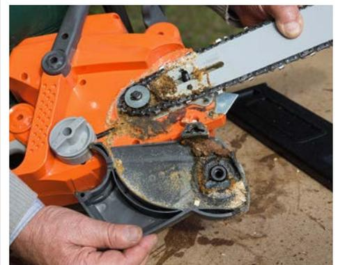
**-** **SCHMUTZIG:** Bei einigen Sägen (hier *Fuxtec*) finden sich verklebte Späne.
