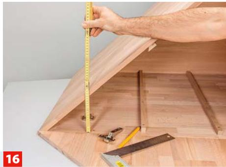
**16** ... und der Kreuzmontageplatten an – in der Spitze so, dass Sie die Schrauben noch mit einem „Stubby“-Schraubendreher erreichen.
