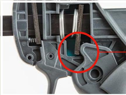
**SPANNEN:** Der Griffhebel verriegelt das Hebelplättchen an der Schiene und sorgt damit bei Betätigung für hohe Reibung.
