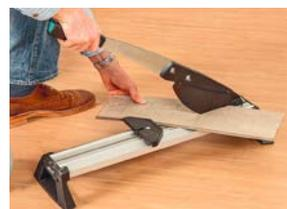
Der Anschlag ist drehbar und ermöglicht Winkel-schnitte.
