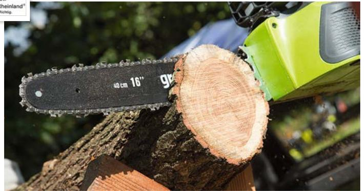
**-** **STILLSTAND:** Einige Maschinen schalteten bei Belastung sehr früh ab – wie hier die *Greenworks*-Kettensäge.
