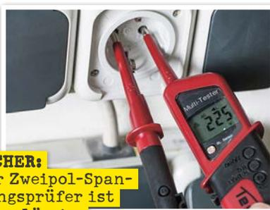
**SICHER:** Der Zweipol-Spannungsprüfer ist zuverlässig.
