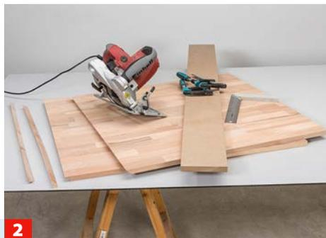
**2** Stellen Sie die Säge auf die erforderlichen Winkel ein und führen sie entlang einer Schiene oder einem aufgespannten Brett.
