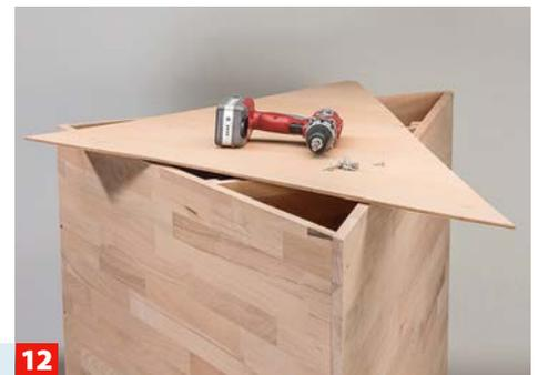
**12** Die Rückwand für die Schrauben vorbohren, auflegen und festschrauben. Der erste Korpus ist danach fertig.
