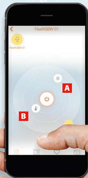
**Smarte Steuerung am Beispiel Smart+:** Helligkeit **A** und Lichtfarbe **B** können mit einem Fingerstreich verändert werden.
