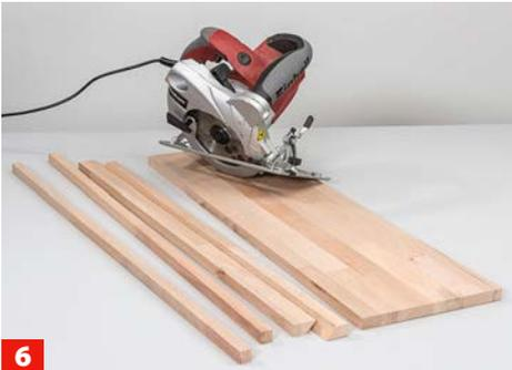
**6** Schneiden Sie nun die Auflagerleisten für die Zwischenböden zu: rechtwinklig zur Montage an der senkrechten Seitenwand ...
