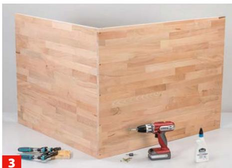
**3** Verschrauben und verleimen Sie zunächst den Boden mit dem senkrecht stehenden Wandelement. Dies erfolgt so wie schon ...
