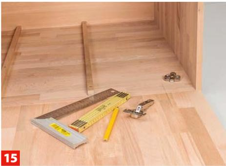
**15** Sind beide Korpusse montiert, werden die Türen zugeschnitten und liegend ausgerichtet. Zeichnen Sie die Lage der Topfbänder ...
