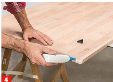
**4** ... beim Schubkastenkorpus. Dann geben Sie Leim an die Schrägschnitte des Bauteils und legen das Winkel-Element auf die Seite.
