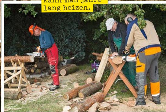
**! SICHERHEIT:** Auch wenn sie leiser arbeiten: Akku-Kettensägen sind so gefährlich wie übliche Motorsägen. Tragen Sie Schnittschutzkleidung und achten Sie auf sicheren Stand – niemals von einer Leiter aus sägen!
