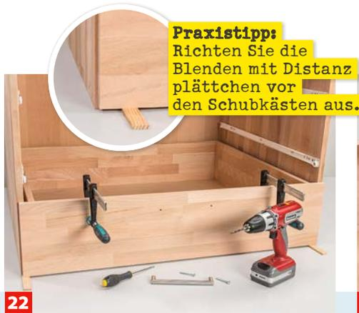
**22** Bohren Sie durch die Grifflöcher in die Schubkästen und spannen die Bauteile mit langen Schrauben und dem Griff gegeneinander.
