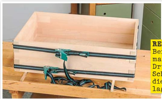
**REICHLICH KRAFT:** Beim Festziehen kann man einen erheblichen Druck aufbauen. Schützen Sie deshalb die Ecken mit Unterlagen, etwa aus Pappe.
