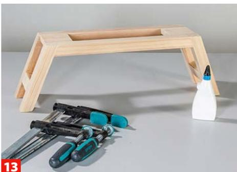
**13** Erneut bis zum Abbinden verpressen. Anschließend schleifen und je nach Wunsch ölen, wachsen oder lackieren.
