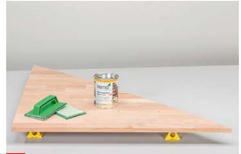
**7** Vor dem Aufbau folgt das Finish. Alle Flächen fein schleifen, entstauben und zwei- bis dreimal mit Hartwachsöl (*Osmo*) einlassen.
