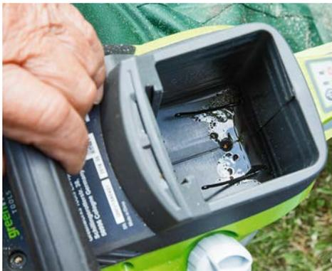
**-** **UNDICHT:** Bei *Greenworks* lief im Testverlauf Kettenöl in den Akkusack.
