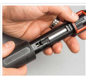
... dann das gewünschte Schraubprofil durch Drehen auswählen.
