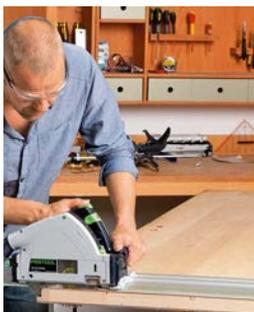
Eine Handkreissäge mit Schiene kürzt am besten.
