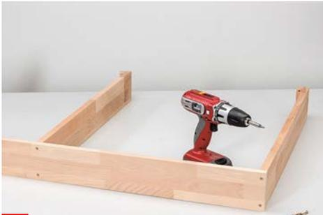
**5** Das hintere Längsbrett können Sie direkt mit den Querbrettern verschrauben – natürlich erst nach dem Bohren/Senken ...
