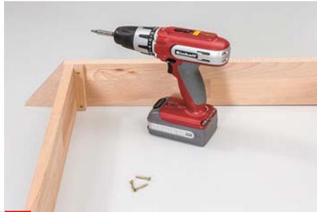
**6** ... und Vorbohren ins Kopfholz. Das vordere Sockelbrett wird dann von innen durch die Montageklötze montiert.
