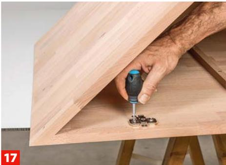
**17** Nun schrauben Sie die Montageplatten fest. Für die Bänder mit einem Topfbandbohrer ...
