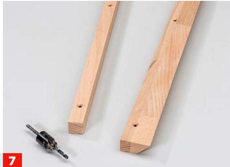
**7** ... und schräg für die Diagonalwand. Die Leisten durchbohren und von außen senken.
