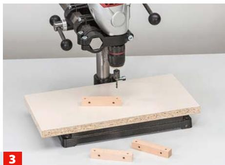
**3** Die Montageklötze (um ein paar Millimeter kürzer als die Sockelhöhe) ablängen und von zwei Seiten durchbohren und senken.
