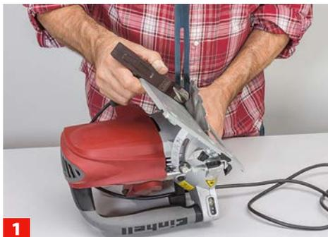
**1** Wir beginnen mit dem oberen Schrank: Die Diagonalplatte und der Anschluss der Bodenplatte werden schräg zugeschnitten.
