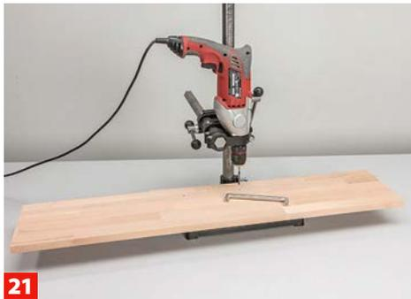
**21** Nach dem Zuschnitt der Schubkastenblenden werden diese für die Griffe durchbohrt.
