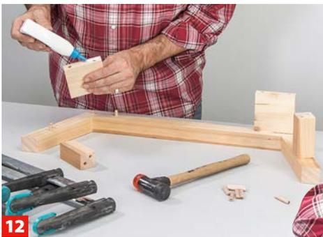
**12** Nach dem Bohren (auf die Bohrtiefe achten) die Holzteile belemen, die Dübel einsetzen und die Bauteile zusammenstecken.
