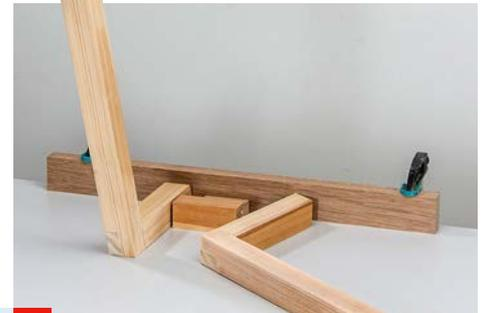
**11** Dies gilt für die Leimholz-Auflageplatten (Bild 10) genauso wie hier für die Fußstreben aus Quadratstab.
