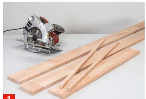
**1** Schneiden Sie die Sockelbretter und die Vierkantstäbe mit der Handkreissäge zu.
