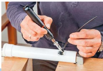
**ELEKTROWERKZEUG** Das preiswerte *Kunststoff-Reparatur-Set G-80* von *Orbi-Tech*.
