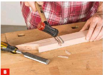
8 Mit gezielten Hammerschlägen brechen Sie dann die Lamellen seitlich weg.
