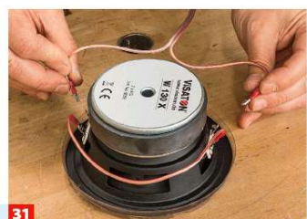
30 ... direkt anlöten. Mit Kabelschuhen (2,8 und 4,8 mm) lassen sich die Lautsprecher und das Anschlussterminal bequem anstecken.
