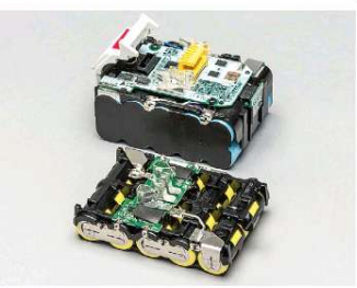
ÜBERWACHT: Die Akkus aller getesteten Maschinen verfügen über eine integrierte Elektronik (oben Makita, unten Bosch).
