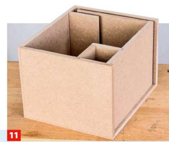
19 Überprüfen Sie immer wieder durch Zusammenstecken der Bauteile, ob alles passt. Auch Front und Deckel wurden bereits für ...
