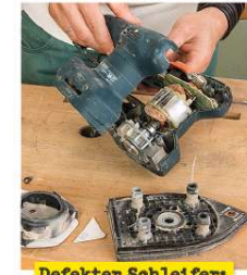
Defekter Schleifer: Manchmal reicht schon eine Reinigung zur Reparatur.
