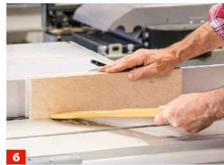
6 Sowohl das Anschlagbrett als auch das Schiebrett nutzen Sie etwa bei halber Materialstärke an einer Längskante.
