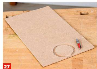
26 Als letztes wird die dünne Frontblende gefräst: Zunächst auf der Rückseite die Kreisnuten für den Hochtöner zirkeln, ...
