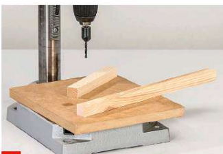
14 Längen Sie die Führungsleisten ab und durchbohren und senken Sie sie für die beiden Bauteile der Sägehilfe.
