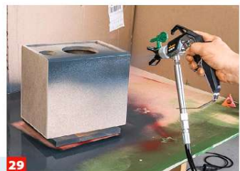
28 Wir haben das Gehäuse dunkelgrau sprühtlackiert (die Frequenzweiche abdecken) und die Front in einem Hellgrau gehalten.
