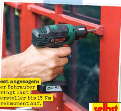
SPEICHERPLATZ: Der Akku am Ende des Gerätes sorgt für ein gutes Gleichgewicht.
