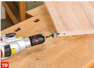
10 Nun bohren Sie in die Böden im Abstand von etwa 30 mm zur hinteren Kante je Seite und Boden ein 30 mm tiefes 8-mm-Loch.
