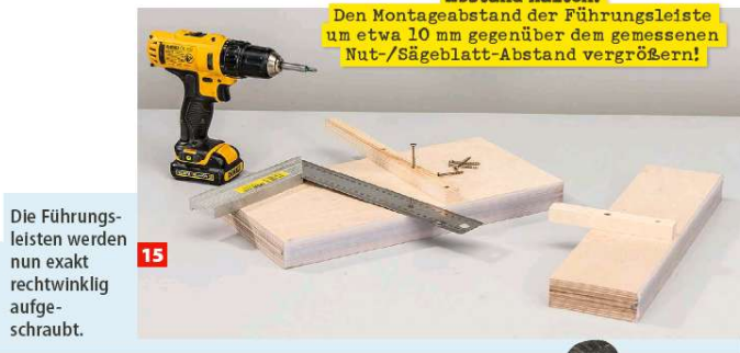
15 Die Führungsleisten werden nun exakt rechtwinklig aufgeschraubt.
