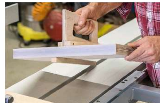
21 Den Schieberrahmen zurückziehen und die Sägehilfen mit aneinanderliegenden Silikonflächen am Anschlag in der Nut positionieren.
