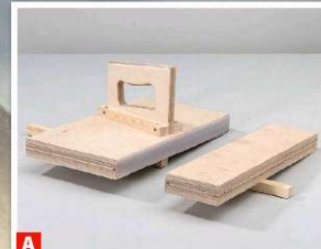
A Die zweiteilige Sägehilfe macht viele Stationär-Zuschnitte sicherer.
