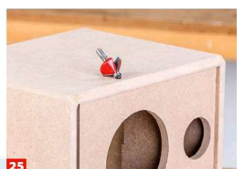
24 Nach dem Abbinden des Leims haben wir die Rückwände gefast. Blasen Sie anschließend das Gehäuse sauber aus.
