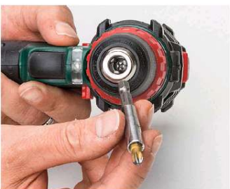
KURZ: Das Futter bei Parkside hat nur eine geringe Einstecktiefe.
