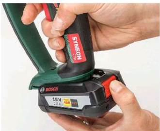
UNGÜNSTIG: Der Akku wird entgegen der Verriegelungstaste abgezogen.
