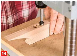
14 ... oberen Boden die Positionen an. Bohren Sie mit einem 15-mm-Forstnerbohrer drei Löcher – außen 4, in der Mitte 6 mm tief.
