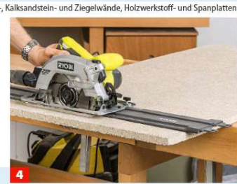
4 Schneiden Sie die Platten mit einer Handkreissäge, Stichsäge, Trennscheibe oder mit oszillierendem Schneidegerät.
