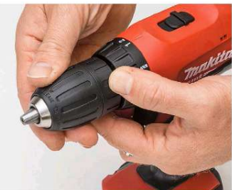
FOSSIL: Zweihülsige Futter (bei Makita MT) erfordern eine beidhändige Bedienung.
