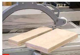
4 Nun schneiden Sie die Platte in zwei Teile auf: das schmalere Anschlagbrett und das breitere Schiebrett.
