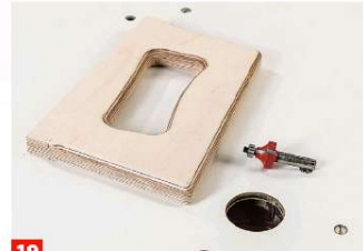
19 Idealerweise werden das Griffloch und die oberen Griffbrett-Kanten mit dem Abrundfräser bearbeitet, zumindest aber geschliffen!
