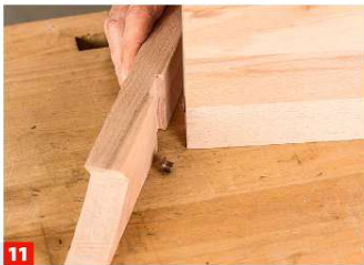
11 Mit Dübel-Markierstiften übertragen Sie die Lochpositionen von den Böden auf die Wandleisten. Markieren Sie dazu die Lage ...
