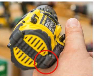
DRUCKSTELLE: Die kantige Gehäuseform (hier bei Stanley) stört.
