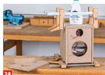
23 Nun verleimen Sie zunächst Seiten, Front, Hochtön-Wandwinkel, Querverstärkung, Reflexkanal-Bretter und Deckel miteinander.
