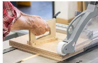
22 Erst jetzt erfolgt der Besäumschnitt – die Länge der Sägehilfen wird damit an die Säge angepasst.
