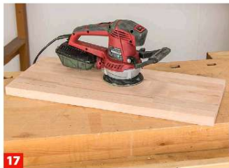
17 Mit einem Exzentrerschleifer und 220er Schleifpapier glätten Sie nun das Holz und brechen die scharfen Kanten von Hand.
