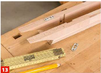
13 Bevor Sie das Regal verleimen, werden die Aufhängebeschläge in die Wandleisten eingelassen. Zeichnen Sie knapp über dem ...
