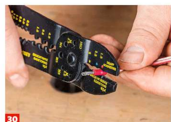
29 An den Enden der Lautsprecherkabel haben wir Kabelschuhe angequetscht, alternativ können Sie sie auch verzinnen und ...
