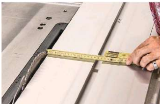
12 Messen Sie dann an der Säge, für die Sie die Sägehilfe nutzen werden, die Nutbreite, Nuthöhe und den Nutabstand zum Sägeblatt aus.
