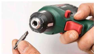
VIELSEITIG: Das Futter nimmt Bits und Bohrer auf – leider nur bis 6 mm.
