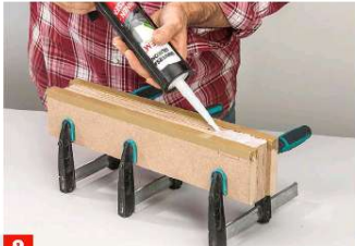
9 ... etwa 3 mm starke Feder sorgt dafür, dass die Zulagen erhöht sind. Nun füllen Sie diesen Bereich inklusive der Sägegut mit Silikon auf.
