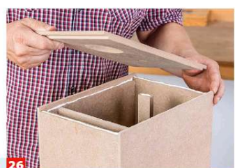
25 Jetzt wird das Gehäuse geschlossen: Erst die Rückwandverstärkung, dann die Rückwand (mit Terminal-Loch) einleimen.
