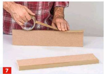
7 Nun benötigen Sie zwei Zulagen. Bekleben Sie bei beiden mit Folienklebeband die Schnittkante und etwa 10 mm einer Fläche.
