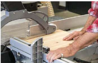
13 Aus Leimholz schneiden Sie entsprechende Führungshölzer, die möglichst spielfrei, aber ohne zu klemmen in die Nut passen.
