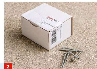
2 Dies kann mit Claytec Lehmbauschrauben 5 x 50 mm erfolgen; an Wänden neun Schrauben/Platte, an Decken 15 Schrauben/Platte.
