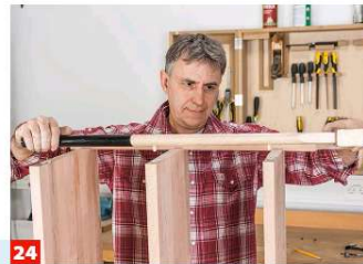
24 Jetzt verleimen Sie beide Äxte mit dem Grundregal. Die Dübel nicht vergessen!
