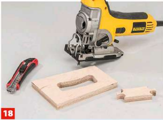
18 Den Rest schneiden Sie mit der Stichsäge aus. Um Holzaussriss zu vermeiden, von der Oberseite die Griffloch-Kontur vorritzen.
