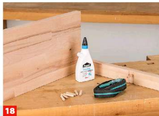
18 Nun geht's ans Verleimen. Dazu Weißleim in die Löcher und an die Nuten geben, die Dübel einsetzen und die Böden zwischen den ...
