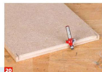
18 Der Boxenboden wird für besseren Schallaustritt vorn gerundet – jedoch nicht dort, wo er in den Falzen der Seitenwände liegt.
