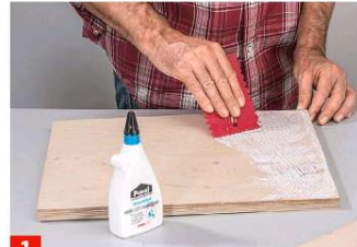
1 Die Grundplatten der Sägehilfe bestehen aus 36-mm-Multiplex. Hierfür werden zunächst zwei 18-mm-Platten mit Übermaß ...
