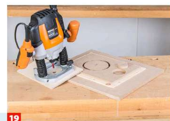
17 ... ausgestattet, die Mittelpunkte mit Nägeln gespickt und um diese die Oberfräse mit selbstgebauter Zirkelrinne geführt.
