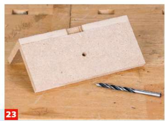
22 Verleimen Sie zunächst den Winkel des Hochtön-Gehäuses, und bohren Sie ein passgenaues Loch für das Anschlusskabel.
