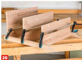
20 ... oder ausreichend lange Zwingen. Falls Leim austritt, nehmen Sie ihn mit einem Beitel ab, sobald er angezogen hat.
