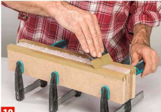
10 Sofort im Anschluss ziehen Sie den Dichtstoff mit einem (ebenfalls beklebten) Japanspachtel entlang den Zulagen glatt ab.
