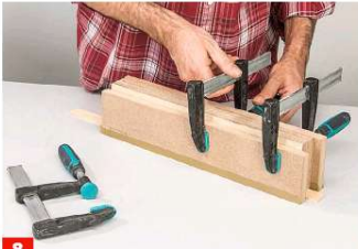
8 Diese Zulagen von beiden Seiten gegen die Sägehilfen spannen – Nutseite an Klebandseite. Eine mittig untergelegte, ...
