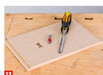
11 ... des Gehäuses: Die Seitenwandverstärkung (links) wird in beide Seiten eingelassen, die Rückwandverstärkung (oben) auf der einen ...
