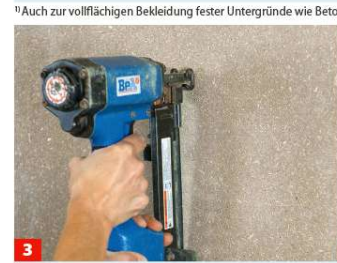
3 Oder mit Breitrückenklemmern B 25 mm. Klammerabstand > 50 < 100 mm, Randabstand > 20 mm, Eindringtiefe > 20 mm.
