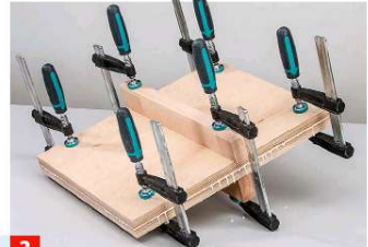
2 ... zugeschnitten, vollflächig beleimt (Leimkamm verwenden) und verpresst.
