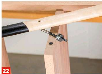
22 Bohren Sie die drei Dübellöcher zuerst in die Böden und übertragen diese gleichzeitig auf die Axtstiele. Dann auch dort bohren.
