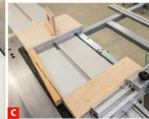
C ... schwierigen Diagonalschnitten, die ansonsten kaum möglich sind.
