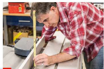
5 Zum Nuten der Kanten nutzen Sie den Parallelanschlag und stellen das Sägeblatt auf etwa 6 mm Höhe ein.
