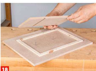
16 Für Hoch- und Tieftönerchassis müssen nun die Löcher gefräst werden. Wir haben hierzu eine Grundplatte mit Rahmenhölzern ...
