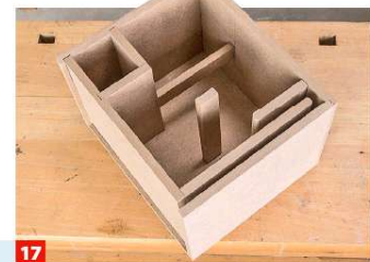
15 Hier nun die komplett zusammengesteckten Gehäusebauteile ohne rechte Seitenwand. Die Schallwand liegt in dem Bild links.
