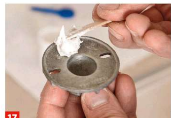
17 Tragen Sie dann die Klebstoffmasse auf den Montagesockel auf.
