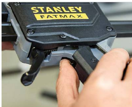
Gelenk: Bei der großen Stanley-Zwinge sind Klemmstellen am Gelenk vorhanden.
