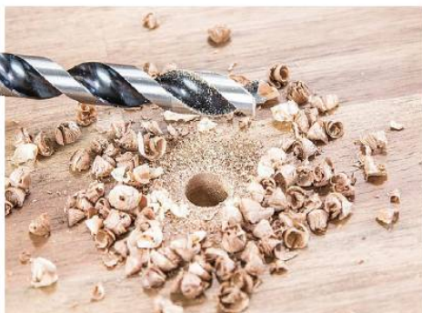
Die Bohrungen gelingen auch frei Hand praktisch ausrissfrei, es entstehen feine Späne.
