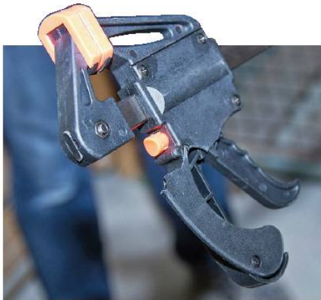
BRUCH: Beim Falltest brach der Griff der Work Plus-Zwinge teilweise.
