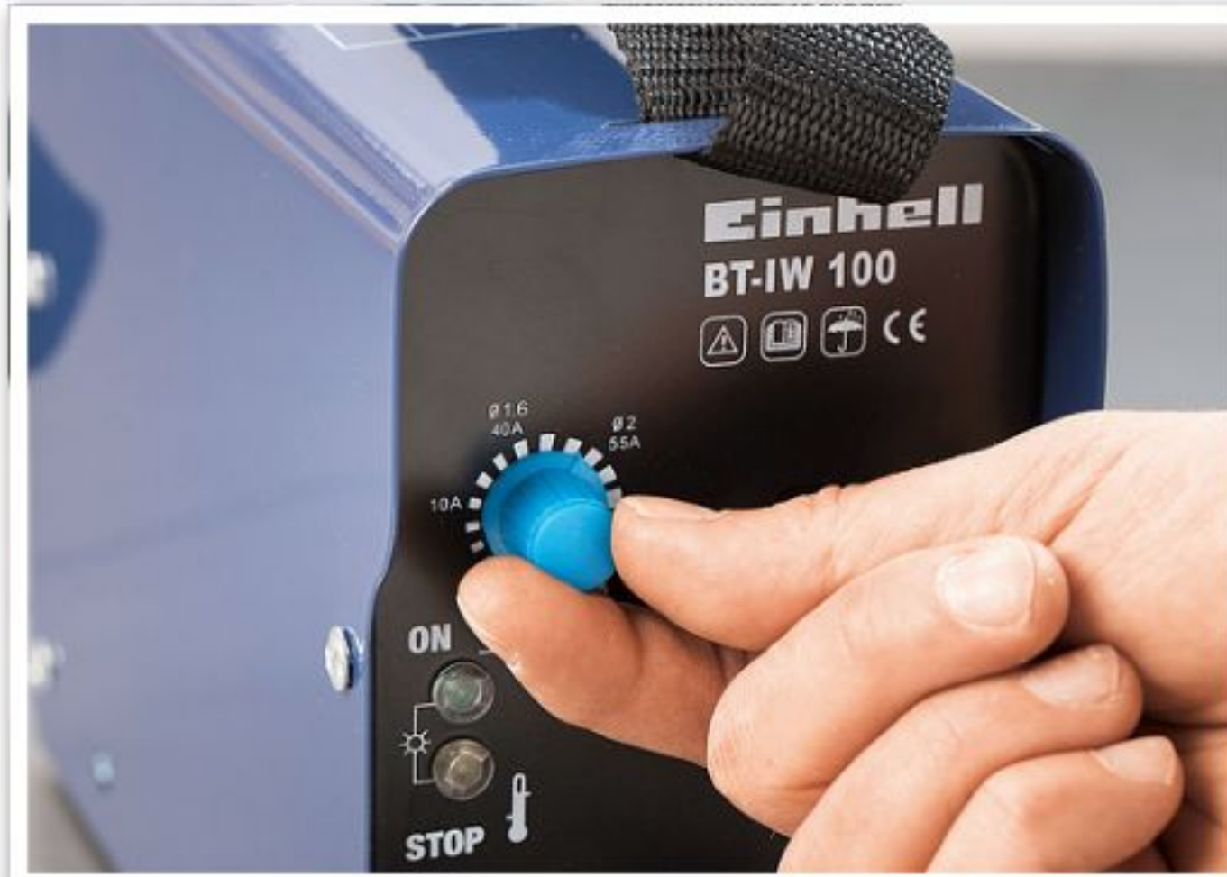
SCHWEISSGERÄT: Gute Ergebnisse sind auch für Laien mit einem Inverter möglich (hier Einhell , ab rund 200 Euro). Den Schweißstrom nach der Elektrodendicke vorwählen.
