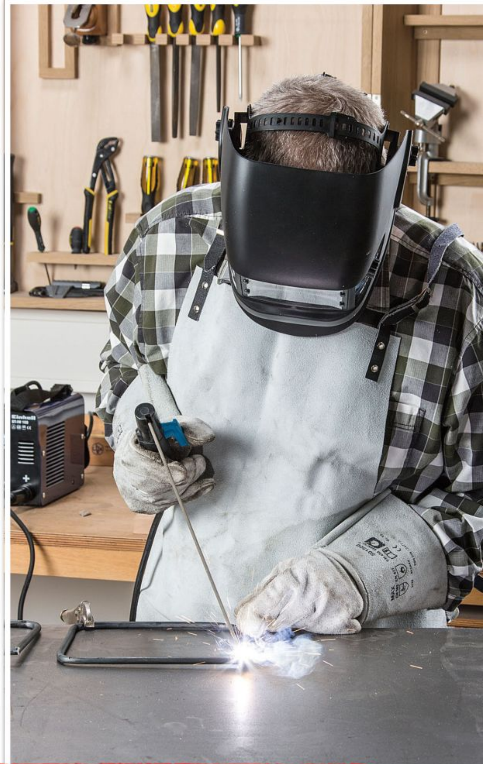
SCHWEISSGERÄT: Gute Ergebnisse sind auch für Laien mit einem Inverter möglich (hier Einhell , ab rund 200 Euro). Den Schweißstrom nach der Elektrodendicke vorwählen.
