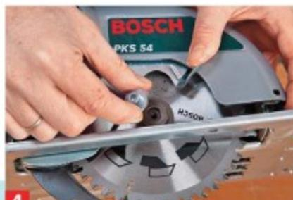
**4** Scheibe aufsetzen und Schraube festziehen, dabei die Antriebswelle gegen Verdrehen festsetzen. Sitz des Spaltkeils kontrollieren.
