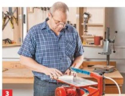
**3** Einfacher geht das mit einer Dekupiersäge, z. B. von Hegner. Dann schleifen und entgraten Sie die Bauteile.
