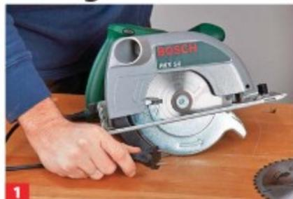
**1** Bei allen Einstell- und Wartungsarbeiten den Netzstecker ziehen! Nur so sind Sie vor unbeabsichtigtem Anlaufen sicher.
