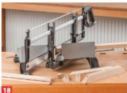
**18** ... Hölzer schneiden, dann nuten. Mit der Präzisions-Gehrungssäge längen Sie die Hölzer auf Gehrung ab.
