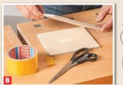
**B** Bei Nutzung einer Dekupiersäge ist es sinnvoll, beide Außenplatten mit doppel-seitigem Klebeband aufeinander ...
