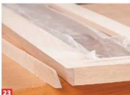
**23** Mit der geeigneten Handkreissäge schneiden Sie das obere Rahmenholz entlang der Führungsschiene schräg zu.
