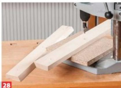
**28** Um die Vitrine aufzuhängen, schneiden Sie zwei Aufhängeleisten mit 30°-Gehrungsschnitt. Bohren und senken.
