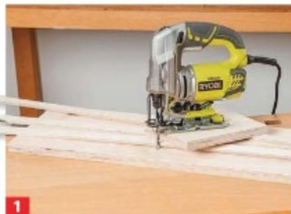
1 Schneiden Sie die Bauteile für die Rampe aus dickerem Multiplex (z. B. 12 bis 18 mm) zu, nur die Seiten bestehen aus 6,5er Material.
