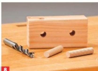
**8** Die beiden Halteklötze mit je zwei Löchern im Durchmesser der Dübel versehen.
