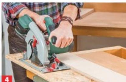
**4** Nun können Sie die Säge entlang des Anlagebretts führen und erhalten einen exakt geraden Schnittverlauf.
