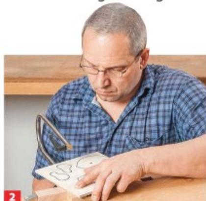
**2** Nun sägen Sie die Bauteile mit der Laubsäge sorgfältig aus.
