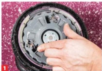
1 Der Perforieraufsatz zum leichteren Ablösen von Tapeten lässt sich auf die Tapetendicke einstellen.
