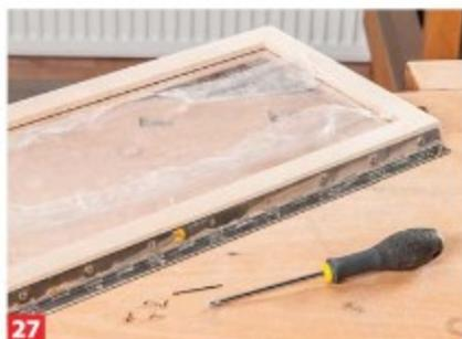
**27** Längen Sie das Edelstahl-Stangenscharnier ab und montieren es zunächst am Deckel, dann an der Vitrine. Vorböhrern!
