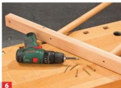
**6** Die Rundstäbe in die Sacklöcher einsetzen, von beiden Außenseiten verschrauben.
