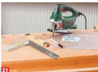
**21** Vor dem Verleimen auch die Füllung zuschneiden. Lassen Sie die Schutzfolien hierzu auf dem Kunstglas. Zum Verleimen ziehen ...
