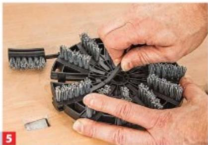
5 Bei der Kunststoffschleifbürste lassen sich die Bürsten einzeln herausnehmen und wechseln.
