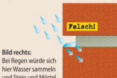
**Bild rechts:** Bei Regen würde sich hier Wasser sammeln und Stein und Mörtel belasten. Auf Dauer halten die Baustoffe solchen Feuchtebelastungen nicht stand.
