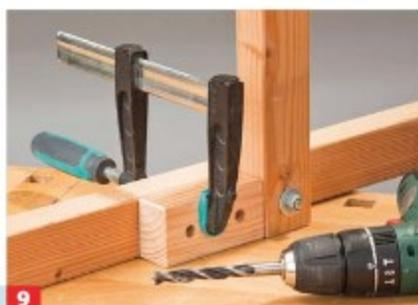
**9** Den Klotz am Fuß festzwingen, durch die Löcher in das Fußteil bohren, aber nicht durchbohren! Auf der anderen Seite gegengleich.
