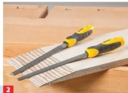
2 Die Rampenfläche wird unten auf etwa 7 Grad mit Raspel, Feile und Exzenter schleifer abgeschragt.
