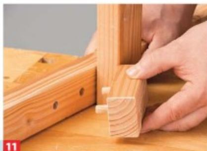
**11** Die Klötze können einfach eingesteckt und ebenso entfernt werden. So verhindern sie später, dass die Seitenteile umklappen.
