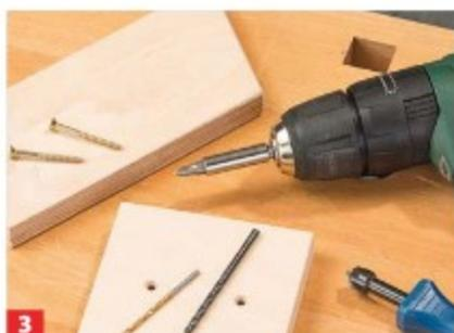
**3** Schraubenpositon im Fuß markieren, bohren und senken. Seite aufsetzen und von unten verschrauben.
