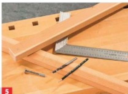
**5** Den Bereich der Überlappung von Seiten- und Fußteil markieren, die Position der Schlossschraube anzeichnen und bohren.
