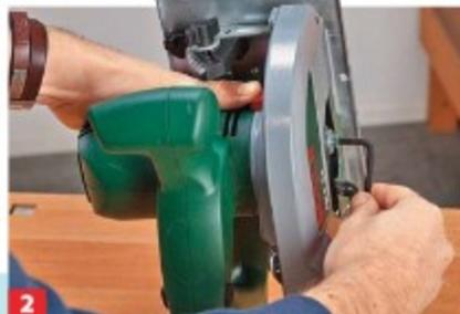
**2** Zum Lösen der zentralen Blattbefestigung müssen Sie die Motorwelle fixieren – meist ist das per Drucktaste möglich.
