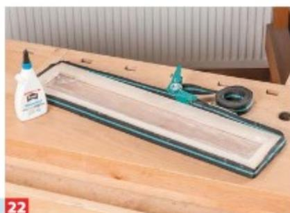
**22** ... Sie sie nur an den Rändern leicht ab und stecken das Hobbyglas in die Nut. Leim angeben und mit dem Spanngurt verpressen.
