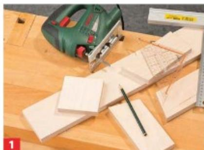
**1** Markieren Sie Fuß- und Seitenteile auf dem Material, dann mit der Stichsäge zuschneiden. Die obere Schräge nach Belieben ...
