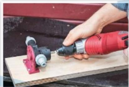
Am Antriebsdorn wird eine elektrische Bohrmaschine angekoppelt – die Verbindung erfolgt einfach über das Bohrfutter.
