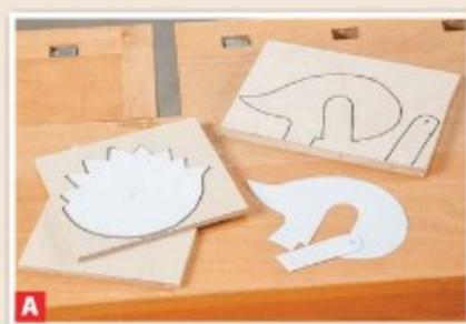
**A** Auch beim Bau des Igels beginnen Sie damit, dass Sie die Konturen auf die Sperrholz-Platten zeichnen.
