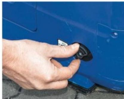
**BENZINHAHN:** Benzinhahn (Foto) und Tankentlüftung werden beim Transport geschlossen.
