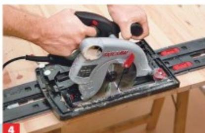
**4** Die Schiene funktioniert tadellos. Am besten ist es, wenn das System auf die Säge abgestimmt ist – bei *Bosch* und *Skil* gibt es Sets.
