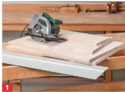
**1** Schneiden Sie zunächst die Bauteile zu oder lassen Sie diese bereits im Baumarkt zuschneiden.
