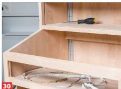
**30** Schneiden Sie die Deltaprofile zu (4 Teile; siehe Produktinfo), bohren und senken sie und montieren sie in der hinteren Ecke.
