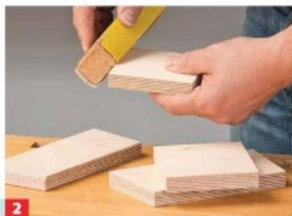
**2** ... bis ca. 20 Grad wählen, alternativ eine fertige Seite als Schablone nutzen. Dann die Kanten mit etwas Schleifpapier glätten.
