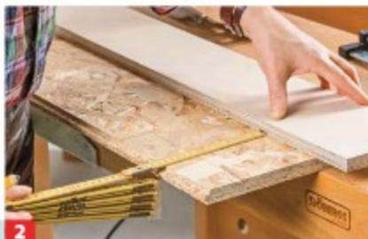
**2** Das Anlagebrett muss nun in diesem Abstand zum Anriss aufgespannt werden. Achten Sie darauf, dass der Motorkörper von der ...
