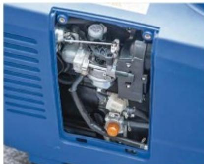
**TECHNIK:** Das Gerät verfügt über einen Benzinprimer und eine automatische Drehzahlabsenkung.
