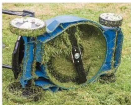
**BLOCKIERT:** Bei Scheppach kann Schnittgut das Mähdeck zusetzen.
