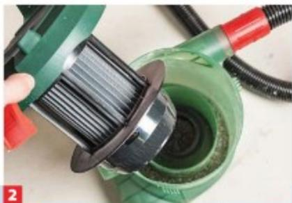
2 Der Staubbehälter ist mit einem hochwertigen Membranfilter samt manueller Filterreinigung ...
