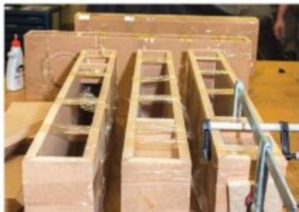
Die vorbereiteten Holzteile aus MDF müssen sorgfältig zu Gehäusen verleimt werden.
