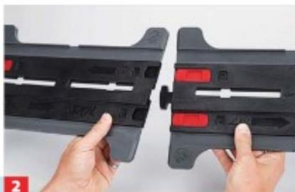
**2** Die Schienenteile werden einfach mit Puzzlenasen zusammengesetzt. In diesem Fall gibt es sogar Verriegelungen (rot).
