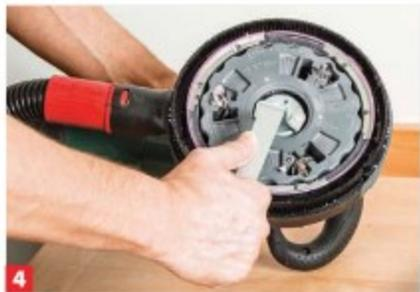
4 Wie beim Winkelschleifer erfolgt der Wechsel der Werkzeuge mit Spindelarretierung und Schlüssel.
