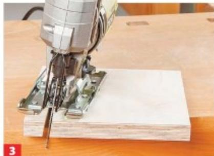
Bei der senkrechten Rampenstütze oben ebenfalls einen 7-Grad-Schnitt anlegen – die Höhe hängt von der Rampenlänge ab.
