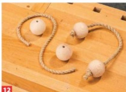
**12** Die Bolas werden aus Holzkugeln und Seil gefertigt. Wählen Sie vorgebohrte Kugeln und vergrößern Sie das Loch.
