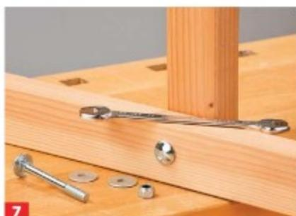
**7** Fuß- und Seitenteil mit der Schlossschraube verbinden. Der Kopf sitzt außen, von innen mit Unterlegscheibe und Mutter festziehen.
