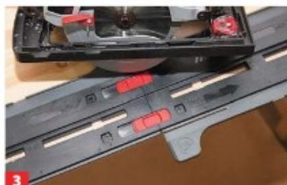
**3** Beim ersten Schnitt werden bei dieser Ausführung die zunächst überhängenden Seitenzungen entfernt.
