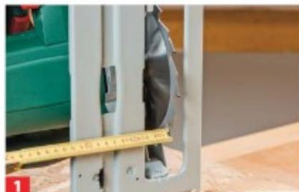
**1** Messen Sie zunächst den Abstand des Sägeblatts zum Außenrand der Maschinen-Grundplatte auf der Motorseite.
