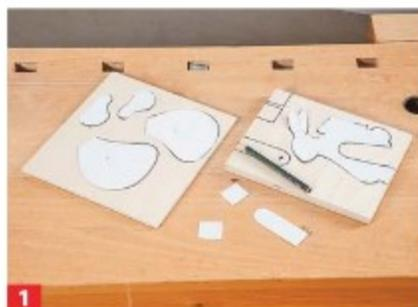
**1** Zeichnen Sie die Umriss der Hasen-Bauteile auf 12- (innen) bzw. 6,5-mm-Multiplex (außen).
