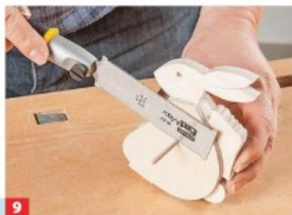
**9** ... stecken die 4-mm-Dübelstange durch und längen sie bündig ab. Das Hinterbein muss nun völlig frei pendeln können.
