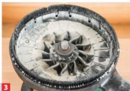
3 ... ausgestattet. Den Staub-Abtransport übernimmt jedoch die Turbine im Handgerät.
