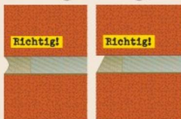
Die Mauerfugen müssen so geformt sein, dass Regenwasser schnell abläuft und sich nicht in den Fugenflanken staut, sonst bröckelt der Mörtel mit der Zeit wieder heraus. Die richtige Ausformung der Fugen erzielen Sie mit dem Fugeisen oder einem Stück Schlauch.
