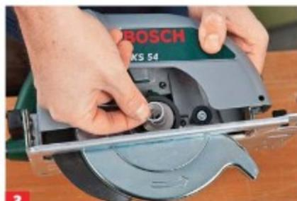
**3** Entfernen Sie nur so viele Bauteile wie nötig. Bei Sägeblättern mit größerer Bohrung einen passenden Reduzierring nutzen.
