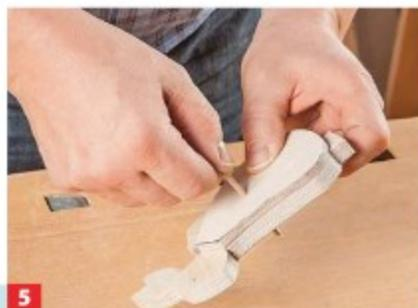
**5** Zum Verleimen der drei Flächen stecken Sie leimlos ein Stück Dübelstange durch die beiden Außenflächen, um diese ...
