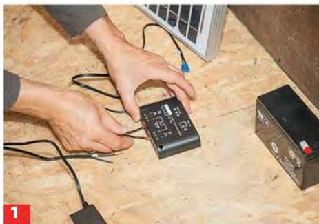
**1** Die Komponenten sind fertig vorverdrahtet und müssen nur zusammengesteckt werden. Verbraucher bis 50 Watt sind nutzbar.
