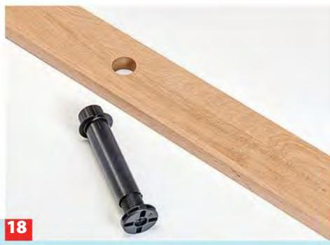
**18** Was nun noch fehlt, ist der Zwischenholm als Mittelaugler für die Lattenroste. Dort mittig ein Loch für den Stützfuß hineinbohren.
