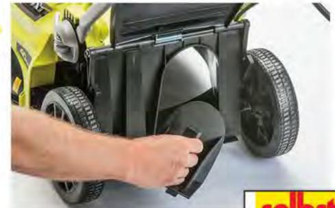
**MULCHER:** Der mitgelieferte Keil verschließt den Fangkanal.
