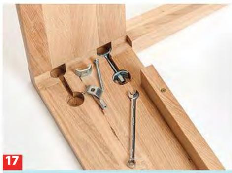
**17** Zum Schluss werden die Fußteil-Verbindern eingesteckt und angezogen; der Bettrahmen ist damit komplett aufgebaut.
