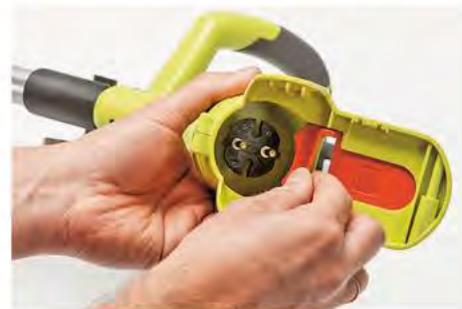
Der kräftige Trimmer arbeitet mit einer Fadenspule. Der Faden wird automatisch beim Einschalten verlängert.
