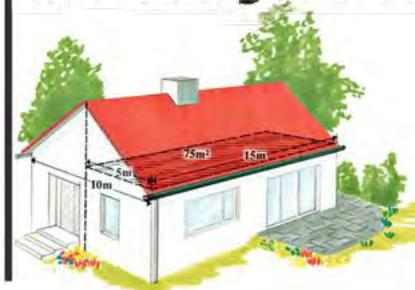
**Hier eine Beispielrechnung:** Das Dach links hat eine Länge von 15 m und eine Breite von 10 m. Die Grundrissfläche des Hauses beträgt somit 150 m<sup>2</sup>. Erhält jede Hausseite einen Fallrohranschluss, so ist die zu entwässernde Grundfläche 75 m<sup>2</sup> groß. Werden zwei Abläufe je Hausseite angeschlossen, so halbiert sich die zu entwässernde Grundfläche auf 37,5 m<sup>2</sup>.
