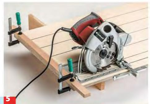
**5** ... Front eine Hilfsleiste (zugleich Rückschlagsicherung) anzwingen, Türverlauf anzeichnen und die Seiten mit der Kreissäge schneiden.
