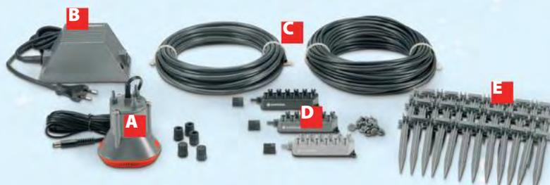
**TOPFPFLANZEN-BEWÄSSERUNG:** Das Wasser wird per Pumpe **A** aus einem Behälter gefördert. Der Trafo **B** sorgt für täglich eine Minute Bewässerung. Über Schläuche **C** und Verteiler **D** können mehr als 30 Pflanzen versorgt werden. Erdspieße **E** fixieren die Tropfschläuche in den Töpfen.
