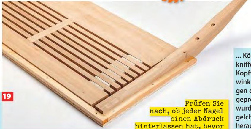
**19** Prüfen Sie nach, ob jeder Nagel einen Abdruck hinterlassen hat, bevor Sie die Nägel wieder entfernen.
