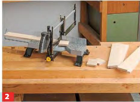
**2** Anschließend werden die beiden äußeren und die mittleren Lagen der aufzudoppelnden Beine mit der Gehrungssäge gekürzt.
