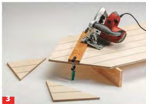
**3** Sind alle Seitenteile soweit vorbereitet, zeichnen Sie an der Front die Schrägen für das Dach an und schneiden die Ecken ab.
