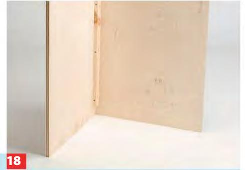
**18** Die beiden Dachhälften werden mit einer Leiste miteinander verschraubt.
