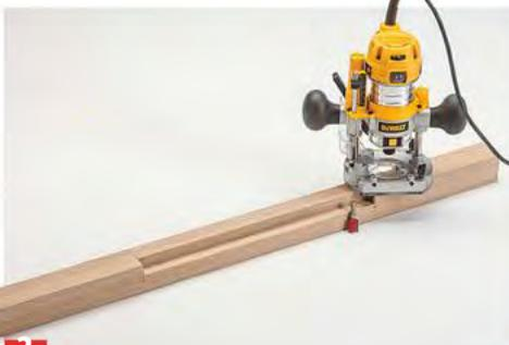
**2** Da die Fußteil-Innenecke im Fuß liegt, wird dieser Bereich (für beide Füße) gefalzt.
