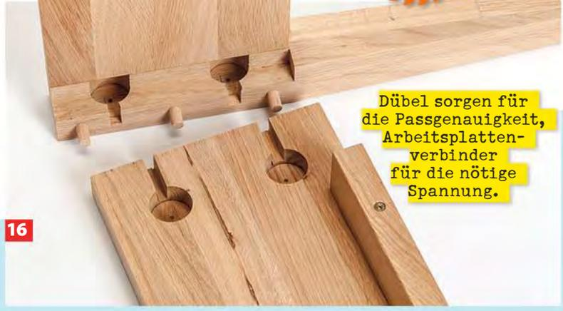
**16** Dübel sorgen für die Passgenauigkeit, Arbeitsplattenverbindern für die nötige Spannung.
