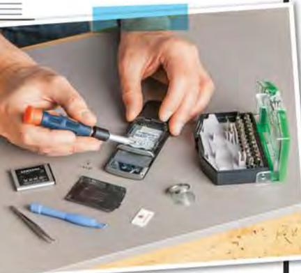
**PRÄZISE** können die Bits mit dem verriegelbaren Griff geführt werden.
