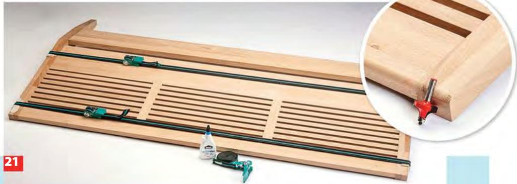
**21** Leim angeben, Dübel einstecken und verpressen. Austretenden Leim entfernen und nach dem Abbinden die vordere, obere Kante des kompletten Kopfteils abrunden.
