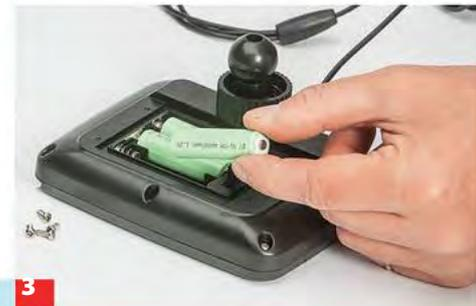
**3** Als Pufferakkus werden übliche NiMH-Akkus verwendet – die Erstausrüstung wird mitgeliefert (ELV, Set knapp 30 Euro).
