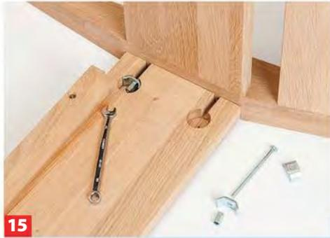
**15** Beim Kopfteil wird die Schraube des Arbeitsplattenverbinders gegen eine durchgesteckte Schlossschraube getauscht.
