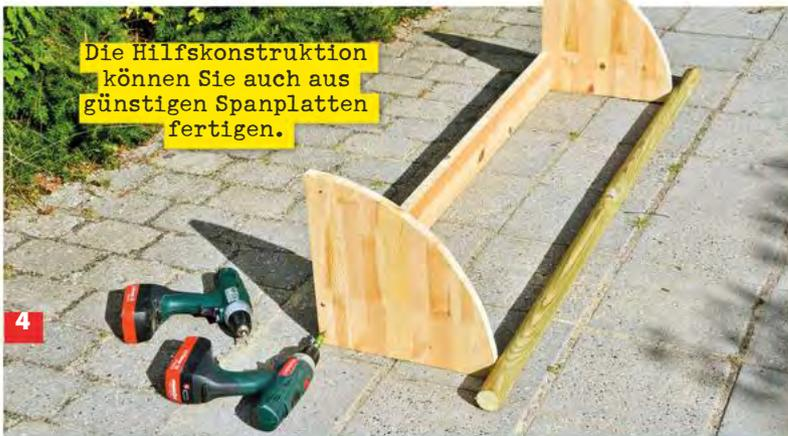
Die Hilfskonstruktion können Sie auch aus günstigen Spanplatten fertigen.
