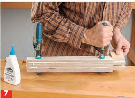
**7** Nun mit Schraubzwingen verpressen. Tipp: Entfernen Sie den austretenden Leim sofort im Bereich der Überblattungen.
