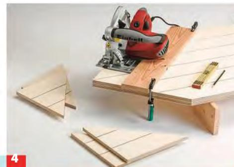
**4** Nutzen Sie das fertige Frontteil als Schablone für die Rückseite und schneiden Sie diese ebenso zu. Für den Türausschnitt in der ...
