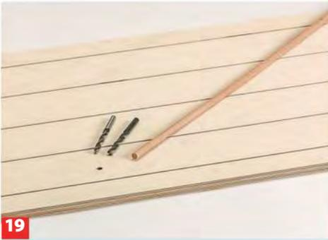
**19** Auf der Tür die Position des Griffs markieren, Loch bohren. Die Konstruktion besteht aus einem Stück Rundholz mit einem ...
