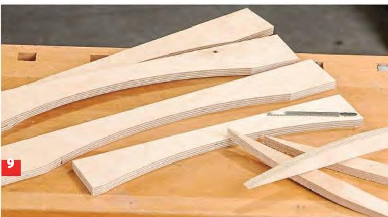
**9** Auch hier mit dem Cuttermesser vorritzen (reduziert den Holzaustriss) und mit der Stichsäge zuschneiden.
