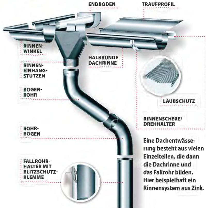
Eine Dachentwässerung besteht aus vielen Einzelteilen, die dann die Dachrinne und das Fallrohr bilden. Hier beispielhaft ein Rinnensystem aus Zink.
