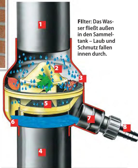
**Filter:** Das Wasser fließt außen in den Sammel-tank – Laub und Schmutz fallen innen durch.
