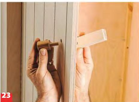
**23** Den Griff anbringen: Dazu den Dübel zuerst mit dem Rundholz verleimen, dann durch das Loch mit dem Riegel verbinden.
