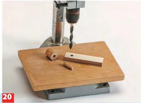
**20** ... Sackloch, in das ein Dübel gesteckt wird. Dieser wird später auf der anderen Seite mit dem Riegel aus Multiplex verbunden.
