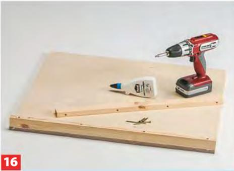
**16** Der Boden wird wie ein kleines Podest gefertigt. Dazu von der Unterseite vier Leisten anbringen.
