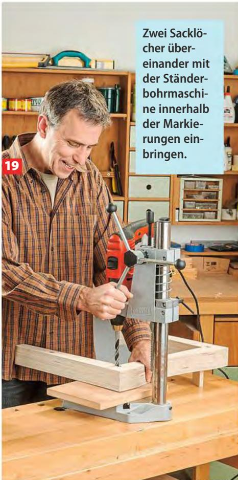
Zwei Sacklöcher übereinander mit der Ständerbohrmaschine innerhalb der Markierungen einbringen.
