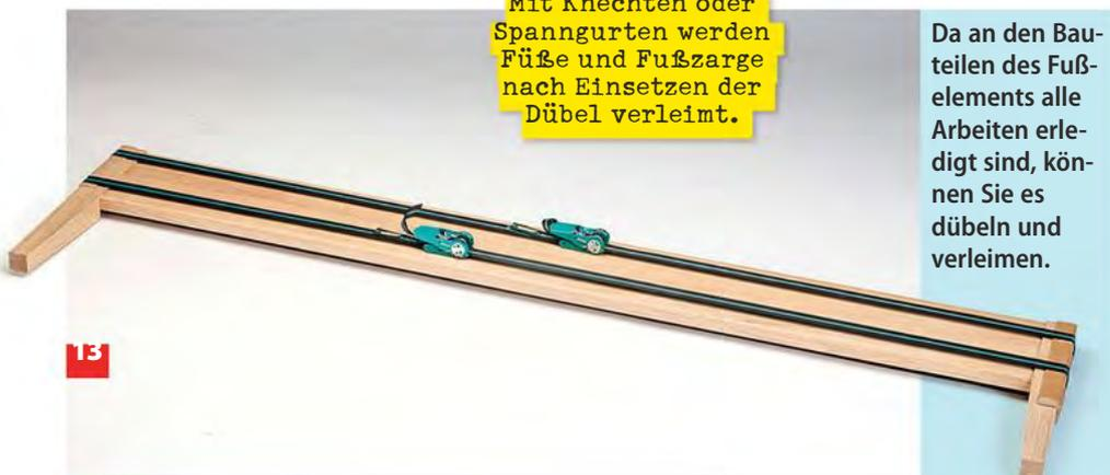
Mit Knechten oder Spanngurten werden Füße und Fußzarge nach Einsetzen der Dübel verleimt.
