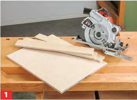
**1** Den Zuschnitt der Holzstreifen für Sitzfläche und Beine erledigen Sie mit der Handkreissäge und dem Parallelanschlag.
