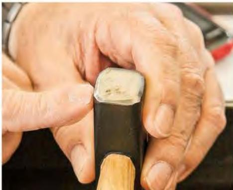
**UNSAUBER:** An einigen Hämmern (hier Toolcraft) sind Schleiffehler sichtbar.
