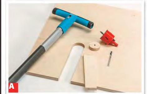
**A** Mit der Lochsäge ein Loch schneiden, dieses nach vorne mit der Stichsäge öffnen.
