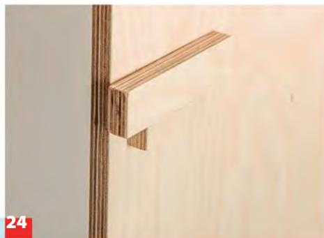
**24** Damit der Riegel bei offener Tür nicht frei herumschwingt, wird von unten ein kleines Stück Multiplex als Auflager verleimt.
