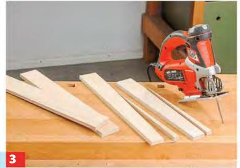
**3** Schließlich zeichnen Sie den innen leicht schrägen Verlauf auf alle Hockerbein-Teile, ritzen sie mit dem Cuttermesser an und ...
