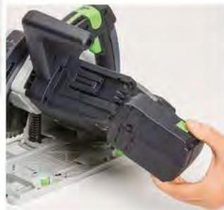
**SPEICHER:** Die Säge arbeitet mit zwei 18-Volt-Akkus des Herstellers.
