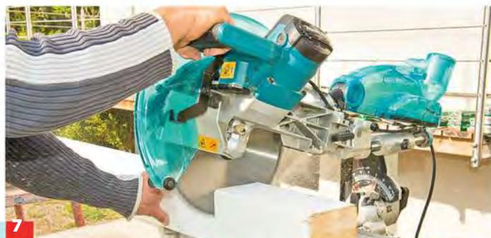
**7** Mit der Kappsäge die Stützpfeiler zerschneiden. Dann jeden Pfosten auf einer geraden Unterlage festzwingen.
