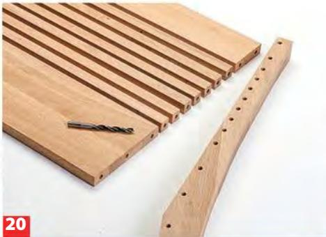
**20** Nun auf beiden Seiten die Dübellöcher an den Nagelmarkierungen bohren.
