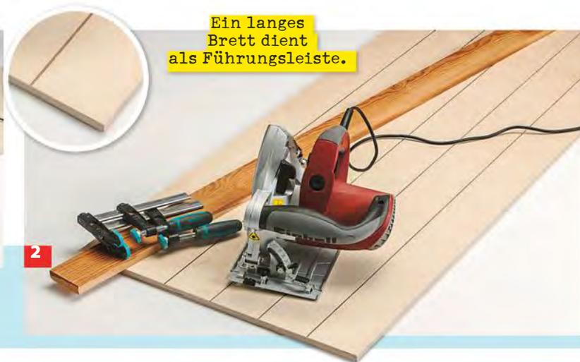
Um den Effekt einer Bretterverkleidung zu erzielen, wird mit der Kreissäge in regelmäßigen Abständen eine Nut eingeschnitten.
