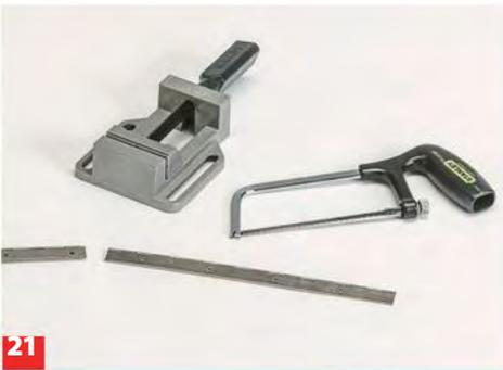
**21** Das Klavierband für die Anbringung der Tür mit der Eisensäge ablängen, dazu im Schraubstock festklemmen.
