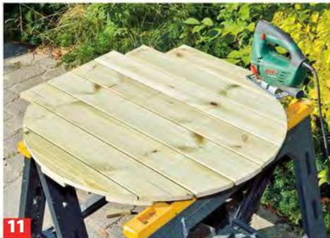
**11** Von oben einen Kreis anzeichnen und diesen mit der Stichsäge ausschneiden. Oberfläche und Kanten glatt schleifen.
